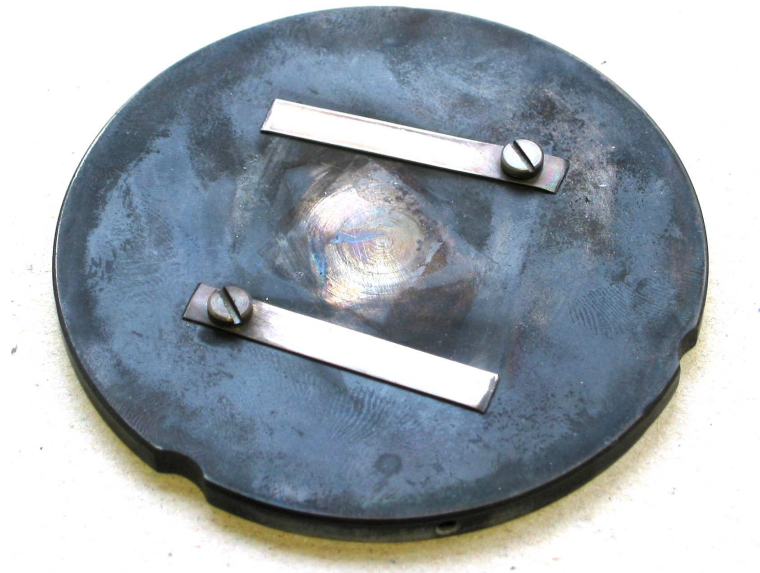
Fig. 2.10: Le porte-substrat avec les languettes en acier inoxydable.
