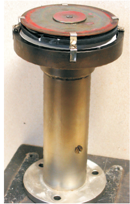
Fig. 2.9: La tour porte-substrat. La photographie montre la tour sans la partie porte-substrat.
