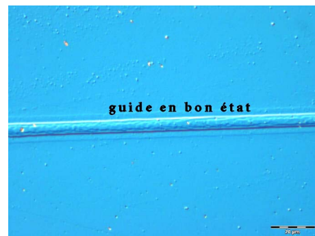
FIG. 3.18 – Photographie d'un seul guide d'onde en bon état
