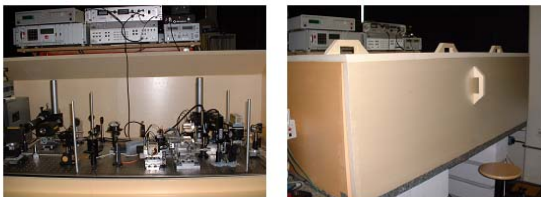
FIG. 3.10 – Double enceinte pour stabiliser la température
