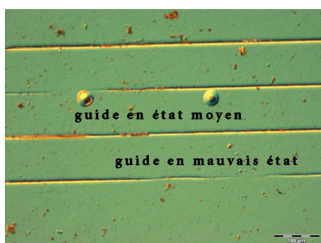
FIG. 3.17 – Photographie de quelques guides d'ondes en mauvais état et en état moyen
