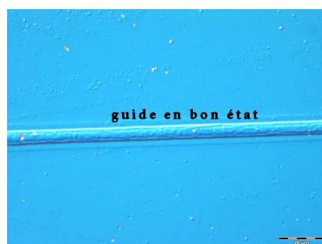
FIG. 3.18 – Photographie d'un seul guide d'onde en bon état
