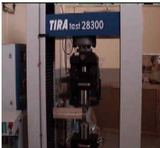
Figure 2.12: Montage d'essai sur éprouvette DCB en traction.
