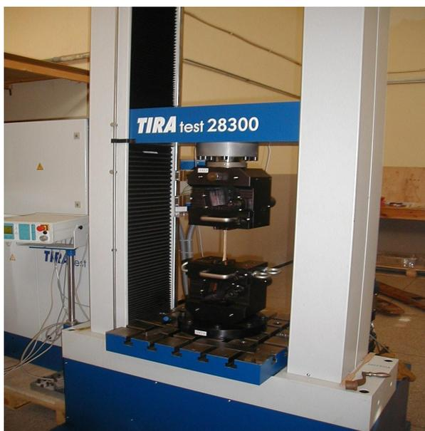
Figure 2.10: Montage d'essai sur éprouvette en traction.
