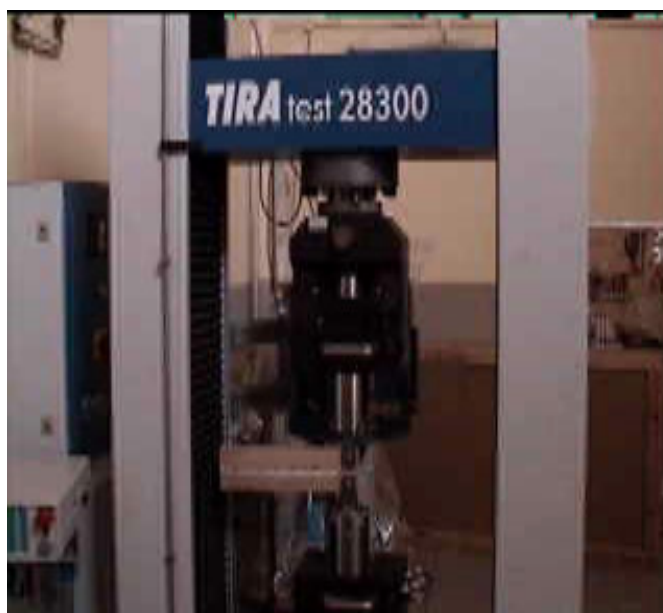
Figure 2.12: Montage d'essai sur éprouvette DCB en traction.
