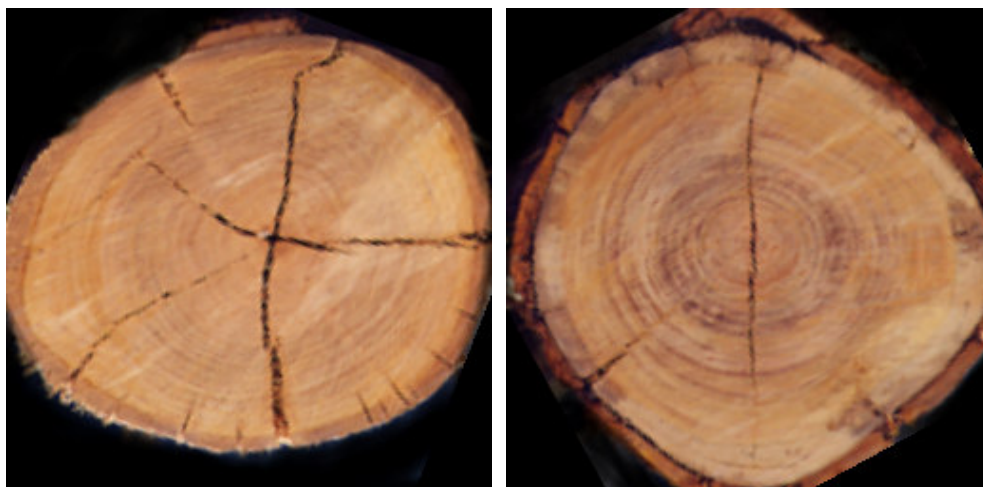
Figure 1.9: Fissure à une et plusieurs branches des bois feuillus.
