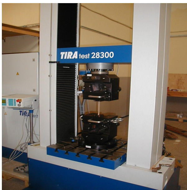
Figure 2.10: Montage d'essai sur éprouvette en traction.
