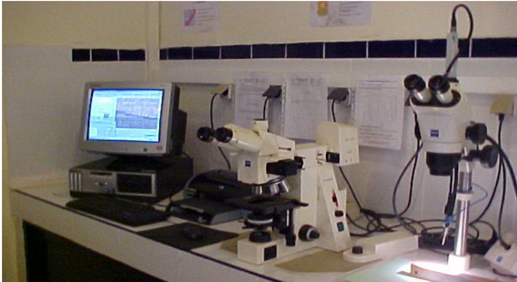
Figure 3.42: Observation du faciès de rupture à l'aide d'un stéréomicroscope.
