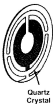
Figure IV.38 : Représentation du disque de cristal de quartz.
