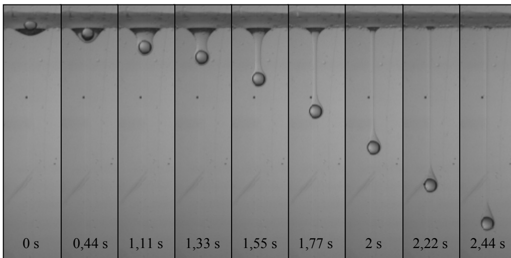
Figure AN.IV.11. Traversée de l'interface par une sphère rigide en verre ( d = 4 mm) dans le système 50% Emkarox–silicone 1000, ( \kappa = 0,25 et \gamma = 1,078 ).
