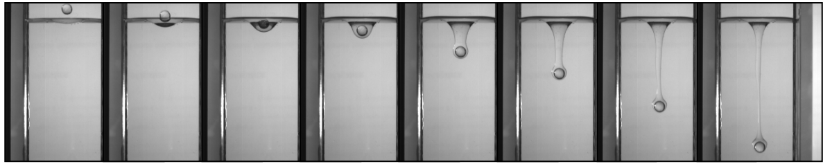
Figure IV.26. Exemple de traversée de l'interface par une sphère rigide en verre ( d = 8 mm) dans le système 25 % Emkarox–silicone 500 ( \Delta t = 120 ms, \kappa = 0,05 et \gamma = 1,061 ).
