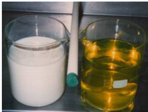
Figure 27 : Concentrés de PPCN (à gauche) et de protéines solubles (à droite) séparés par une membrane de filtration en céramique
