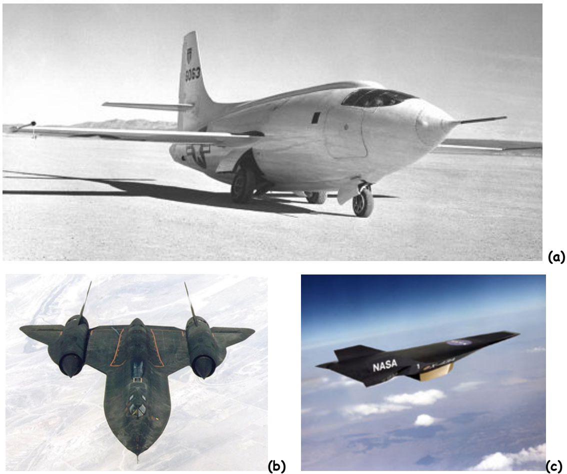
Figure 1 : (a) Le Bell X-1, premier avion à franchir le mur du son. (b) Le SR-71 Blackbird pouvait voler à Mach 3 pendant quelques heures. (c) Véhicule expérimental équipé d'un statoréacteur développé par la NASA.
