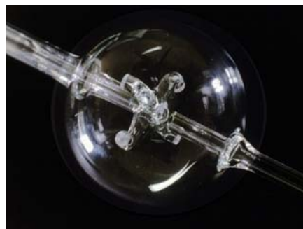
Figure 2-4 : Réacteur auto agité par jets gazeux.
