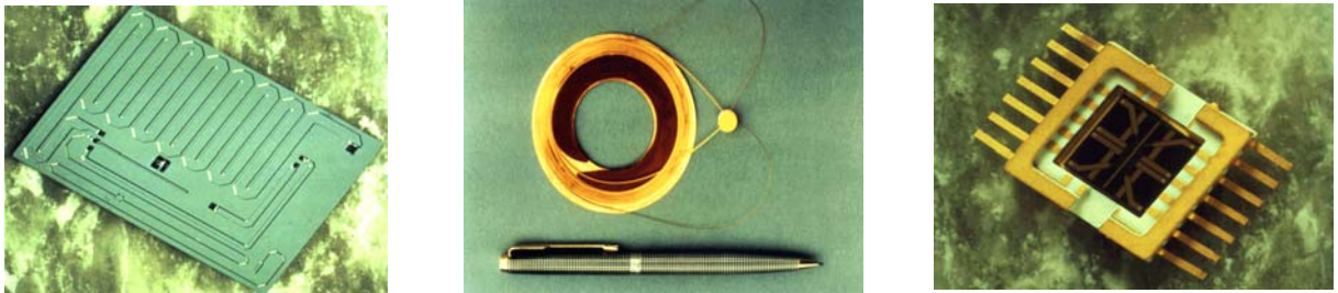
Figure II-6. Photographies des éléments principaux du micro-chromatographe Agilent 3000. Dans l'ordre; injecteur – colonne – TCD.
