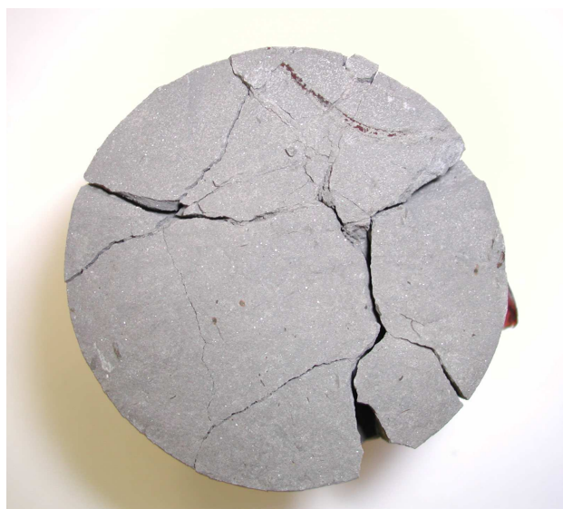
Figure 28 : Fractures développées dans le plan de la tomographie en fin d'essai.
