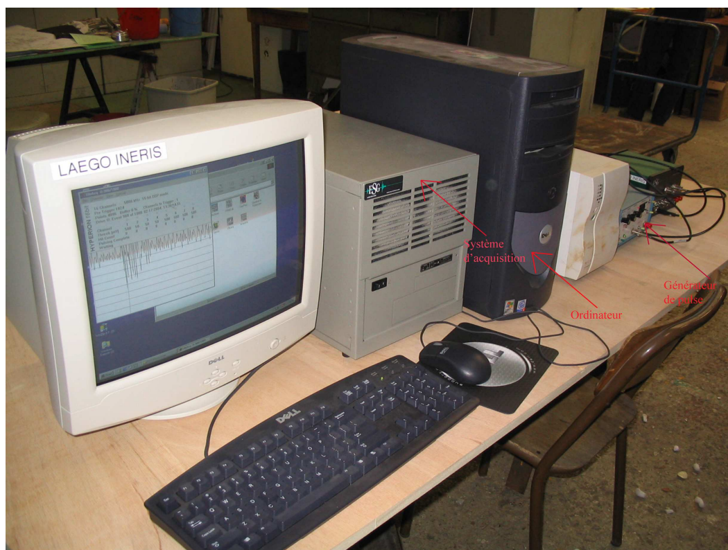
Figure 21 : Photographie du système d'acquisition ultrasonique.
