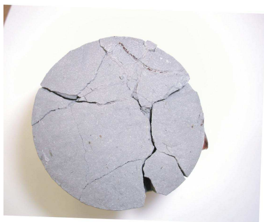
a) Fissures développées lors de l'expérimentation
