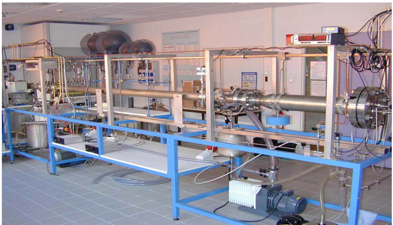
Figure III-5 : Photographie du tube à onde de choc et de son environnement proche.
