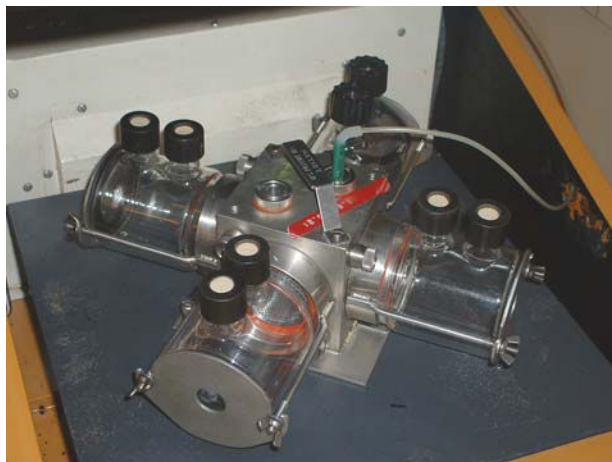
Figure 27 : Module de fractionnement à quatre compartiments placé dans une chambre à température contrôlée.
