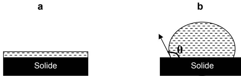
**Figure 31 : Etalement complet d'une goutte de liquide sur une surface solide (a) et étalement partiel montrant l'angle de contact (b).**
