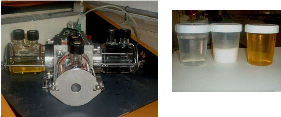
**Figure 40 : Séparation de l'émulsion à travers une membrane hydrophile en cellulose régénérée et en fluorure de polivinylidène au bout de 24 heures.**
