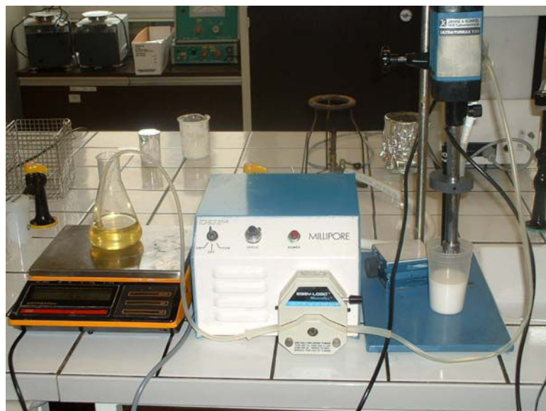
Figure 26 : Montage expérimental pour la préparation des émulsions.
