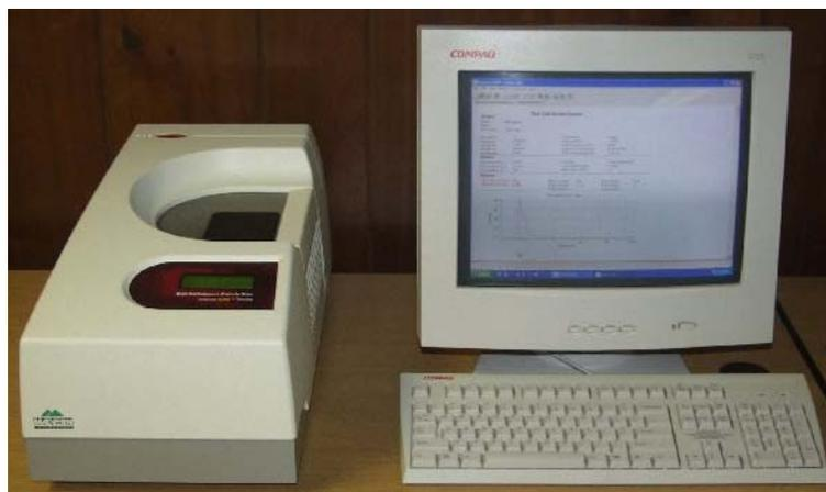
Figure 54 : Granulomètre à rétrodiffusion hautes performances (HPPS).
