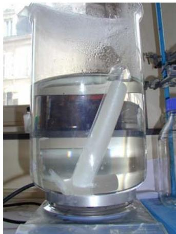
Figure 34 : Protocole de mise en forme des cylindres d'alginate de calcium.
