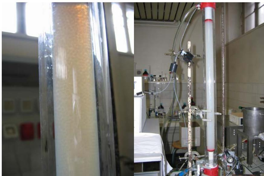
Figure 122 : Exemple de colonne remplie de billes d'alginate de calcium.
