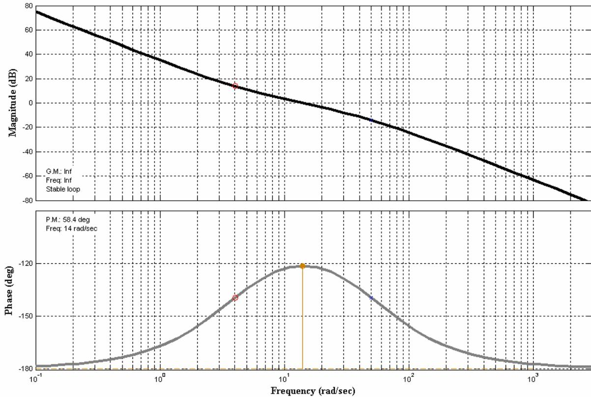
**Figure 4.14 :** Diagramme de Bode du système en boucle ouverte.
