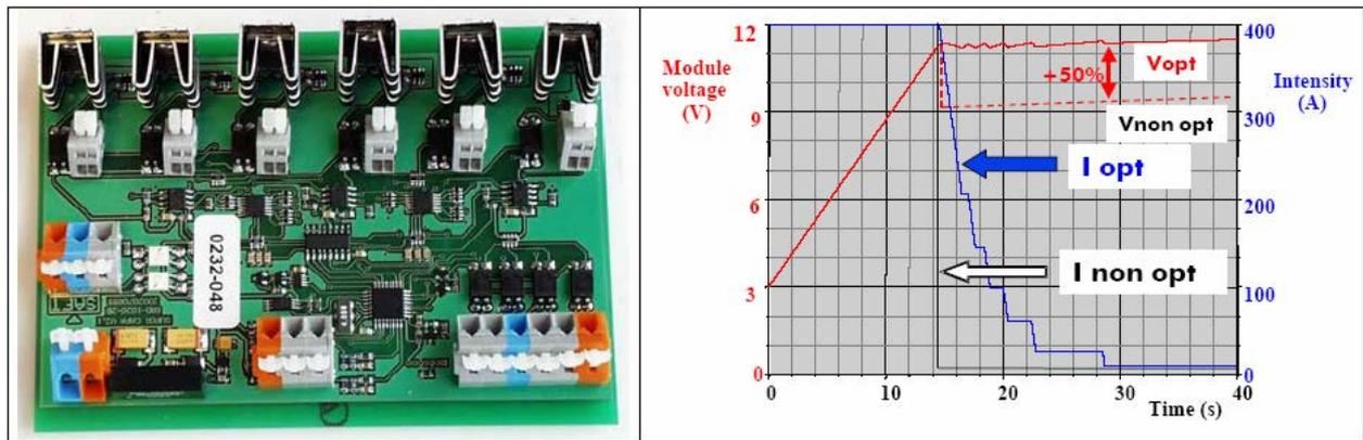
Figure 2.38 : Circuit d'équilibrage Saft et protocoles de fin de charge [Des03].
