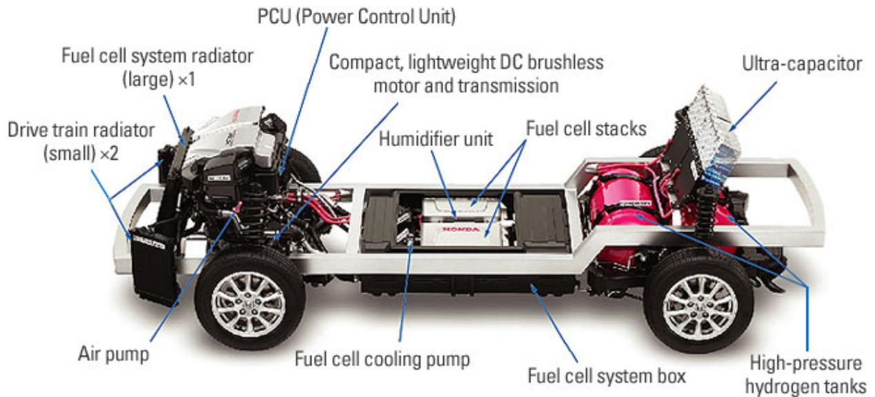
Figure 2.29 : Structure du véhicule électrique Honda FCX [Hon02a].
