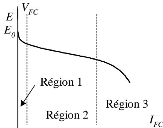
Figure 1.16 : Caractéristique statique de pile PEM.
