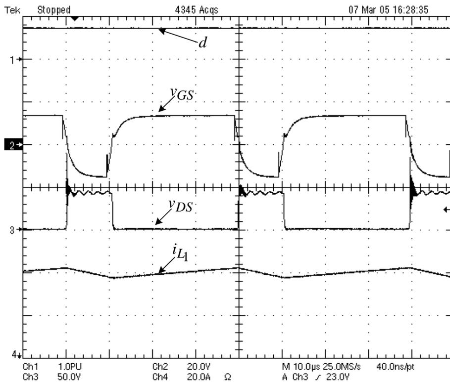
**Figure 3.20 :** Formes d'ondes associées au convertisseur de pile en régime stationnaire.
