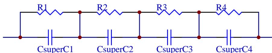
Figure 2.33 : Circuit d'équilibrage passif [Mah04].
