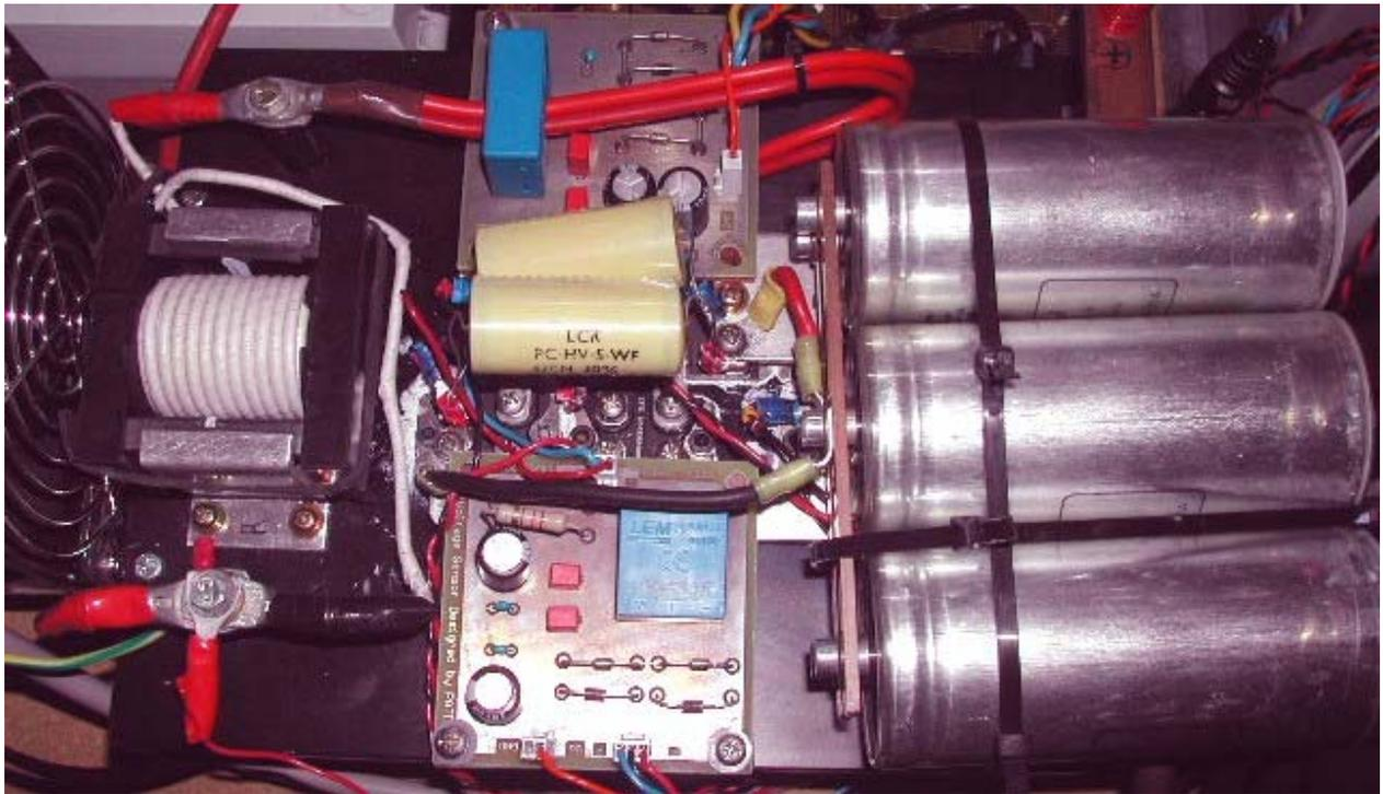
Figure 3.16 : Réalisation pratique du convertisseur de pile.
