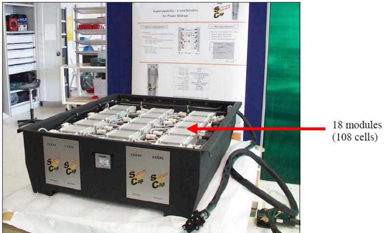
**Figure 2.37 :** Module supercapacitif Saft 34 F - 270 V [Des03].
