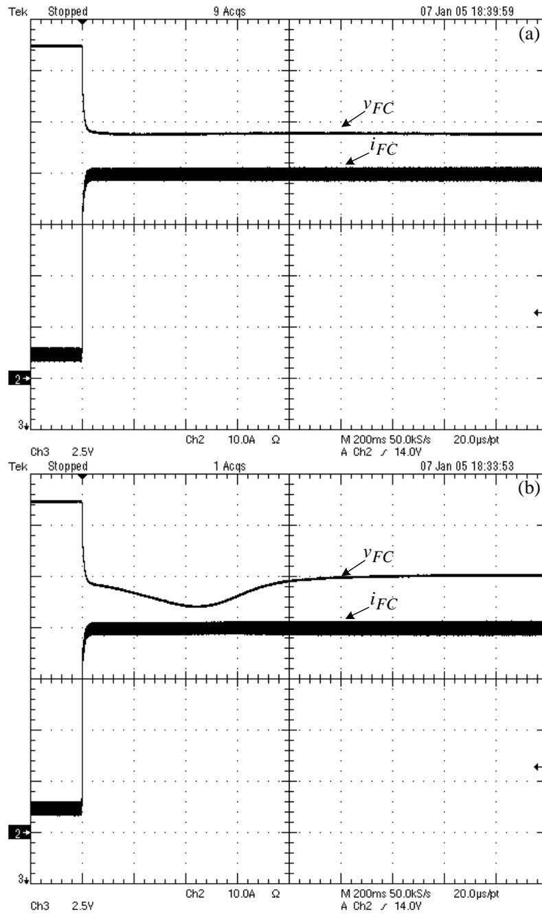
**Figure 3.26 :** Réponses en tension de la pile à un échelon de courant 5 A / 40 A.
