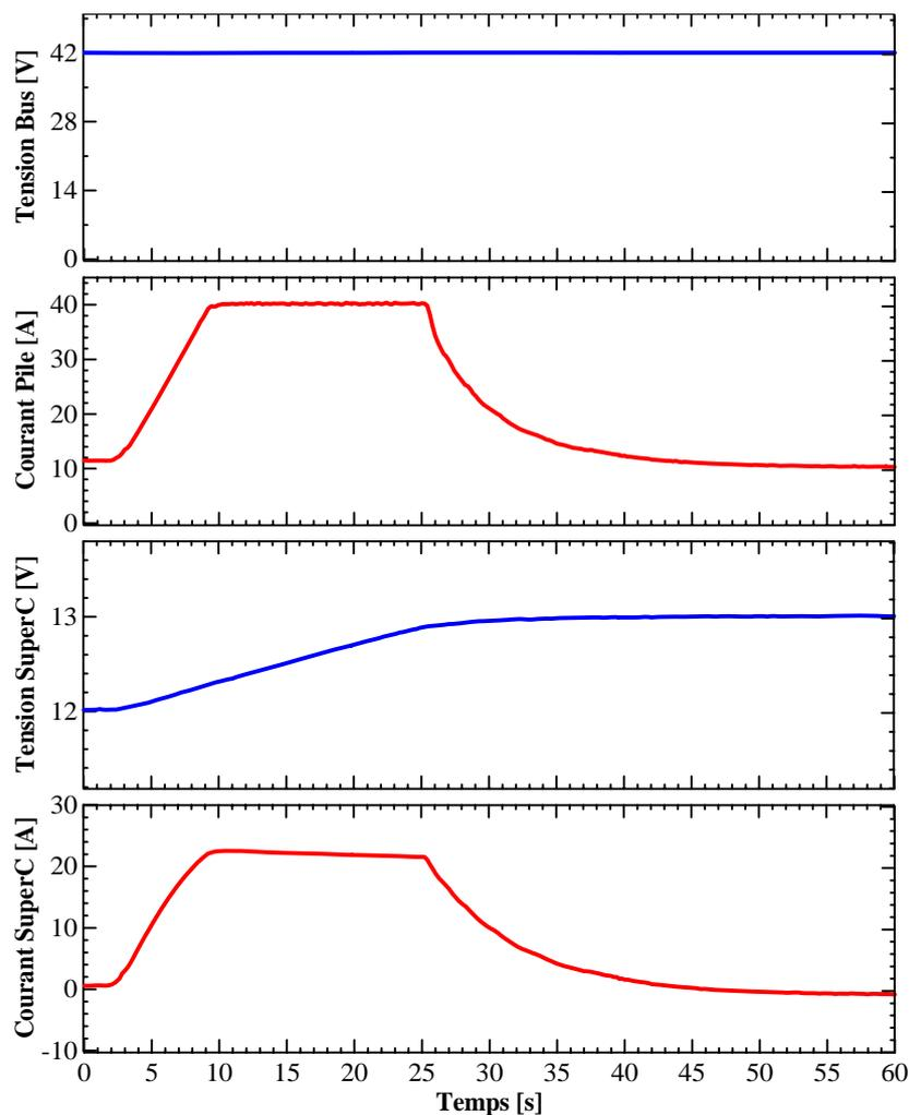
Figure 4.6 : Charge des supercondensateurs de 12 V à 13 V.
