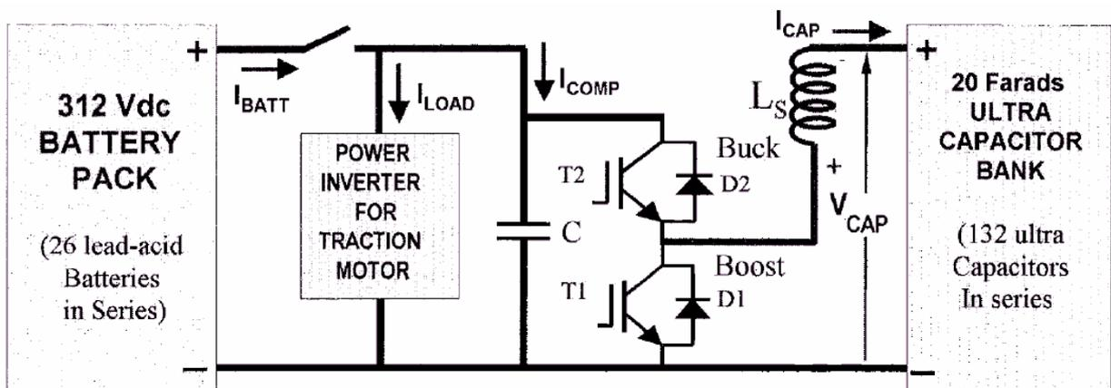
Figure 11 : Principe d'un véhicule hybride batterie - supercondensateur [Dix02a].
