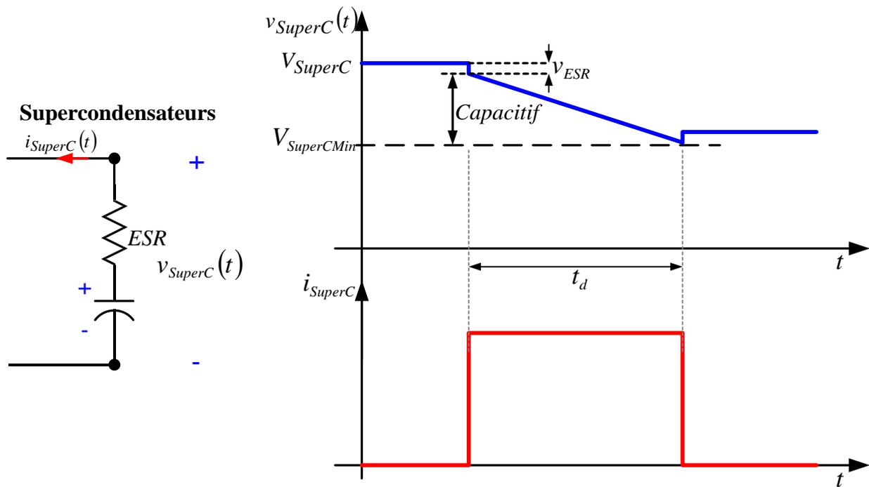
**Figure 2.32 :** Réponse typique en tension d'un supercondensateur lors d'une décharge à courant constant.
