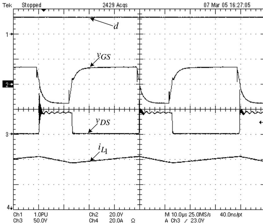
**Figure 3.19 :** Formes d'ondes associées au convertisseur de pile en régime stationnaire.
