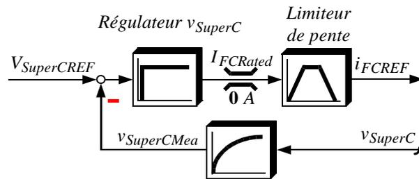
Figure 4.16 : Boucle de régulation de la tension supercapacitive.
