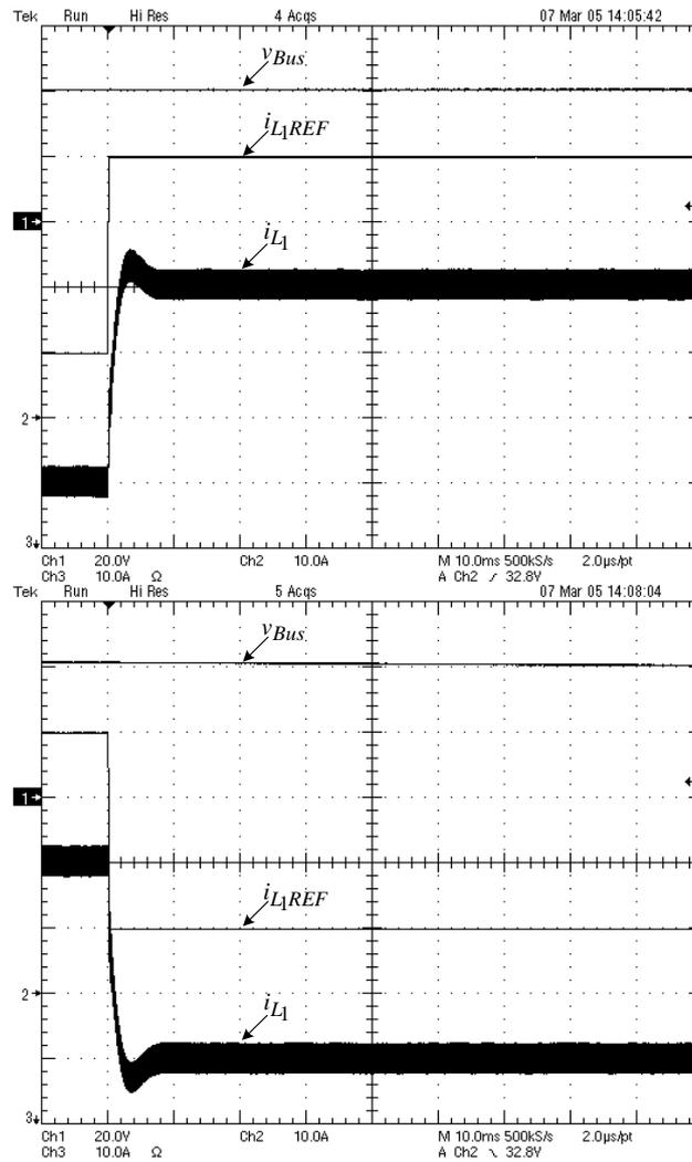
**Figure 3.21 :** Réponse du convertisseur de pile asservi à un échelon de courant.
