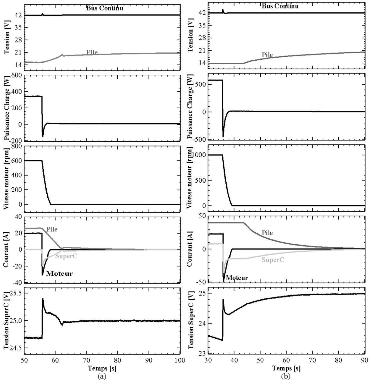
**Figure 4.18 :** Réponse de la source hybride à l'arrêt du moteur.
