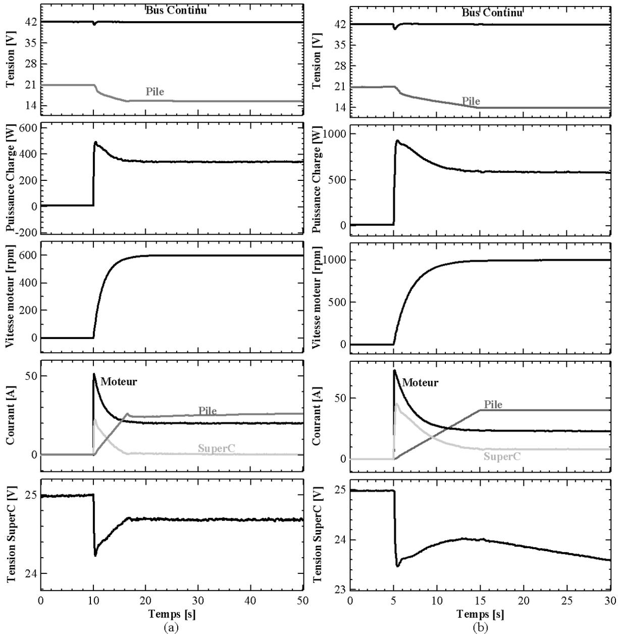
Figure 4.17 : Réponse de la source hybride au démarrage du moteur.
