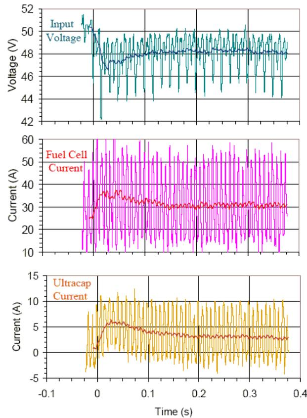
**Figure 2.25 :** Réponse du système à un échelon de puissance de 500 W
