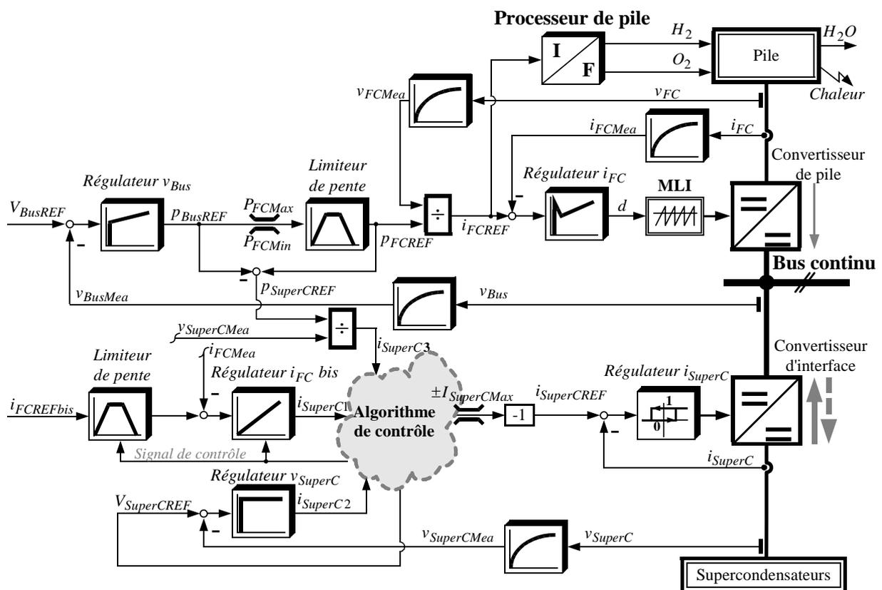
Figure 4.5 : Structure de contrôle avec permutations d'algorithmes [Tho05c].
