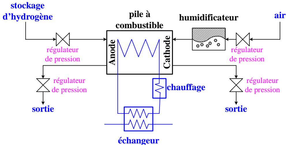
**Figure 3.2 :** Diagramme simplifié du système pile à combustible PEM 500 W du GREEN.
