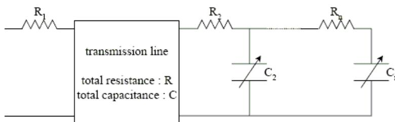
Figure 2.13 : Modèle énergétique distribué de F. Belhachemi [Bel00].
