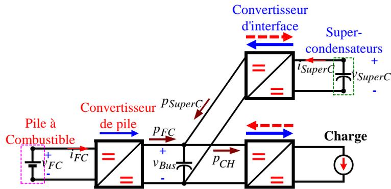
Figure 4.10 : Structure de la source hybride et notations.
