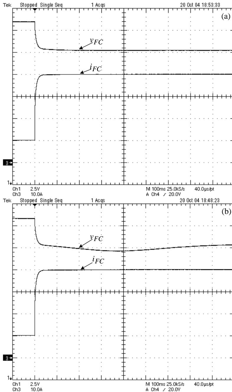
**Figure 3.25 :** Réponses en tension de la pile à un échelon de courant 10 A / 40 A.
