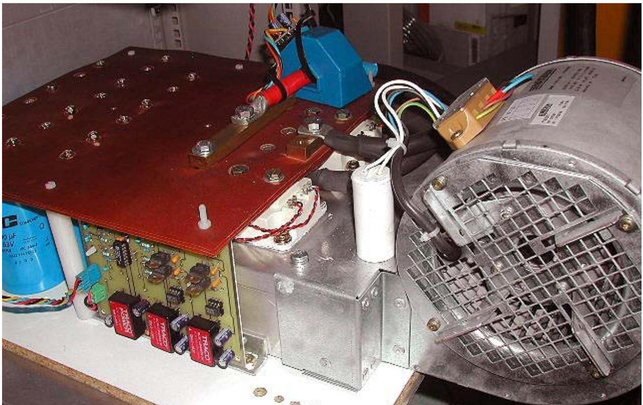
Figure 3.17 : Réalisation pratique du convertisseur d'interface.
