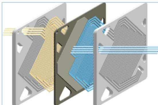
Figure 1.7 : Plaques bipolaire de pile PEM.
