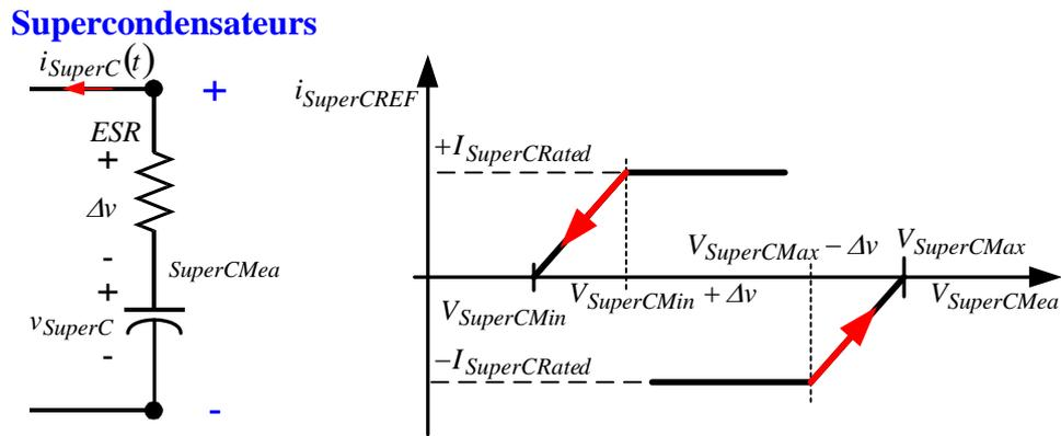
Figure 4.13 : Fonction de limitation du courant supercapacitif.
