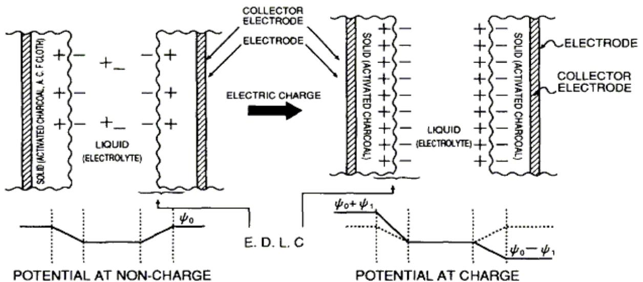
Figure 2.2 : Schéma de principe des supercondensateurs [Nis96].
