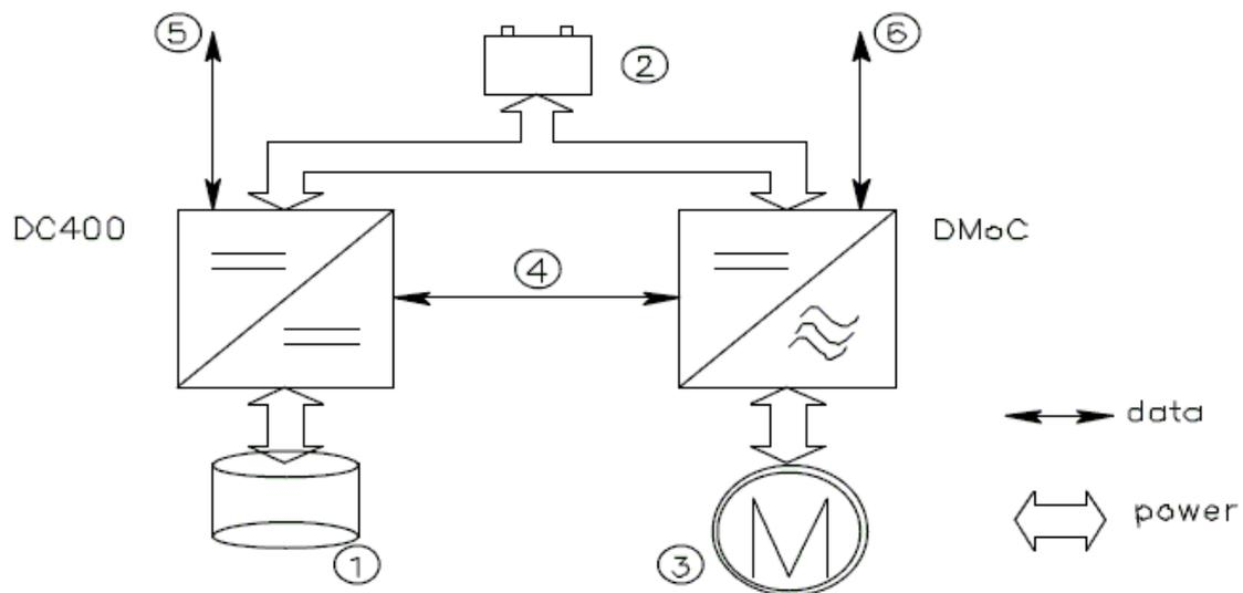
**Figure 2.19** : Schéma de principe de G. Wight *et al.* 1 : supercondensateurs, 2 : batteries, 3 : moteur, DMoC : convertisseur de charge, DC400 : convertisseur d'interface, 4, 5 et 6 : liaisons de communication [Wig02].
