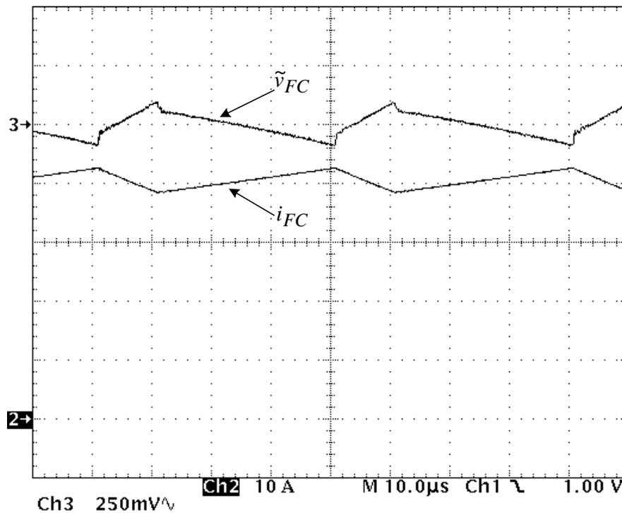
Figure 3.23 : Formes d'ondes de courant et de tension de la pile [Tho05a].
