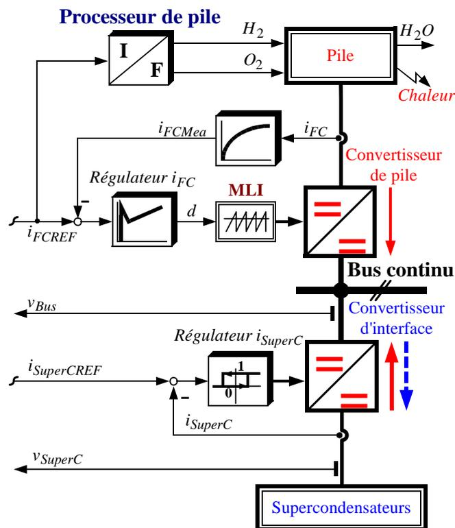
Figure 4.11 : Contrôles en courant de la source hybride.
