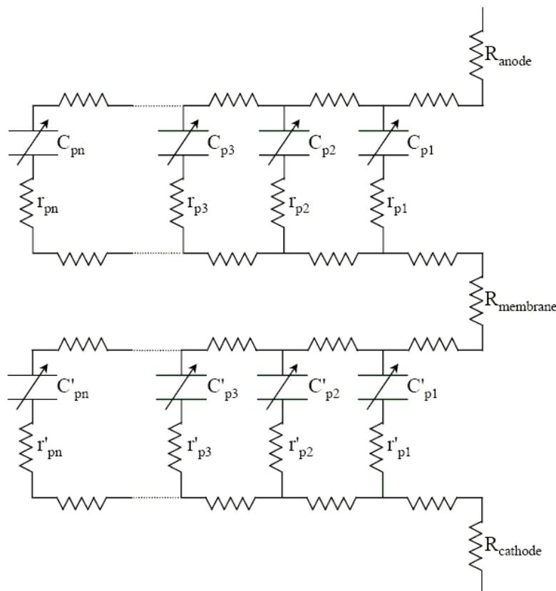
**Figure 2.11** : Modèle théorique d'un supercondensateur [Bel00].
