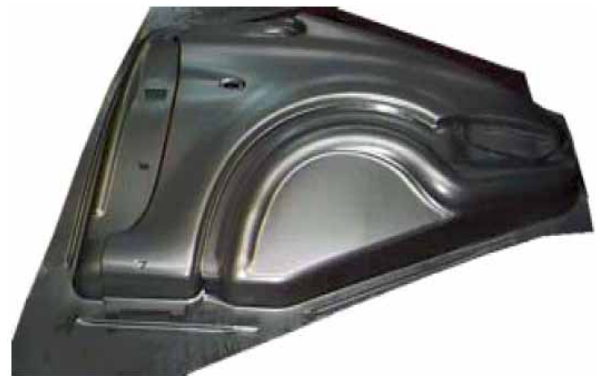
Aile avant de la Citroën Picasso (expérience), source : Chausson-Outillage
