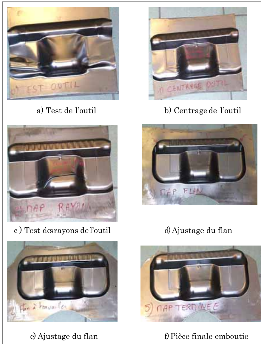
FIG. 1.9 – Déroulement du test expérimental (source : CIRTES).
