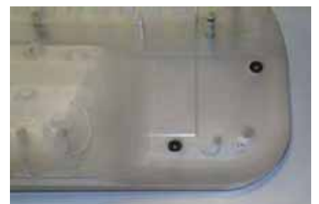
b) Assemblage des strates par vissage
