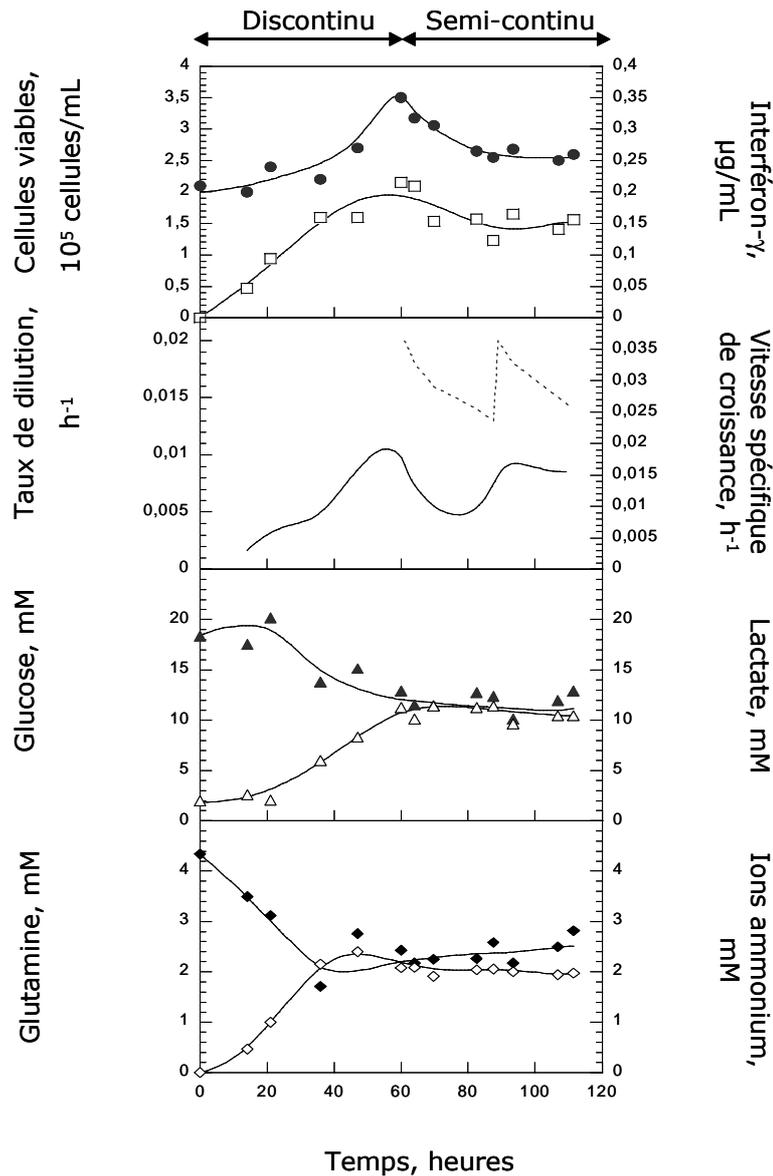
**Figure V.10 :** Evolution de la concentration en cellules viables (●), de la production d'IFN-γ (□), du taux de dilution (.....), de la vitesse spécifique de croissance (—), de la consommation de glucose (▲) et de glutamine (◆), et de la production de lactate (△) et d'ions ammonium (◇) au cours de la culture de cellules CHO 320, cultivées en milieu RPMI avec sérum, en mode semi-continu.
