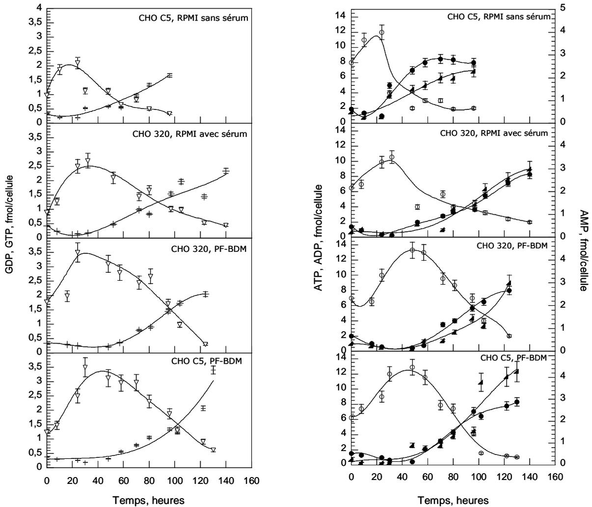
**Figure V.1** : Evolution des concentrations intracellulaires en GDP (+), GTP (▽), AMP (▲), ADP (●) et ATP (○) au cours de cultures discontinues de cellules CHO C5 et 320, cultivées en milieu RPMI avec et sans sérum, et en milieu PF-BDM.
