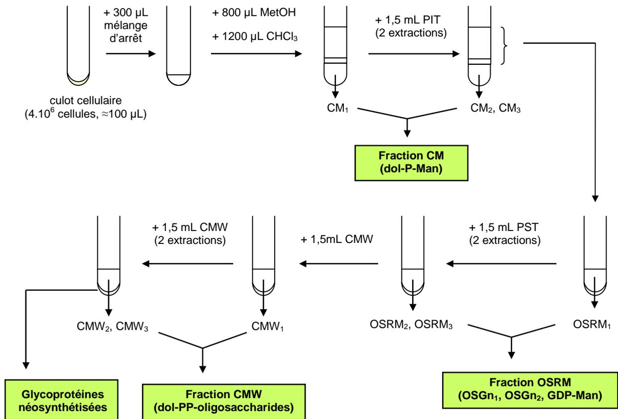
**Figure II.3** : Protocole d'extraction séquentielle des différents intermédiaires lipidiques (d'après Cacan et Verbert, 1995).
