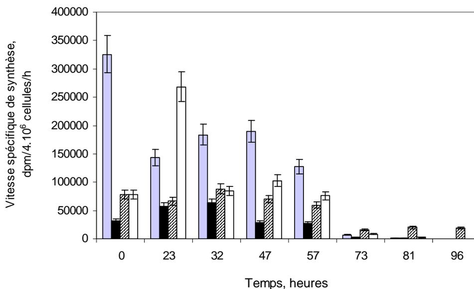
**Figure IV.9** : Evolution des vitesses de synthèse des glycoprotéines (■), des dol-PP-oligosaccharides (■), du dol-P-Mannose (▨), des OSGn<sub>1</sub>, OSGn<sub>2</sub> et du GDP-Mannose (□) au cours d'une culture discontinue de cellules CHO C5, cultivées en milieu RPMI sans sérum.
