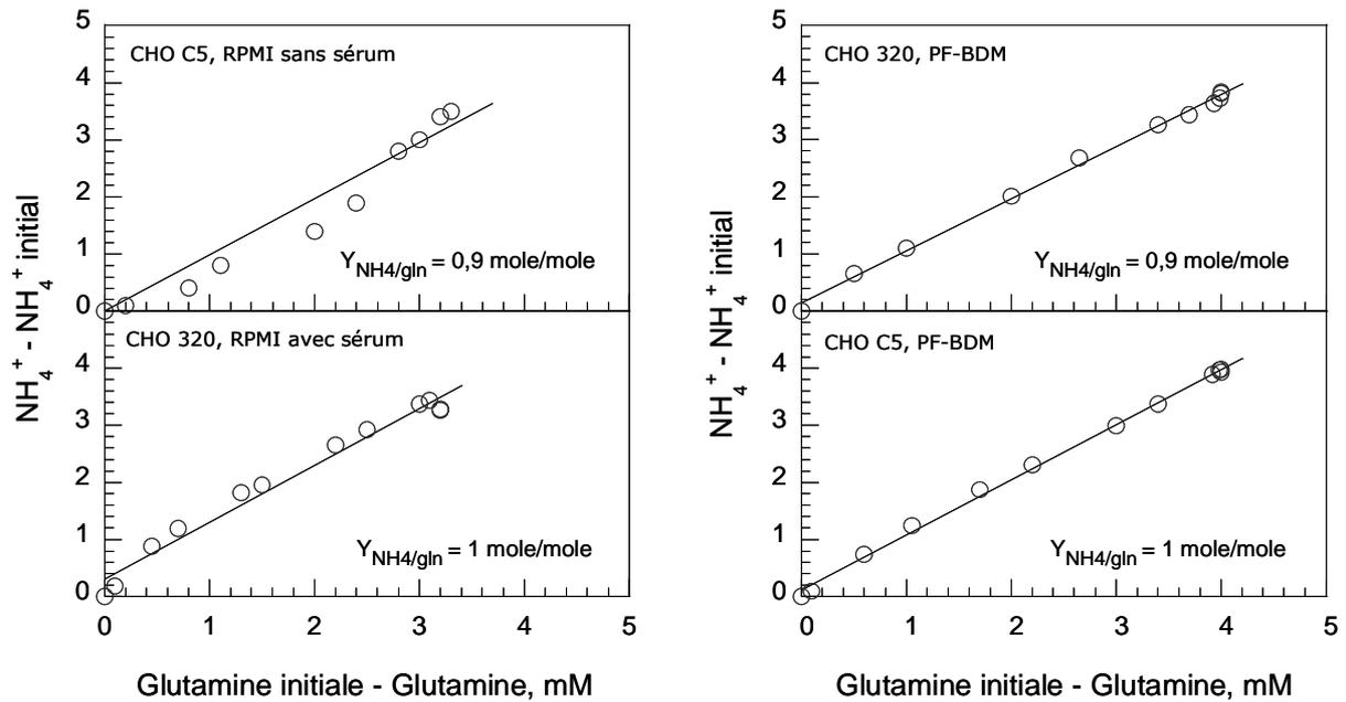
**Figure III.7** : Rendements de conversion glutamine-ions ammonium ( $Y_{\text{NH}_4/\text{gln}}$ ) lors des cultures discontinues de cellules CHO C5 et 320, cultivées en milieu RPMI avec et sans sérum, et en milieu PF-BDM.
