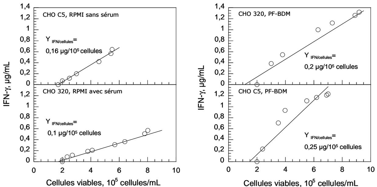
**Figure III.3 :** Relation entre la croissance cellulaire et la concentration en IFN- $\gamma$  durant les cultures discontinues de cellules CHO C5 et 320, cultivées en milieu RPMI avec et sans sérum, et en milieu PF-BDM.
