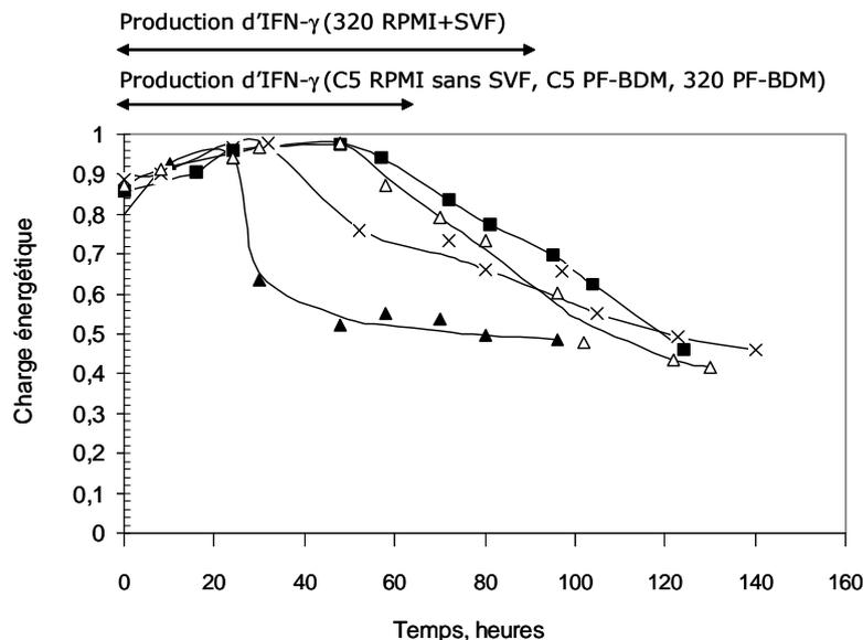
**Figure V.8** : Evolution de la charge énergétique ( $ATP+0,5ADP/ATP+ADP+AMP$ ) au cours des cultures discontinues de cellules CHO, cultivées en milieu RPMI, avec et sans sérum, et en milieu PF-BDM. Cellules CHO C5 en milieu RPMI sans sérum (▲), cellules CHO 320 en milieu RPMI avec sérum (×), cellules CHO 320 en milieu PF-BDM (■), cellules CHO C5 en milieu PF-BDM (△).
