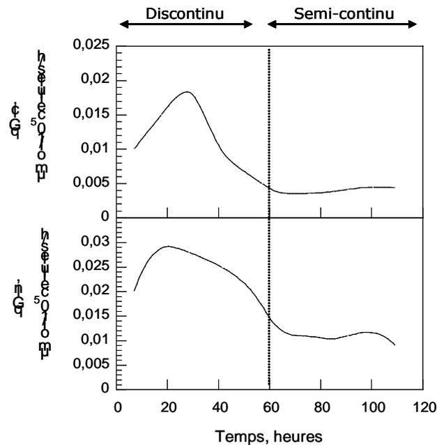
**Figure V.12** : Evolution des vitesses spécifiques de consommation du glucose ( $q_{\text{glc}}$ ) et de glutamine ( $q_{\text{gln}}$ ) au cours de la culture de cellules CHO 320, cultivées en milieu RPMI avec sérum, en mode semi-continu.
