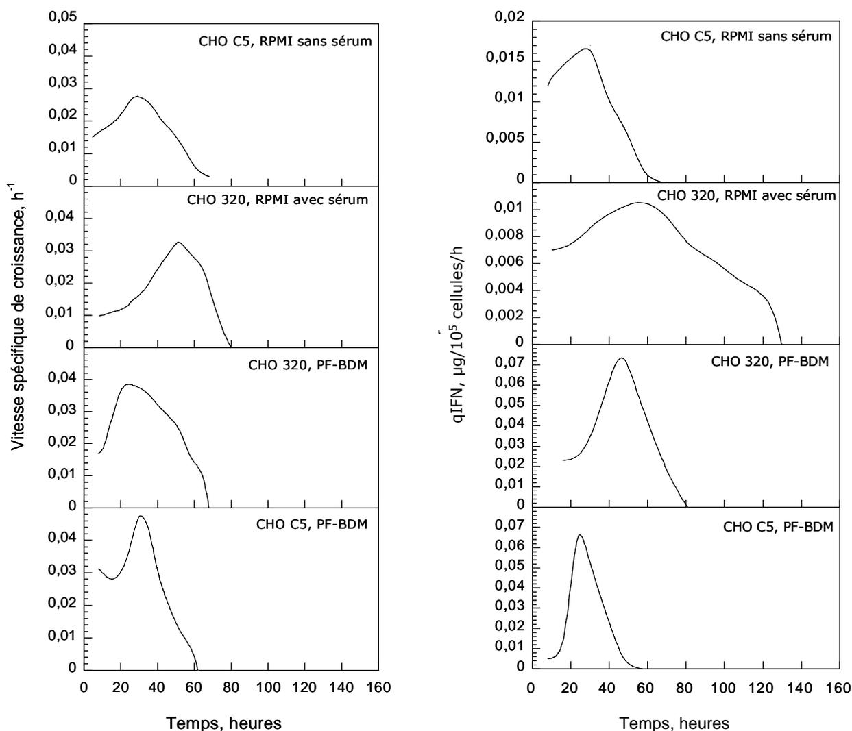
**Figure III.2 :** Vitesses spécifiques de croissance cellulaire et de production d'interféron- $\gamma$  au cours des cultures discontinues de cellules CHO C5 et 320 cultivées en milieu RPMI, avec et sans sérum, et en milieu PF-BDM.
