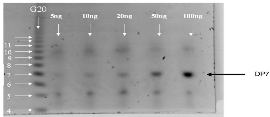
**Figure IV.15** : Gel de polyacrylamide réalisé pour la détermination de la sensibilité et le seuil de détection de la méthode FACE.
