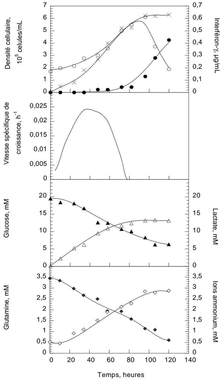
**Figure IV.5** : Cinétique de croissance (○), de décès cellulaire (●), de production d'IFN- $\gamma$  (×), de consommation de glucose (▲) et de glutamine (◆), de production de lactate (Δ) et d'ions ammonium (◇) d'une culture discontinue de cellules CHO C5, cultivées en milieu RPMI sans sérum.
