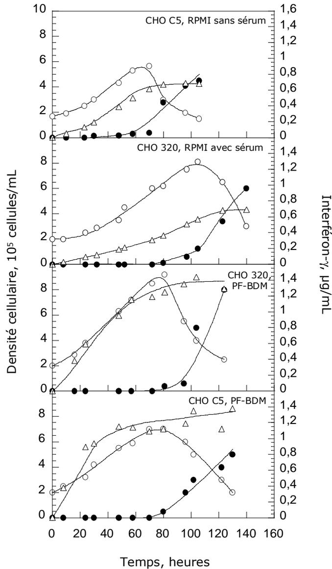
**Figure III.1** : Cinétique de croissance et de décès cellulaires et de production d'interféron- $\gamma$  au cours de cultures discontinues de cellules CHO C5 et 320 cultivées en milieu RPMI, avec et sans sérum, et en milieu PF-BDM (cellules viables :  $\circ$ , cellules mortes :  $\bullet$ , IFN- $\gamma$  :  $\triangle$ ).
