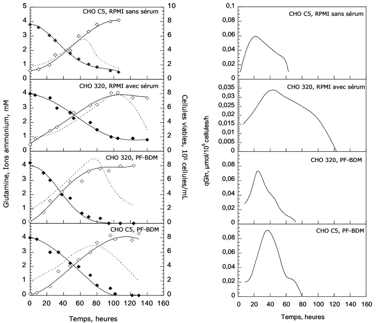
**Figure III.6 :** Cinétiques de consommation de la glutamine et de production d'ions ammonium au cours de cultures discontinues de cellules CHO C5 et 320, cultivées en milieu RPMI avec et sans sérum, et en milieu PF-BDM (glutamine :  $\blacklozenge$ , ions ammonium :  $\diamond$ , cellules viables :  $\cdots$ ).
