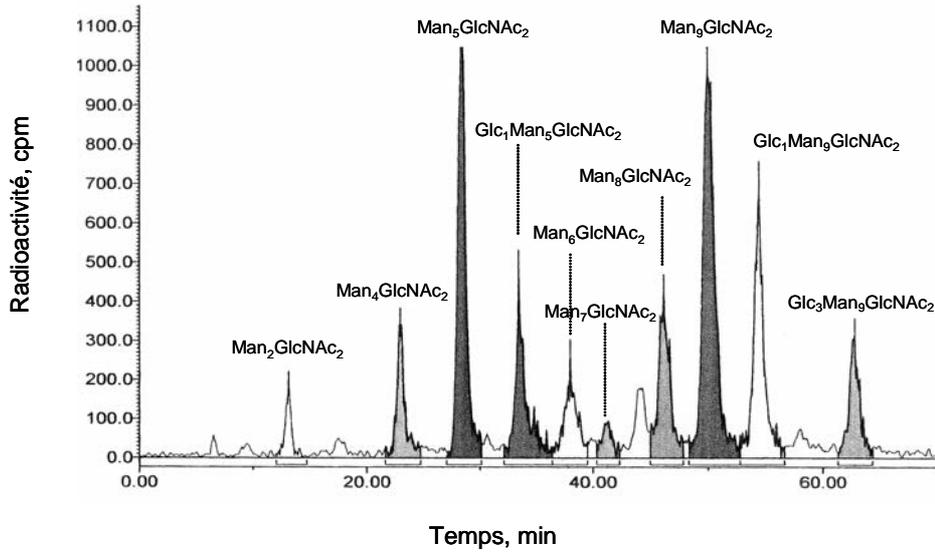
**Figure IV.11** : Mélange standard d'oligosaccharides séparés et analysés par CLHP couplée à un détecteur de radioactivité.
