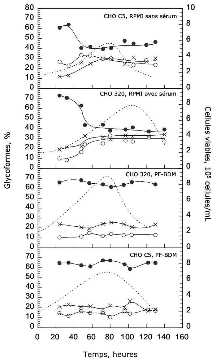
**Figure III.10 :** Evolution de la macrohétérogénéité de la glycosylation de l'interféron- $\gamma$  au cours de cultures discontinues de cellules CHO C5 et 320, cultivées en milieu RPMI, avec et sans sérum, et en milieu PF-BDM (IFN- $\gamma$  biglycosylé : ●, IFN- $\gamma$  monoglycosylé : ○, IFN- $\gamma$  non glycosylé : ×, concentration en cellules viables : .....).
