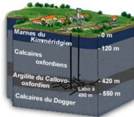
Figure I.1 : Schéma du laboratoire souterrain de Meuse/Haute-Marne.
