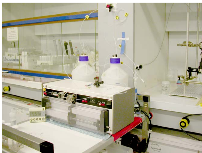
Figure II.4 : Photo de la partie amont du dispositif expérimental (solutions d'alimentation et pompe à double piston).
