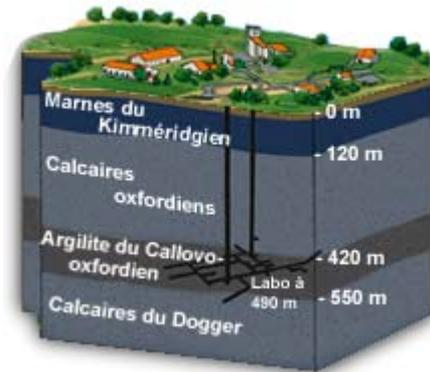
**Figure I.1 : Schéma du laboratoire souterrain de Meuse/Haute-Marne.**
