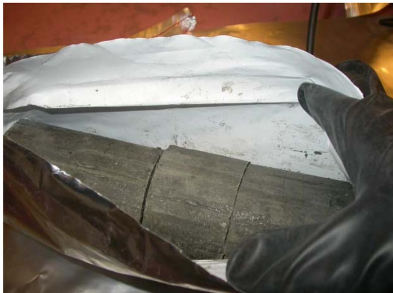
**Figure II.1 : Photo de la carotte EST10425 (forage EST312) lors de sa réception au laboratoire.**
