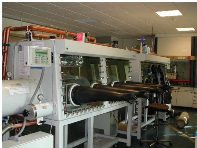
**Figure II.16 : Photo de la BAG solide (premier plan) et de la BAG chimie (second plan).**
