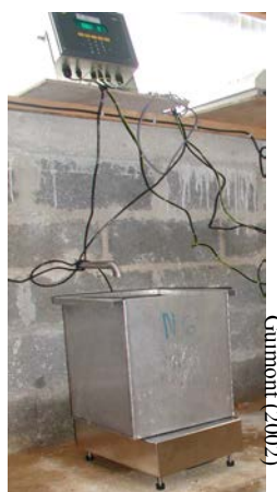
Photo 2.4.1 : Bac de récupération des percolats équipé d'une balance reliée à une interface d'enregistrement
