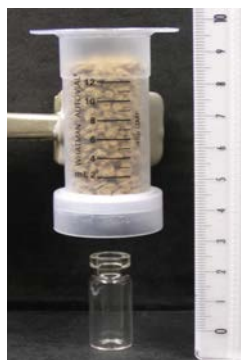
Photo 2.1.1 : Micro-colonne (autovial Whatman®) remplie avec des agrégats de terre sèche : un flacon d'échantillonnage peut être adapté à l'extrémité de la colonne pour collecter la solution du sol par centrifugation
