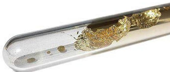
*Fig. O.26 : Ampoule avec du césium métallique [C.9].*
