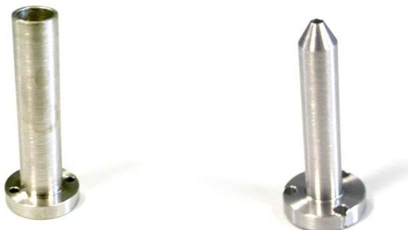
*Fig. 3.6 : Photos du réservoir de césium métallique et de l'embout de l'évaporateur à césium neutre.*
