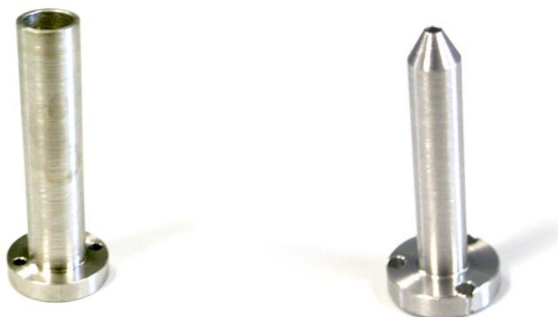
Fig. 3.6 : Photos du réservoir de césium métallique et de l'embout de l'évaporateur à césium neutre.
