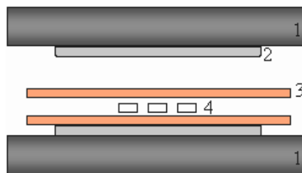
Figura 4.3.1: Esquema da termoprensagem (1) Placas superior e inferior da prensa (2) Placas de aço inox polidas (3) Filmes de poliimida (Kapton) (4) grânulos dos nanocompósitos.
