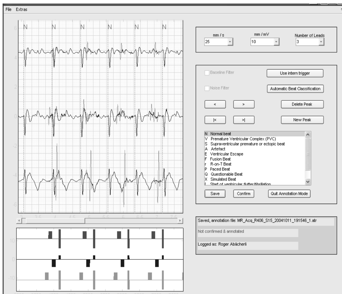
Fig. 79 La suppression "offline" par filtrage de Wiener permet une annotation manuelle ou automatique des ECG acquis en IRM. On voit clairement que les courbes restaurées (foncées) sont plus facile à interpréter que les courbes originales (claires).
