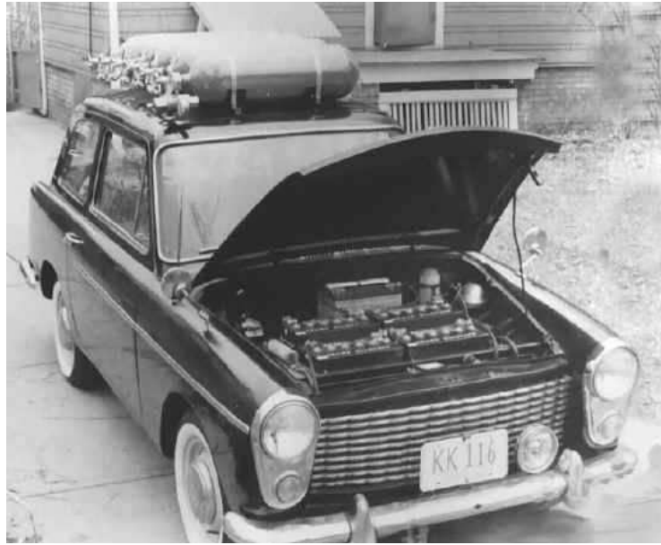
Fig. 2 – Prototype proposé en 1970 par Kordesch-Austin.
