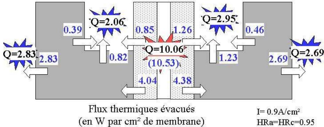
Fig. IV.20 – Répartition des flux thermiques dans l'AME.
