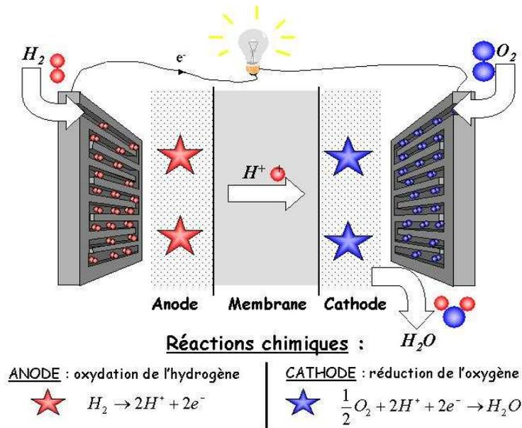
Fig. I.2 – Principe de fonctionnement d'une pile PEMFC.
