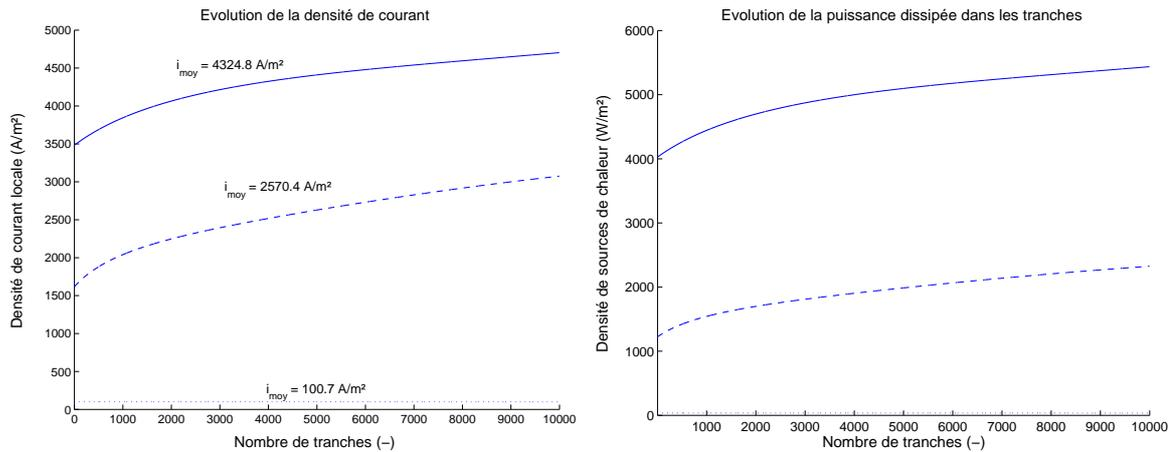
**Fig. VI.14** – Evolution de la densité de courant et des puissances thermiques dissipées dans les tranches pour  $V = 0.1 V$  : trait plein,  $V = 0.5 V$  : trait discontinu et  $V = 0.9 V$  : trait pointillé ( $HR_a = 0.1$ ,  $HR_c = 0.9$ ,  $St_{H_2} = 1$ ,  $St_{O_2} = 5$ ).
