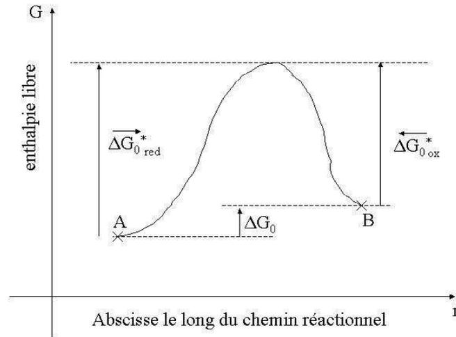
Fig. III.5 – Variation de l'énergie potentielle lors du passage de l'état initial  $i$  à l'état final  $f$ .
