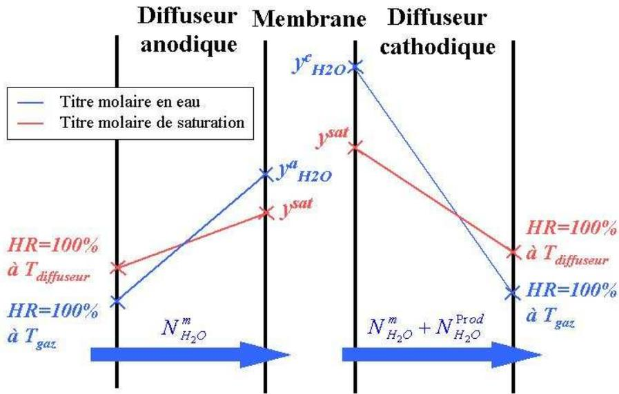
Fig. IV.25 – Conditions de condensation de l'eau vapeur.
