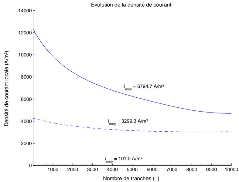
**Fig. VI.12** – Analyse de la densité de courant locale par tranche pour  $V = 0.1 V$  : trait plein,  $V = 0.5 V$  : trait discontinue et  $V = 0.9 V$  : trait pointillé ( $HR_a = HR_c = 0.9$ ,  $St_{H_2} = 1.1$ ,  $St_{O_2} = 8$ ).
