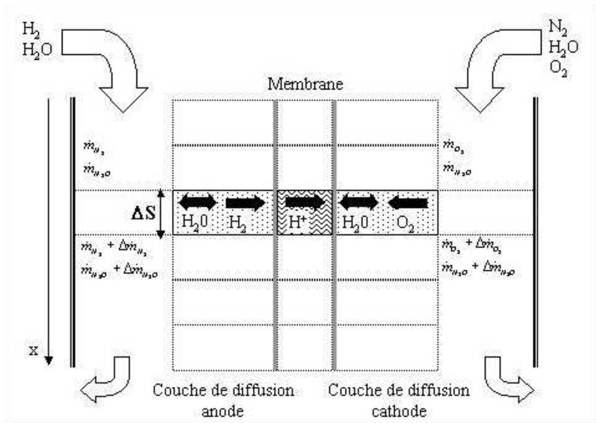
Fig. VI.7 – Schéma représentatif du modèle pseudo-2D.
