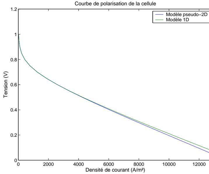
**Fig. VI.13** – Comparaison des modèles 1D et pseudo-2D ( $HR_a = HR_c = 0.9$ ,  $St_{H_2} = St_{O_2} = 15$ ).
