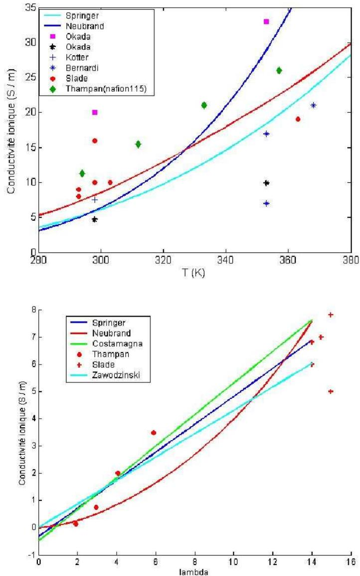
**Fig. III.6** – Evolution de la conductivité protonique de la membrane Nafion 117 en fonction de la température (en contact avec de l’eau liquide) [SZG91] [Neu99] [OXM98] [KPK99] [BV92] [SCRW02] [TMTR00] et en fonction de l’hydratation de la membrane (en contact avec de la vapeur d’eau) [SZG91] [Neu99] [Cos01] [TMTR00] [SCRW02] [ZNSG91].
