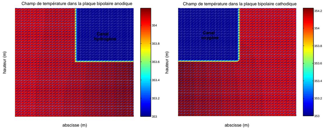
Fig. IV.19 – Profil de température dans les plaques bipolaires.
