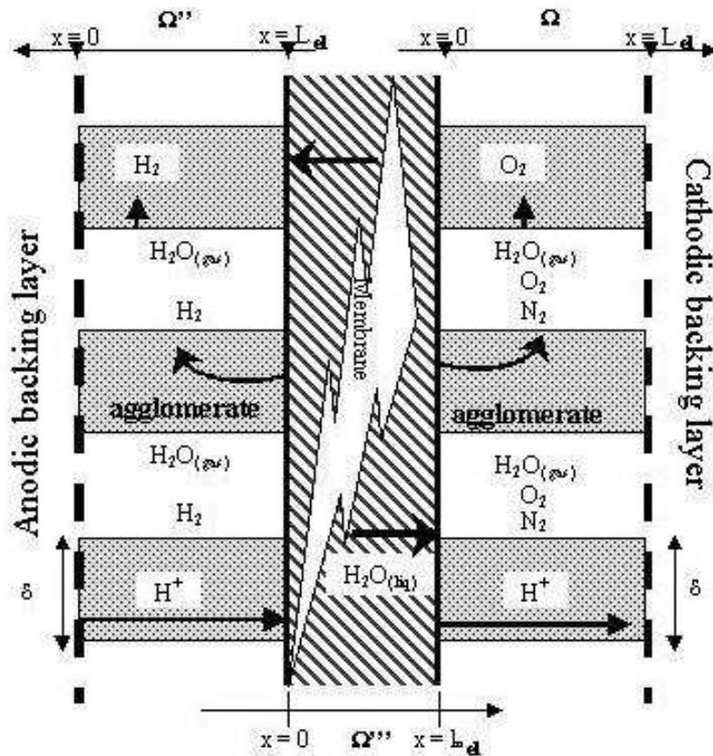
Fig. III.7 – Représentation schématique des couches actives.
