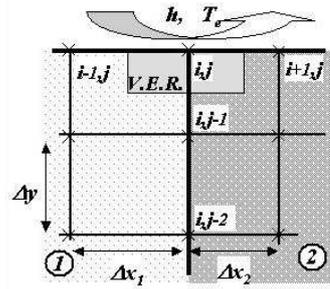
Fig. VI.25 – Représentation du volume de contrôle pour un échange convectif au nord au niveau de l'interface entre deux solides.
