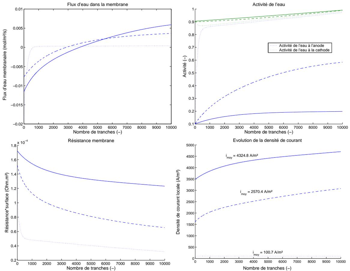
**Fig. VI.10** – Analyse de résultats du modèle pseudo-2D par tranche pour  $V = 0.1 V$  : trait plein,  $V = 0.5 V$  : trait discontinu et  $V = 0.9 V$  : trait pointillé ( $HR_a = 0.1$ ,  $HR_c = 0.9$ ,  $St_{H_2} = 1$ ,  $St_{O_2} = 5$ ).
