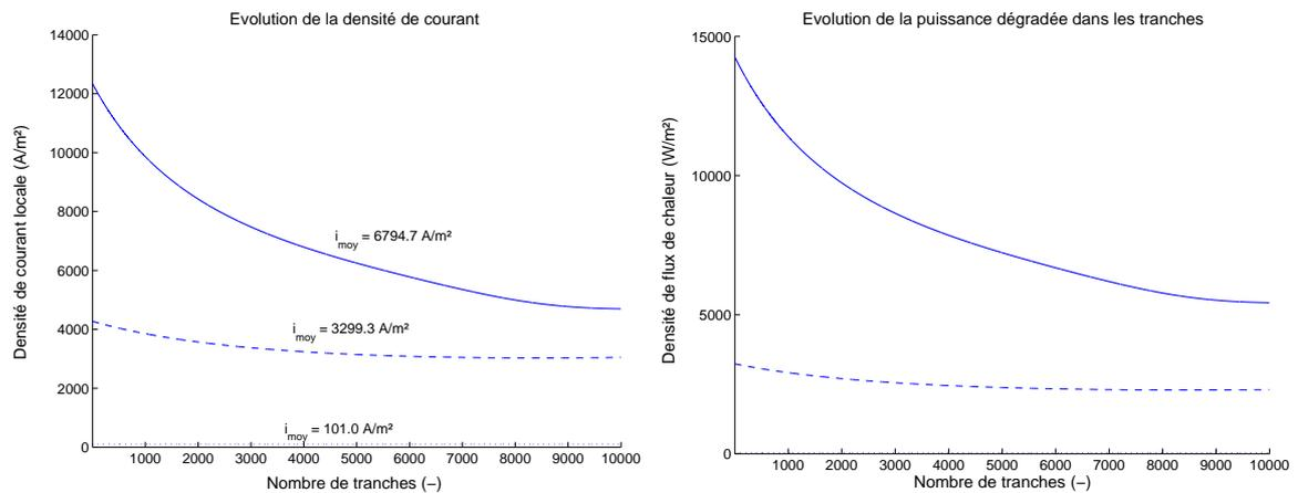
**Fig. VI.17** – Evolution de la densité de courant et des puissances thermiques dissipées dans les tranches pour  $V = 0.1 V$  : trait plein,  $V = 0.5 V$  : trait discontinu et  $V = 0.9 V$  : trait pointillé ( $\text{HR}_a = \text{HR}_c = 0.9$ ,  $St_{H_2} = 1.1$ ,  $St_{O_2} = 8$ ).
