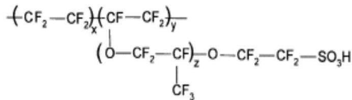
Fig. I.4 – Structure de la membrane Nafion.
