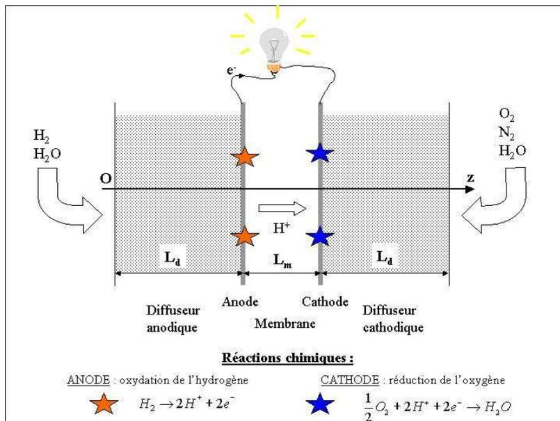
Fig. II.1 – Schéma représentatif de l'AME considérée.
