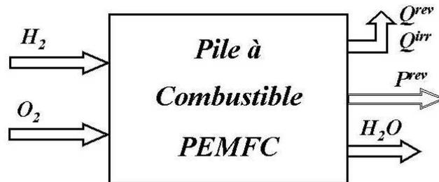
Fig. III.1 – Approche thermodynamique, type « boîte noire » pour une pile PEMFC.
