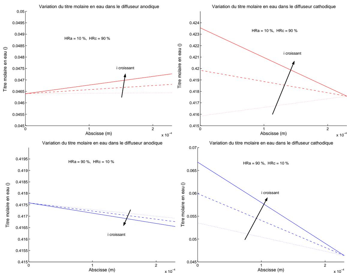
**Fig. II.8** – Variation des titres molaires en eau dans les diffuseurs anodique et cathodique pour différentes densités de courant (trait pointillé :  $i = 0.1 \text{ A/cm}^2$ , discontinu  $i = 0.3 \text{ A/cm}^2$  et plein  $i = 0.5 \text{ A/cm}^2$ ).
