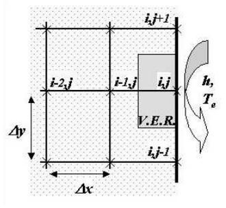
Fig. VI.24 – Représentation du volume de contrôle pour un échange convectif à l'est.
