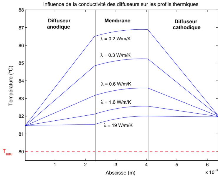
**Fig. IV.14** – Profil de température pour différentes valeurs de conductivité thermique des diffuseurs pour  $i = 0.7 \text{ A/cm}^2$ ,  $HR_a = HR_c = 0.9$  (Cas 1) ( $k = 0.2 \text{ W/m/K}$  : [VK04],  $k = 0.3 \text{ W/m/K}$  : nos mesures,  $k = 0.6 \text{ W/m/K}$ ,  $k = 1.6 \text{ W/m/K}$  : [DL02], [RL01], [Inc01],  $k = 19 \text{ W/m/K}$  : [GLK98], [WHZL03]).
