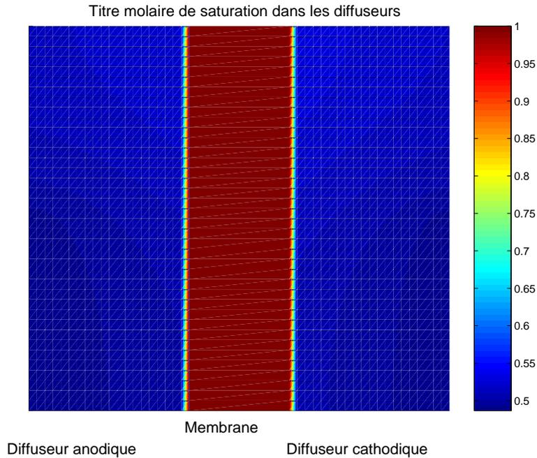
**Fig. IV.24** – Titre de saturation dans l'AME.
