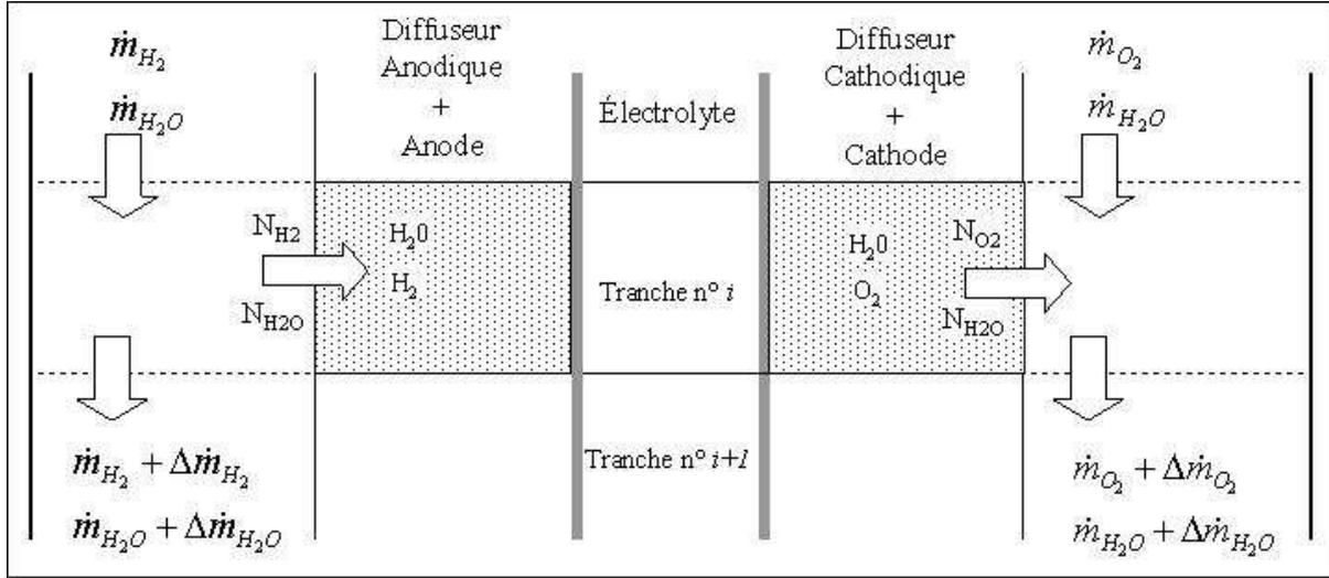
Fig. VI.8 – Schéma représentatif du modèle pseudo-2D.
