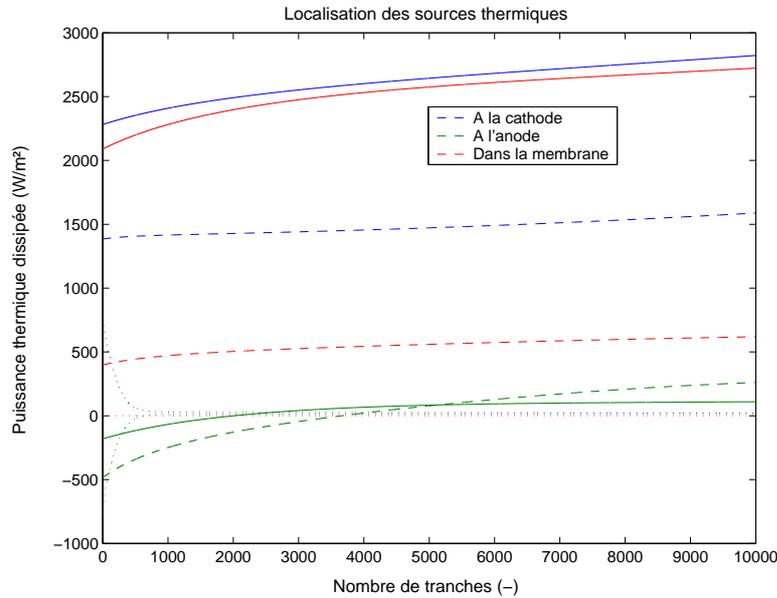
**Fig. VI.16** – Localisation des sources thermiques pour  $V = 0.1$  V : trait plein,  $V = 0.5$  V : trait discontinu et  $V = 0.9$  V : trait pointillé ( $HR_a = 0.1$ ,  $HR_c = 0.9$ ,  $St_{H_2} = 1$ ,  $St_{O_2} = 5$ ).
