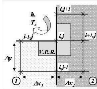
Fig. VI.27 – Représentation du volume de contrôle pour un coin intérieur, Cas 1.
