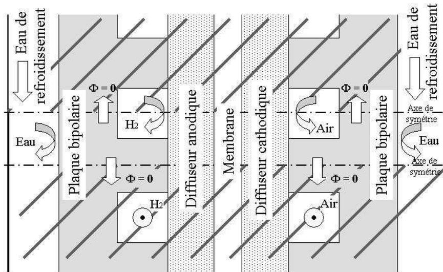
Fig. IV.15 – Représentation d'une tranche de cellule isolée thermiquement.
