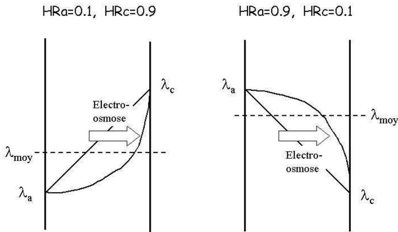
Fig. III.10 – Allure des profils en eau dans la membrane pour une humidification d'un seul côté.
