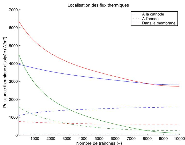
**Fig. VI.18** – Localisation des puissances thermiques dissipées dans le plan de la cellule pour  $V = 0.1 V$  : trait plein,  $V = 0.5 V$  : trait discontinu et  $V = 0.9 V$  : trait pointillé ( $HR_a = HR_c = 0.9$ ,  $St_{H_2} = 1.1$ ,  $St_{O_2} = 8$ ).
