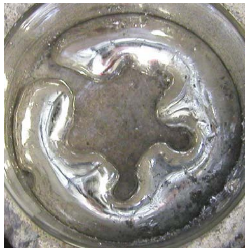
Figure 11 : Forme stable de la nappe à 120 A_{\text{eff}}
