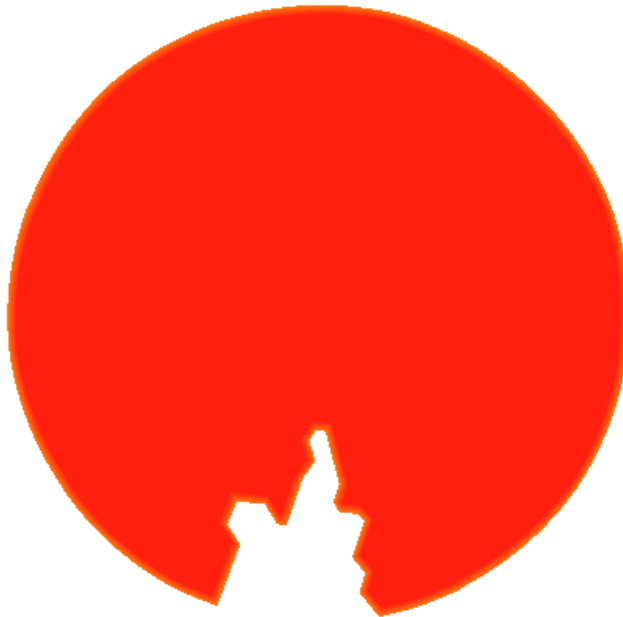
Figure 56 : Forme d'équilibre correspondant à un courant source de 20A.
