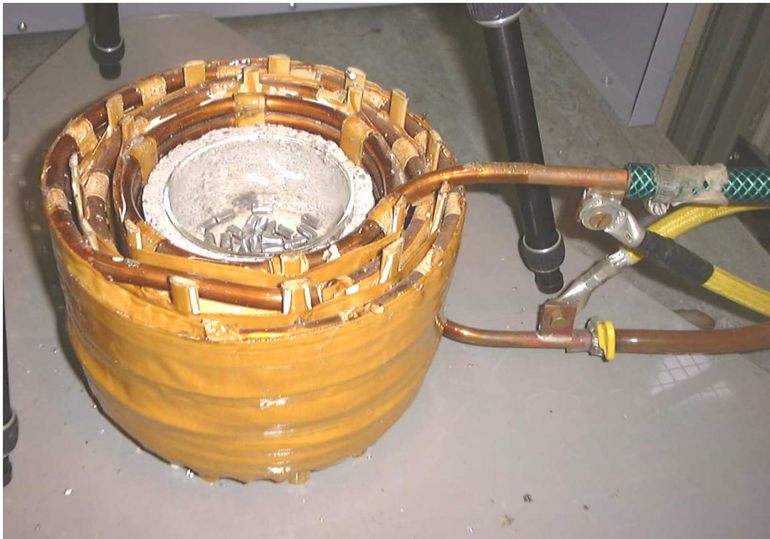
Figure 5 : Inducteur utilisé dans l'expérience
