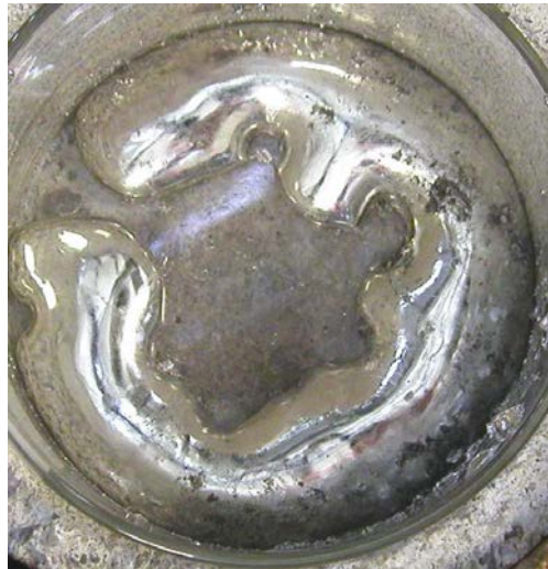
Figure 13 : Etat d'équilibre après une deuxième perturbation ( I_S = 120 A_{eff} )
