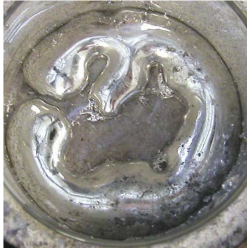
Figure 12 : Etat d'équilibre après une première perturbation ( I_S = 120 A_{eff} )
