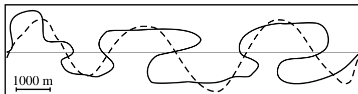
FIG. 6.6 : Impact de la sinuosité : les deux courbes ont la même longueur d'onde ( \lambda = 3300m ) et amplitude moyenne ( a = 1200m ), mais leurs sinuosités sont différentes de façon significative : 1.53 pour la courbe en pointillé, 2.38 pour la courbe pleine.
