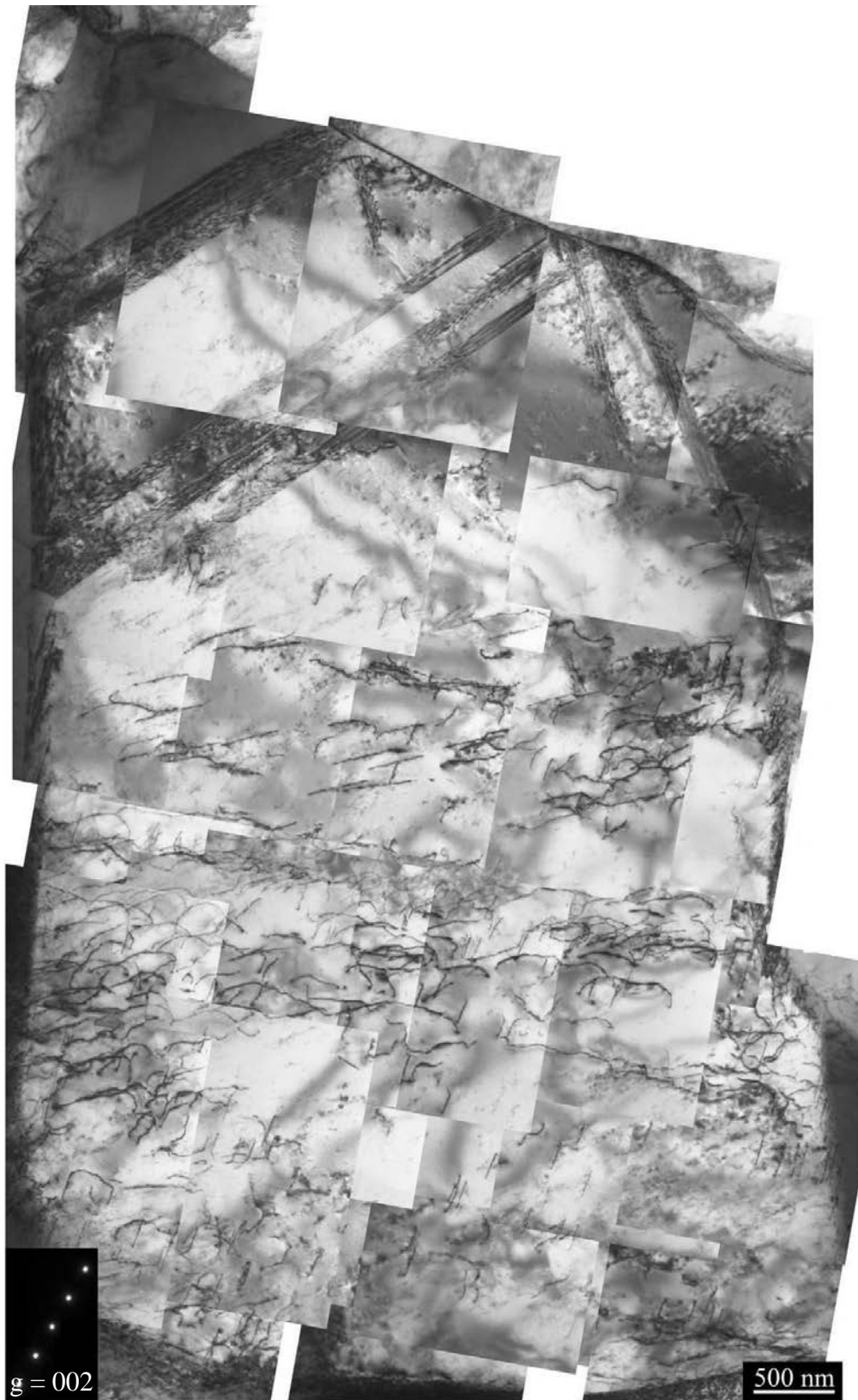
Figure V. 23 : Micrographie électronique en transmission du grain 1 déformé à 5 % en compression quasistatique à 450 °C, prise dans les conditions de deux ondes \bar{g} = 002 . Les dislocations en contraste sont des superdislocations, les dislocations invisibles sont des dislocations ordinaires.
