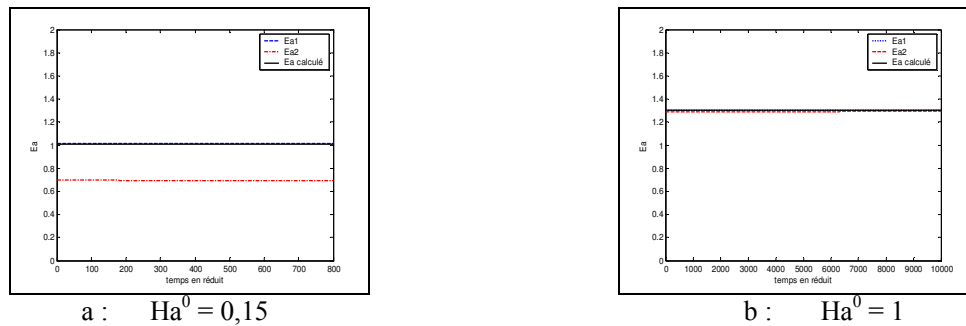
Figure VI-A-3 : Comparaison de E_A calculé avec les autres expressions : M = 0,01 , E_{A1-1} = 10 , \beta = 100
