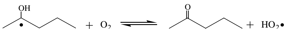
Réaction II-13 : Oxydation de radical 2-hydroxy-pent-2-yle par arrachage d'un atome d'hydrogène hydroxylique
