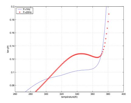
Fig. IV.8: Mesures isochrones à 20 (\*) et 1 (-) Hz de  $tan\varphi$  d'un PMMA vieilli 72H à la température ambiante
