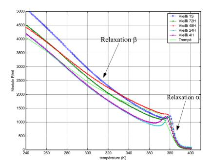
Fig. II.22: Variation du module réel en fonction de la température d'un PMMA vieilli à la temperature T=363K sollicité à une fréquence F=0,33Hz
