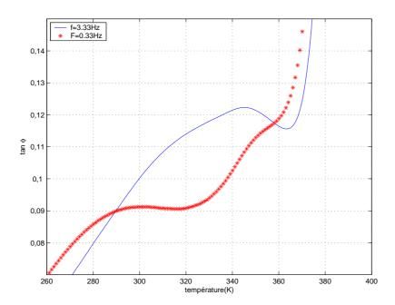
FIG. IV.19: Mesures isochrones à 0,33 (\*) et 3,33 (-) Hz de  $tan\varphi$  d'un PMMA vieilli 1 semaine à 313 K
