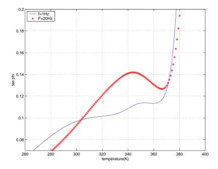
FIG. IV.20: Mesures isochrones à 20 (\*) et 1 (-) Hz de  $tan\varphi$  d'un PMMA vieilli 1 semaine à 313 K
