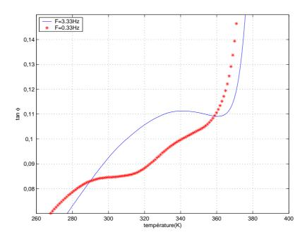
FIG. IV.7: Mesures isochrones à 0,33 (\*) et 3,33 (-) Hz de  $\tan\varphi$  d'un PMMA vieilli 72H à la température ambiante
