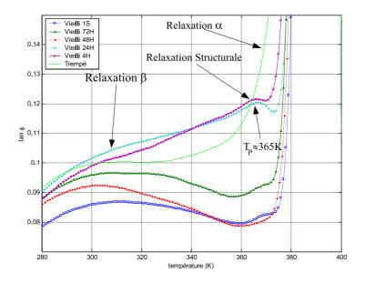
Fig. II.23: Mesure isochrone à 0,33Hz de  $tan\varphi$  d'un PMMA vieilli à la température  $T{=}363K$
