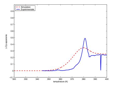
FIG. III.22:  $\Delta C_p$  d'un PMMA vieilli 24 heures à 363K : comparaison entre courbe théorique et expérimentale, vitesse de chauffage =5K/min
