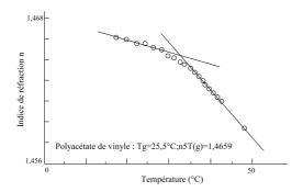
Fig. I.7: Mise en évidence de la transition vitreuse par mesure de l'indice de réfraction en fonction de la température [Etienne, 2002]
