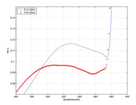
FIG. IV.37: Mesures isochrones à 0,33 (\*) et 3,33 (-) Hz de  $tan\varphi$  d'un PMMA vieilli 72H à 363 K
