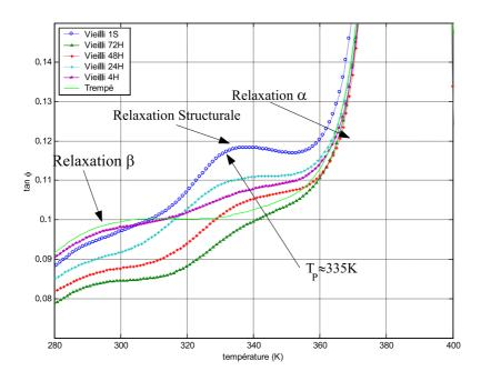
Fig. II.13: Mesure isochrone à 0,33Hz de  $tan\varphi$  d'un PMMA vieilli à la température ambiante
