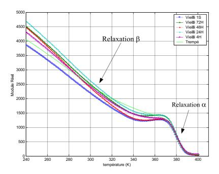
**FIG. II.14**: Variation du module réel en fonction de la température d'un PMMA vieilli à la temperature T=313K sollicité à une fréquence F=0,33Hz
