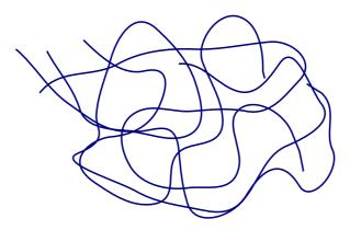
Fig. I.11: Structure amorphe de type pelote statique d'un polymère
