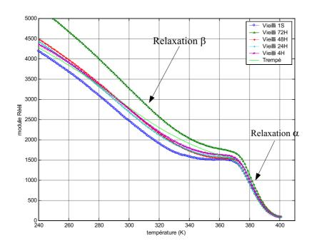
FIG. II.10: Variation du module réel en fonction de la température d'un PMMA vieilli à la temperature ambiante (293K) sollicité à une fréquence F=3,33Hz
