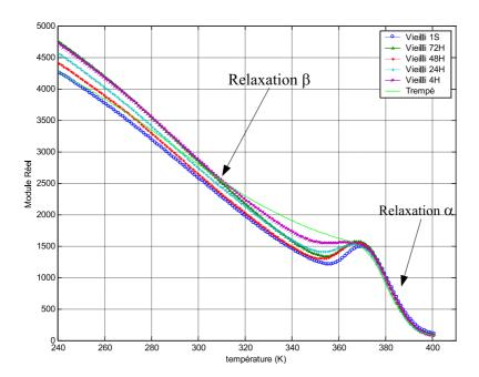
FIG. II.20: Variation du module réel en fonction de la température d'un PMMA vieilli à la temperature T=333K sollicité à une fréquence F=3,33Hz
