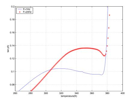
Fig. IV.38: Mesures isochrones à 20 (\*) et 1 (-) Hz de  $tan\varphi$  d'un PMMA vieilli 72H à 363 K
