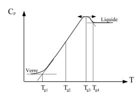
FIG. II.2: Thermogramme schématique  $C_p(T)$ ; différentes définitions de  $T_q$
