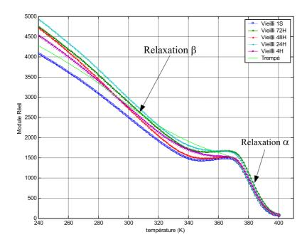
**FIG. II.16**: Variation du module réel en fonction de la température d'un PMMA vieilli à la temperature T=313K sollicité à une fréquence F=3,33Hz
