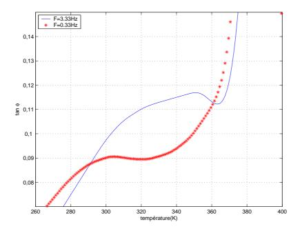
FIG. IV.23: Mesures isochrones à 0,33 (\*) et 3,33 (-) Hz de  $tan\varphi$  d'un PMMA vieilli 24H à 333 K
