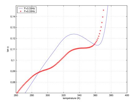
Fig. IV.3: Mesures isochrones à 0,33 (\*) et 3,33 (-) Hz de  $tan\varphi$  d'un PMMA vieilli 24H à l'ambiante
