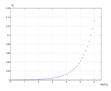
Fig. III.2: Spectre de relaxation définie à partir par 50 modes dissipatifs sur une échelle de temps choisie de 6 decades
