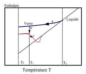
FIG. III.4: Représentation schématique du diagramme enthalpique : (a) trempe à partir de l'état liquide à q, (b) vieillissement à la température  $T_v$  durant un temps  $t_v$ , (c) chauffage à  $q_c$  après un refroidissement jusqu'à  $T_0$
