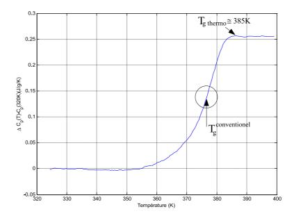
FIG. II.5: Variation de la chaleur spécifique  $\Delta C_p$  en fonction de la température (q=5K/min) d'un PMMA dans un état trempé (corrigée)
