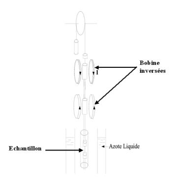
Fig. II.3: Dispositif mécanique du pendule de torsion
