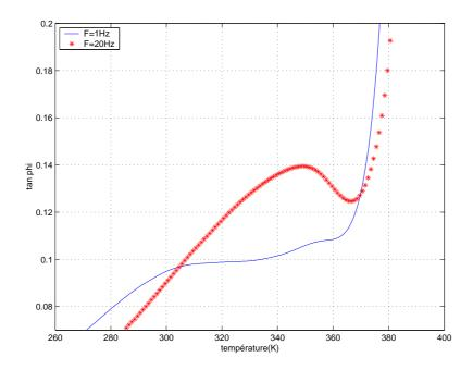
FIG. IV.24: Mesures isochrones à 20 (\*) et 1 (-) Hz de  $tan\varphi$  d'un PMMA vieilli 24H à 333 K
