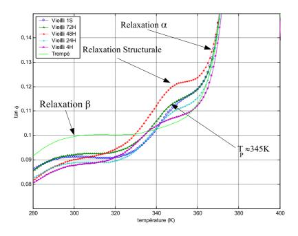
Fig. II.15: Mesure isochrone à 0,33Hz de  $tan\varphi$  d'un PMMA vieilli à la température  $T{=}313K$
