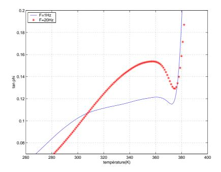
FIG. IV.32: Mesures isochrones à 20 (\*) et 1 (-) Hz de  $tan\varphi$  d'un PMMA vieilli 4H à 363 k
