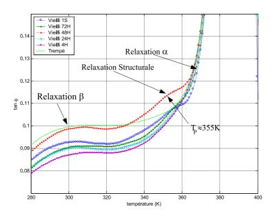
FIG. II.19: Mesure isochrone à 0.33Hz de  $tan\varphi$  d'un PMMA vieilli à la température T=333K
