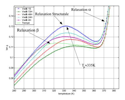
Fig. II.11: Mesure isochrone à 3,33Hz de  $tan\varphi$  d'un PMMA vieilli à la température ambiante (293K)
