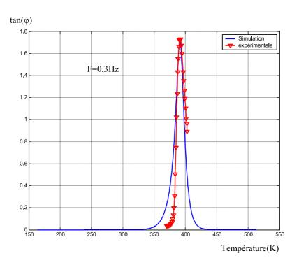
FIG. III.31: Modélisation de la relaxation  $\beta$  pour finir, la figure III.32 superpose les relaxation  $\alpha$  et  $\beta$  ainsi simulées.
