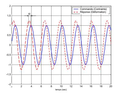
Fig. III.29: Signaux Commande-Réponse Déphasé
