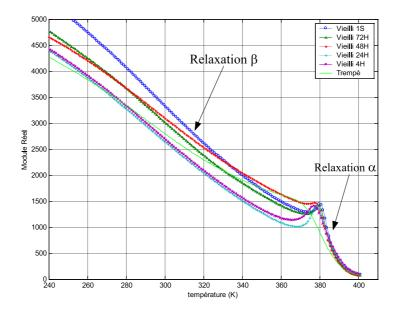
FIG. II.24: Variation du module réel en fonction de la température d'un PMMA vieilli à la temperature T=363K sollicité à une fréquence F=3,33Hz
