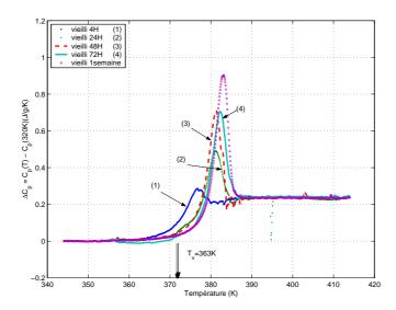
Fig. II.9: Variation de la chaleur spécifique  $\Delta C_p$  en fonction de la température (q=5K/min) d'un PMMA vieilli à une température de 363K pour un temps de vieillissement égal à 4H, 24H,48H, 72H et une semaine
