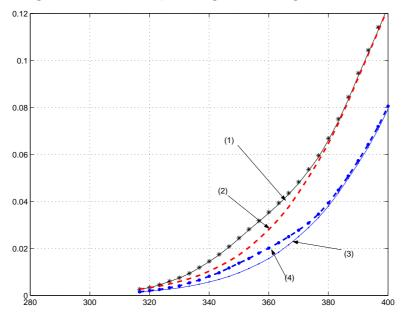
FIG. III.34: tan(φ) d'un PMMA vieilli 72 heures à 313K, (1) F= 0,3Hz avec prise en compte de non linéarité, - F=0,3Hz sans prise en compte de non linéarité, (3) F=1Hz sans prise en compte de non linéarité, (4) F=1Hz avec prise en compte de non linéarité.
