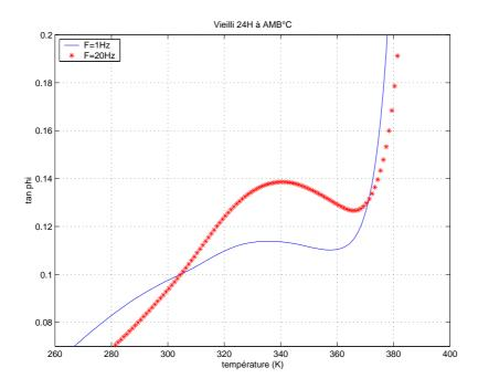
FIG. IV.4: Mesures isochrones à 20 (\*) et 1 (-) Hz de  $tan\varphi$  d'un PMMA vieilli 24H à l'ambiante
