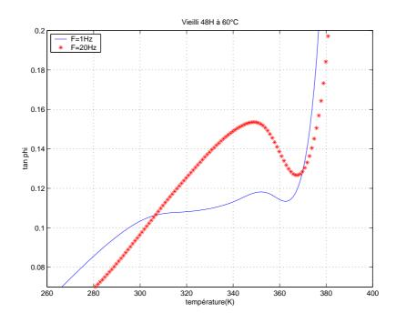
FIG. IV.26: Mesures isochrones à 20 (\*) et 1 (-) Hz de  $tan\varphi$  d'un PMMA vieilli 48H à 333 K
