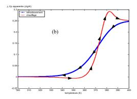
FIG. III.5: Chaleur spécifique apparente (vitesse de refroidissement et de chauffage : (a) = 5K/min, (b) = 10K/min.
