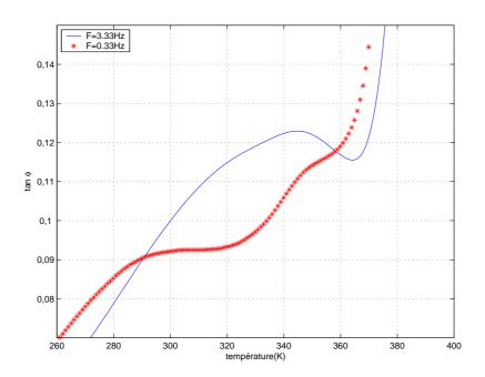
FIG. IV.17: Mesures isochrones à 0,33 (\*) et 3,33 (-) Hz de  $tan\varphi$  d'un PMMA vieilli 72H à 313 K
