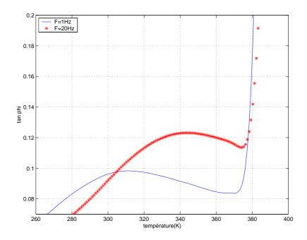
FIG. IV.36: Mesures isochrones à 20 (\*) et 1 (-) Hz de  $tan\varphi$  d'un PMMA vieilli 48H à 363 K
