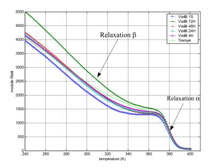
Fig. II.12: Variation du module réel en fonction de la température d'un PMMA vieilli à la temperature ambiante sollicité à une fréquence F=0.33Hz
