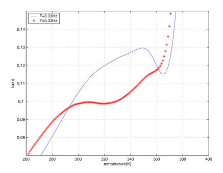
FIG. IV.25: Mesures isochrones à 0,33 (\*) et 3,33 (-) Hz de  $tan\varphi$  d'un PMMA vieilli 48H à 333 K
