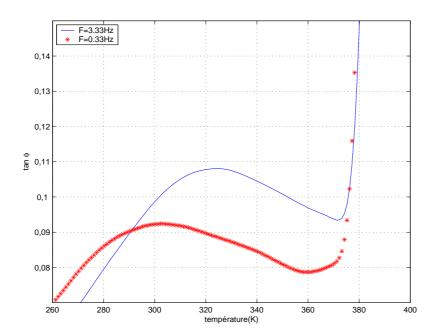
FIG. IV.35: Mesures isochrones à 0,33 (\*) et 3,33 (-) Hz de  $tan\varphi$  d'un PMMA vieilli 48H à 363 K
