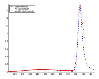
FIG. III.32: principe de la modélisation de  $tan(\varphi)$  séparation de deux relaxation
