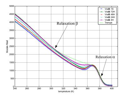
FIG. II.18: Variation du module réel en fonction de la température d'un PMMA vieilli à la temperature T=333K sollicité à une fréquence F=0,33Hz
