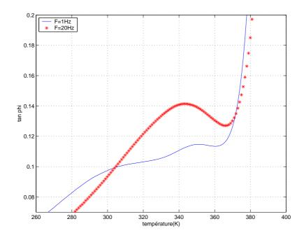
Fig. IV.18: Mesures isochrones à 20 (\*) et 1 (-) Hz de  $tan\varphi$  d'un PMMA vieilli 72H à 313 K
