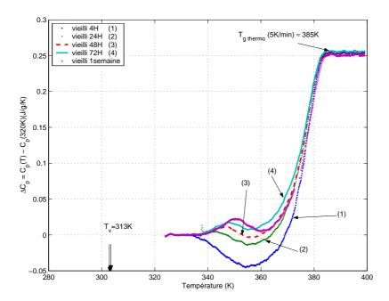
Fig. II.7: Variation de la chaleur spécifique  $\Delta C_p$  en fonction de la température (q=5K/min) d'un PMMA vieilli à une température de 313K pour un temps de vieillissement égal à 4H, 24H, 72H et une semaine
