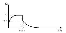
FIG. I.4: Relaxation de la propriété P(t) après un palier de sollicitation.  $P(t) = déformation \ \varepsilon(t)$ , Sollicitation = contrainte  $\sigma(t)$
