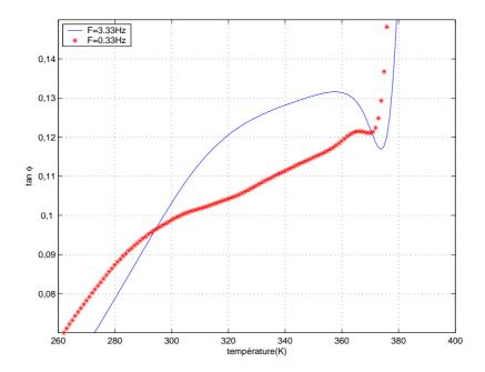
FIG. IV.31: Mesures isochrones à 0,33 (\*) et 3,33 (-) Hz de  $tan\varphi$  d'un PMMA vieilli 4H à 363 k
