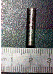
Figure IV. 1-2 : Echantillon cylindrique avant trempage
