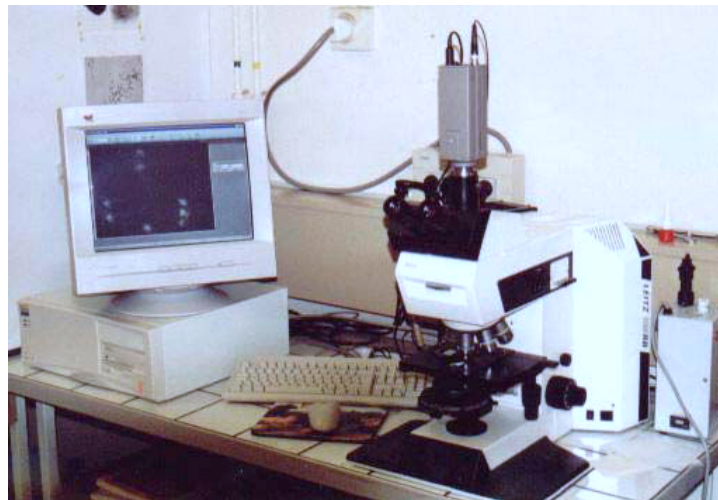
Figure 10: Photographie du dispositif de prise d'images (microscope, caméra et PC).
