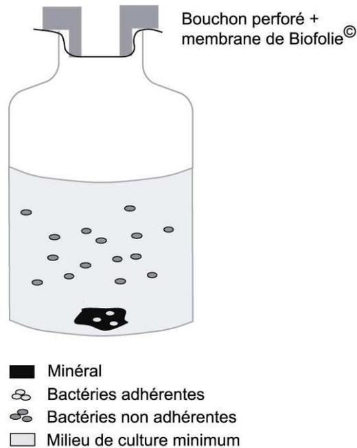
**Figure C2. 3 : Dispositifs de bio-oxydation en réacteur**
