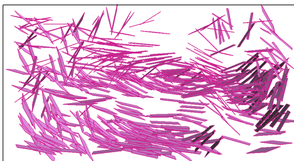
(g) Réseau R_3 (548 fractures)
