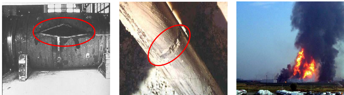
Figure 2 : Exemple de réservoirs sous pression contenant une fissure axiale et circonférentielle : photo de la catastrophe de la zone industrielle de Ghislenghien [3].
