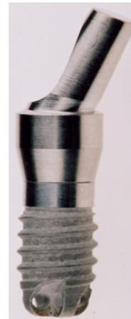
Pour les essais expérimentaux, l'implant a été collé à l'aide d'une résine époxy (de module d'élasticité supérieur à 3 GPa), dans un cylindre en acier. Il a été fixé à une distance de 3 mm du sommet du cylindre afin de se placer dans les conditions les plus défavorables et anticiper la résorption osseuse qui est de l'ordre de 1 mm la première année après la pose de l'implant.
