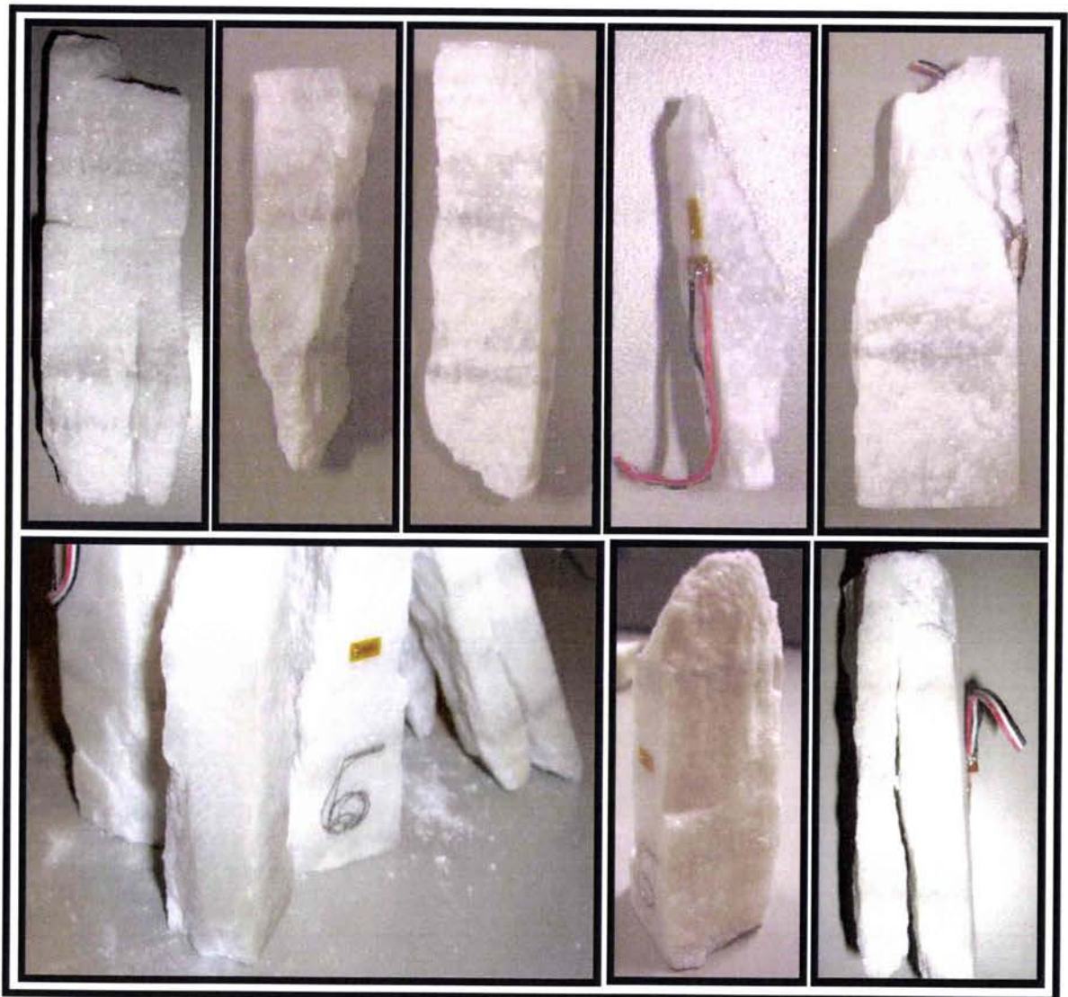
Figure 3.62 : Rupture en clivage axial de l'échantillon V3'aa.
