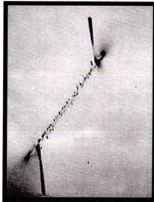
Figure 1.65 : Propagation de fissure à partir d'une fissure fermée dans la glace. D'après [Brace et Bieniawski 1965]
