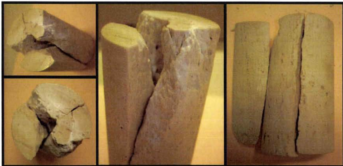
Figure 3.27: Rupture à 120° de l'échantillon pris du Bloc A dans le cas de l'essai sans protection
