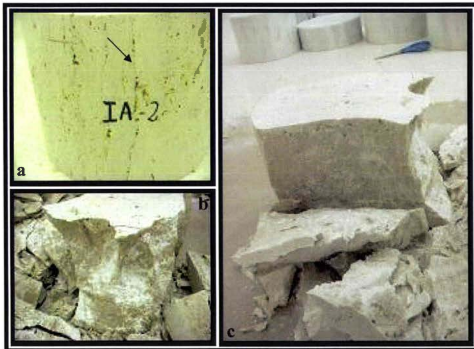
Figure 3.11: Rupture en cône dans le cas de l'échantillon I-A2 d'élancement 0,7.
