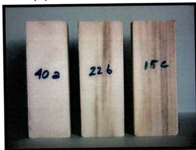
Figure 1.2 : Trois niveaux (a, b, c) de densité de bandes grises dans le Blanco de Macael d'après [Rodríguez-Gordillo 2005]
