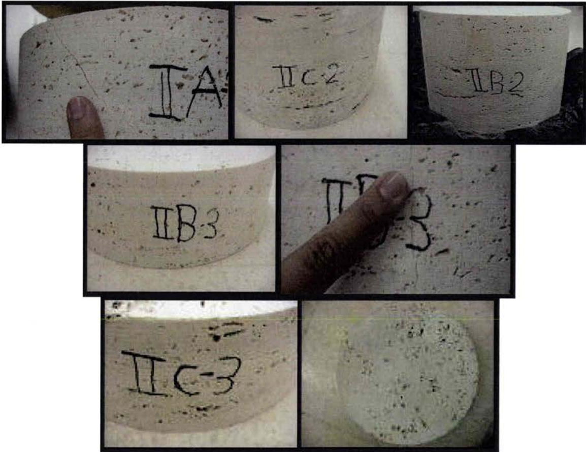
Figure 3.20 : Photos des échantillons avec élancement de 0,7 et 0,4.
