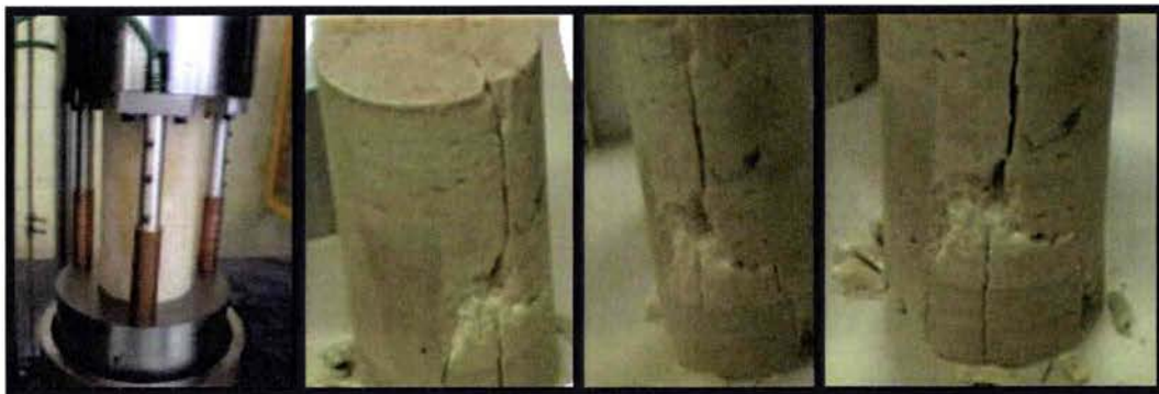
Figure 3.29 : Rupture de l'échantillon C sans protection suite à la propagation de la fissure activée par l'intrusion du lubrifiant sur un côté.
