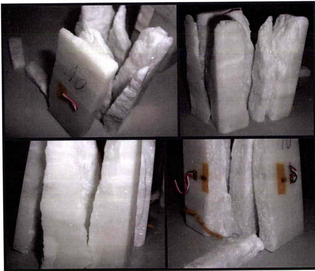
Figure 3.61 : Rupture en clivage axial de l'échantillon V3'as.
