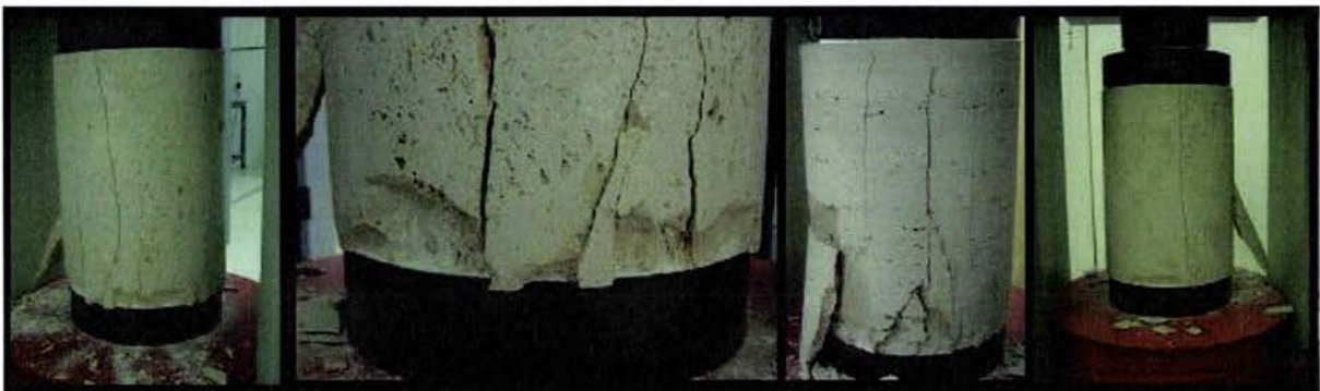
Figure 3.5 : Endommagement des bords des échantillons et écaillage des faces non sollicitées suite à la déformation radiale.
