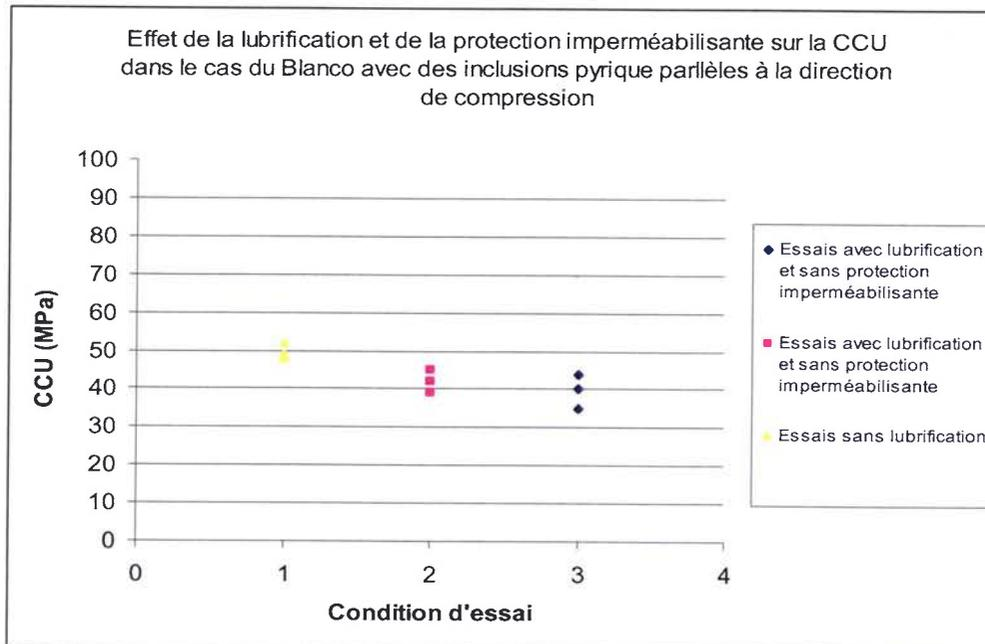
Figure 3.59 : CCU dans les trois conditions d'essais.
