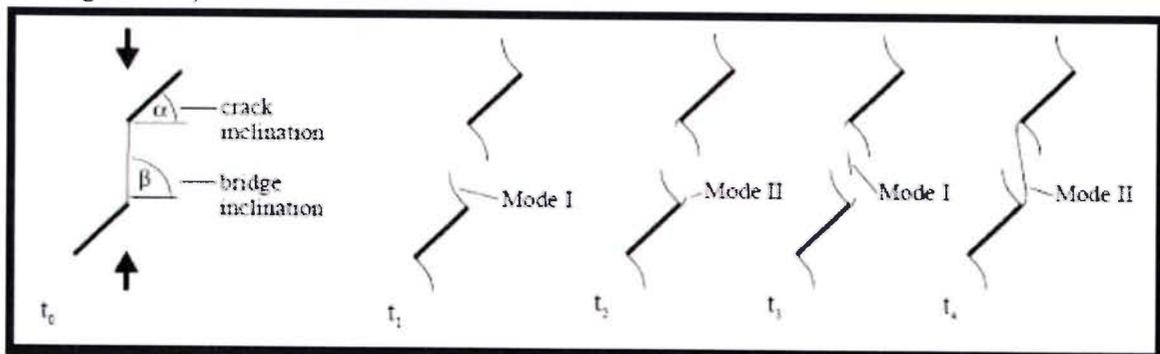
Figure 1.74 : Géométrie et développement de la fissuration avec l'augmentation du chargement. A  $t_1$  : développement des fissures en ailes en mode I,  $t_2$  : initiation des fissures secondaires en mode II,  $t_3$  : ouverture de fissure entre les deux fissures en aile et en  $t_4$  : les fissures sont connectées en mode II. D'après [Shen 1995 modifié par Backers et al 2002]
