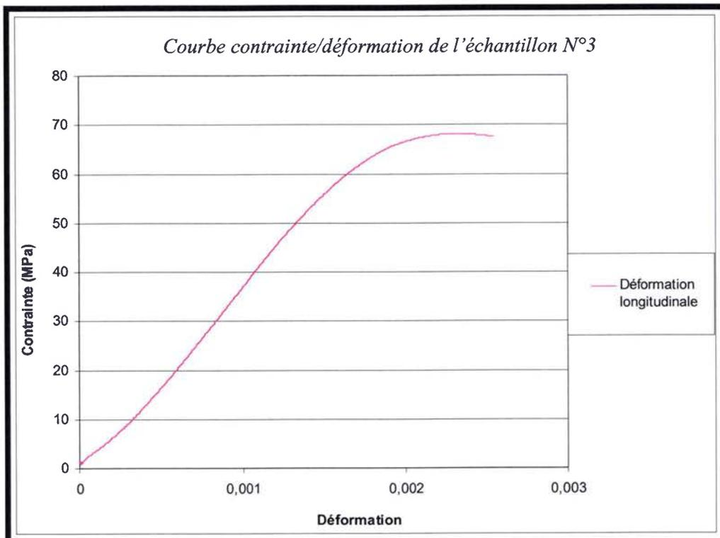
Figure 5.37 : Courbe contrainte/déformation de l'échantillon 3 de classe 3.
