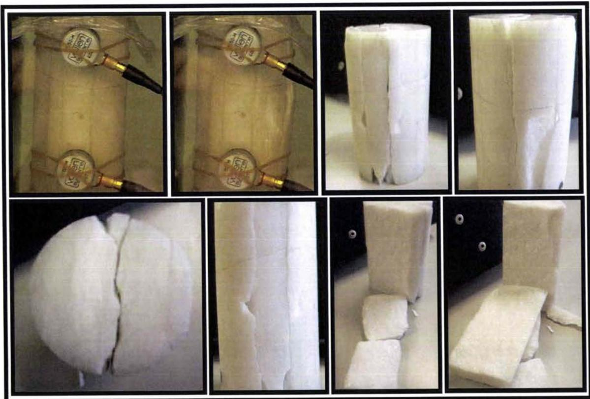
Figure 3.58 : Rupture en clivage axial de l'échantillon V-B3'aa.
