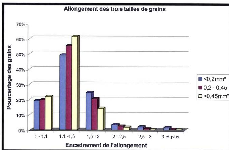
Figure 4.22 : Distribution des allongements des trois tailles de grains de calcite.
