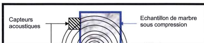
Figure 5.1 : Principe de la méthode de détection des émissions acoustiques.
