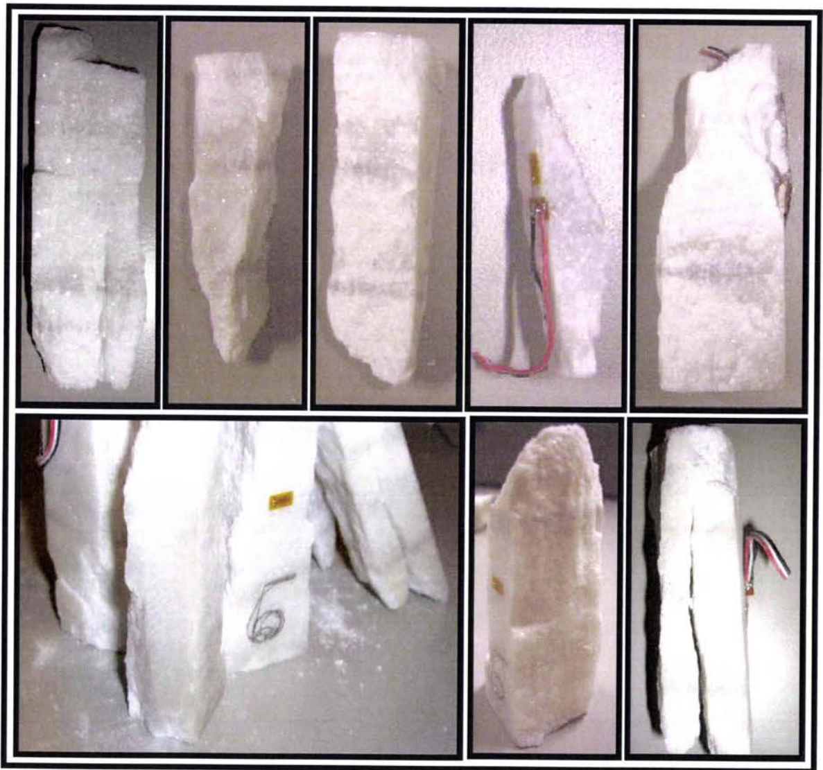
Figure 3.62 : Rupture en clivage axial de l'échantillon V3'aa.
