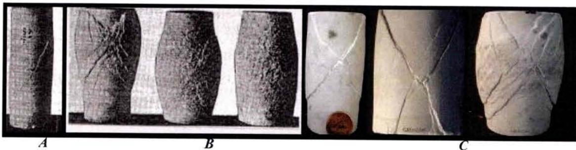
Figure 1.11 : A : échantillons de marbre de Wombeyan (porosité 0-5%) :  $P_{\text{confinement}} 9,81 \text{ MPa}$ , 2% déf., B : échantillons de marbre de Wombeyan : Échantillon de gauche:  $P_{\text{confinement}} 27,46 \text{ MPa}$ , 20% déf., Échantillon du milieu:  $P_{\text{confinement}} 45,1 \text{ MPa}$ , 20% déf., Échantillon de droite:  $P_{\text{confinement}} 98,1 \text{ MPa}$ , 20% déf.). D'après [Paterson, 1958]. C : échantillon de marbre de Carrare [Nicollet 2005]
