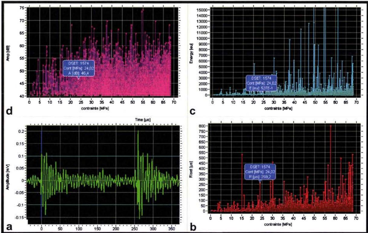
Figure 5.8 : fig.5.8a : Allure de la 1574<sup>ème</sup> (DSET 1574) salve, enregistrée à 24,02 MPa, lors de l'essai de compression de l'échantillon N°9 ; avec un temps de montée important = 259 µs (fig.5.8 b), une énergie = 52,7 eu (fig.5.8c) et une amplitude = 46,4 dB (fig.5.8d).
