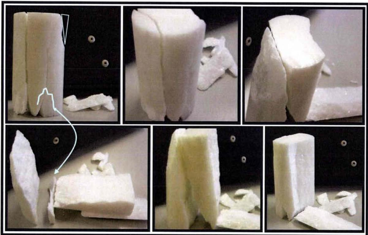
Figure 3.57 : Rupture de l'échantillon V-B1'as en clivage axial
