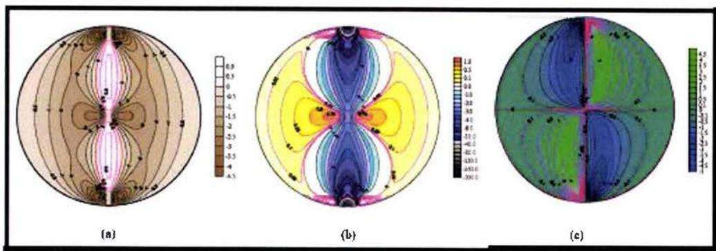
Figure 1.18 : Les découpes des contraintes normalisées pour un disque brésilien sous compression diamétrale, (a) les contraintes tangentielles, (b) les contraintes radiales, (c) les contraintes de cisaillement. D'après [Naser 2005].
