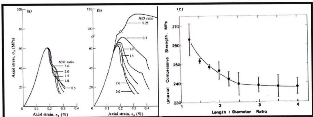
Figure 1.46 : a) Effet de l'élançement sur la courbe contrainte déformation en condition anti-frettés, b) Condition sans système anti-fretage. D'après les essais du marbre de Wombeyan de [Brown et Gonano 1974]. c) Effet de l'élançement sur la contrainte limite en compression en condition frettées du granite de Westerley. D'après [Moggi 1966].
