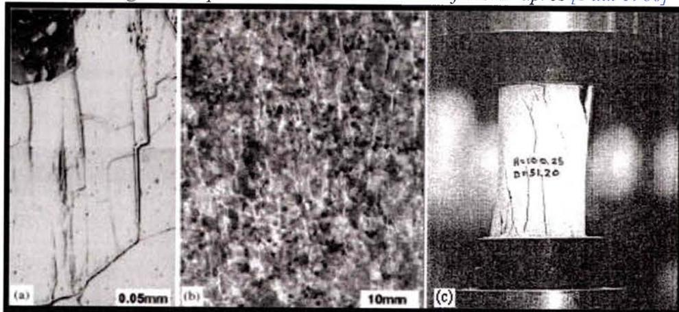
Figure 1.39 : (a) Microfissuration axiale dans le granite de Westerley, d'après [Wong 1982], (b) Fissures axiales dans le granite du lac de Bonnet [Diederichs 2004], (c) Rupture en clivage axial du grès de Berea [Vardoulakis 1998]. Dans les trois cas, la direction de compression est verticale.
