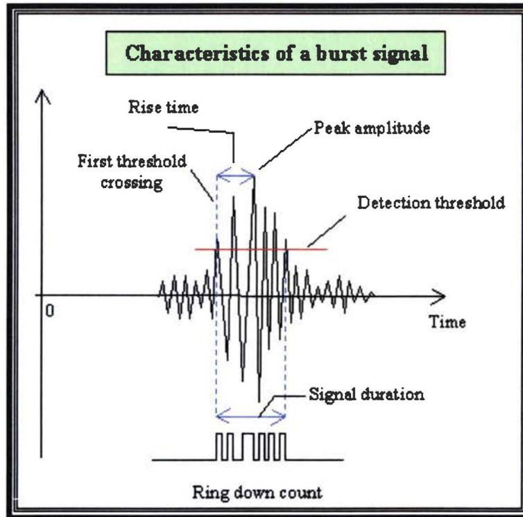
Figure 5.2: Caractéristique d'une salve ou un signal acoustique.
