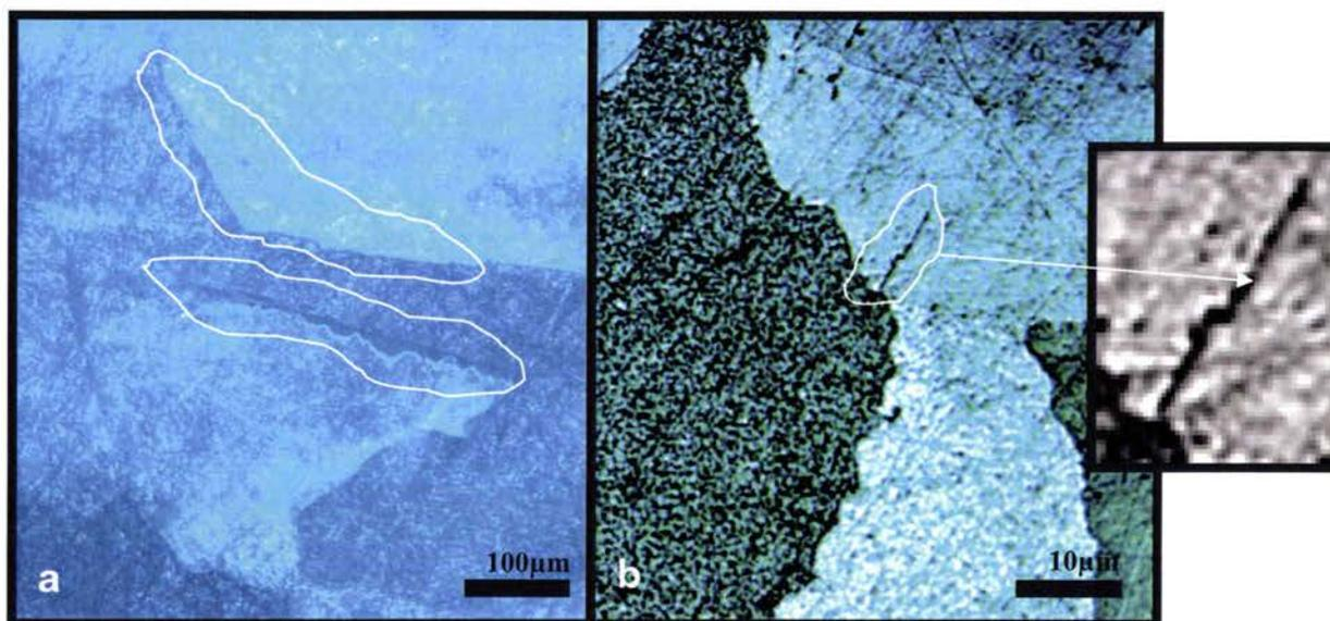
Figure 2.39 : a) fissure intergranulaire. b) fissure intragranulaire.
