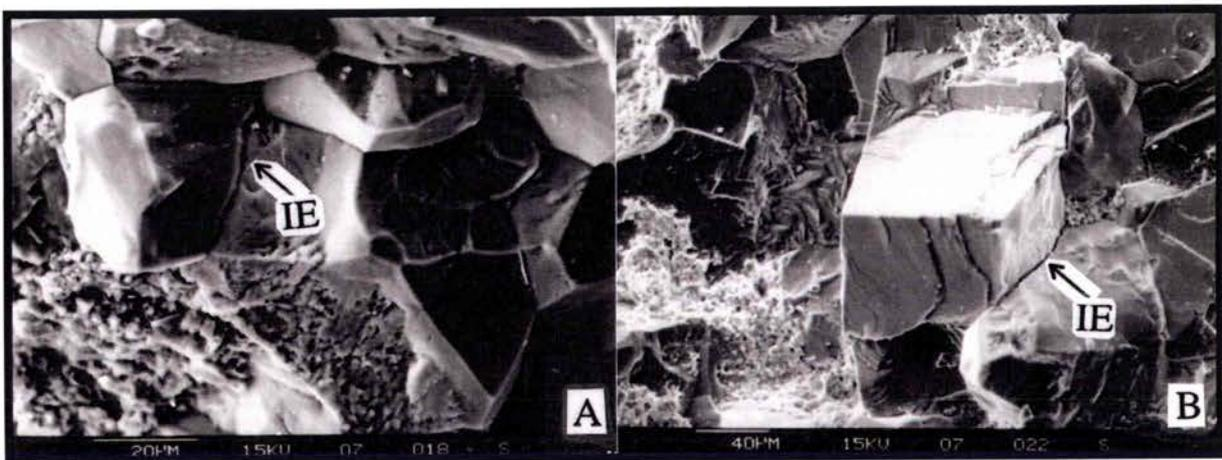
Figure 1.60 : Photos de la de la surface de rupture du marbre de Fangshan sous compression dynamique. On note sur les images a) et b) l'apparition des microfissures au joint de grain « IE ». D'après [Zhang et al 2000]
