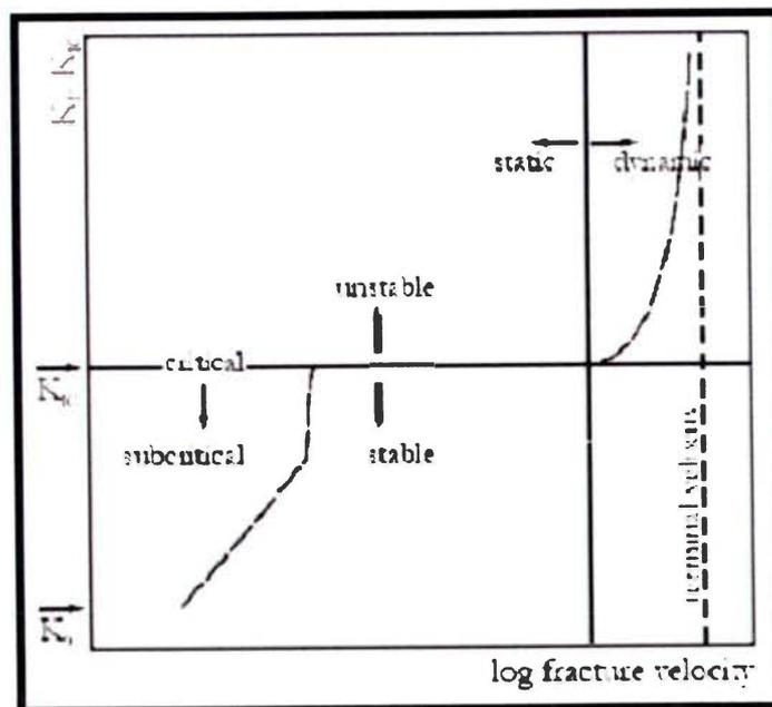
Figure 1.66 : Représentation schématique du facteur d'intensité  $K$  en fonction du logarithme de la vitesse de rupture en mode I, et du régime dynamique & statique en fonction du régime stable & instable.
