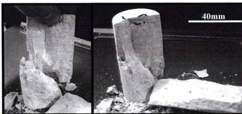
Figure 3.14 : Rupture en mode mixte de l'échantillon I-B'1.
