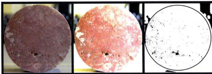
Figure 2.12 : Images de trois étapes du traitement permettant la mise en évidence des vides.
