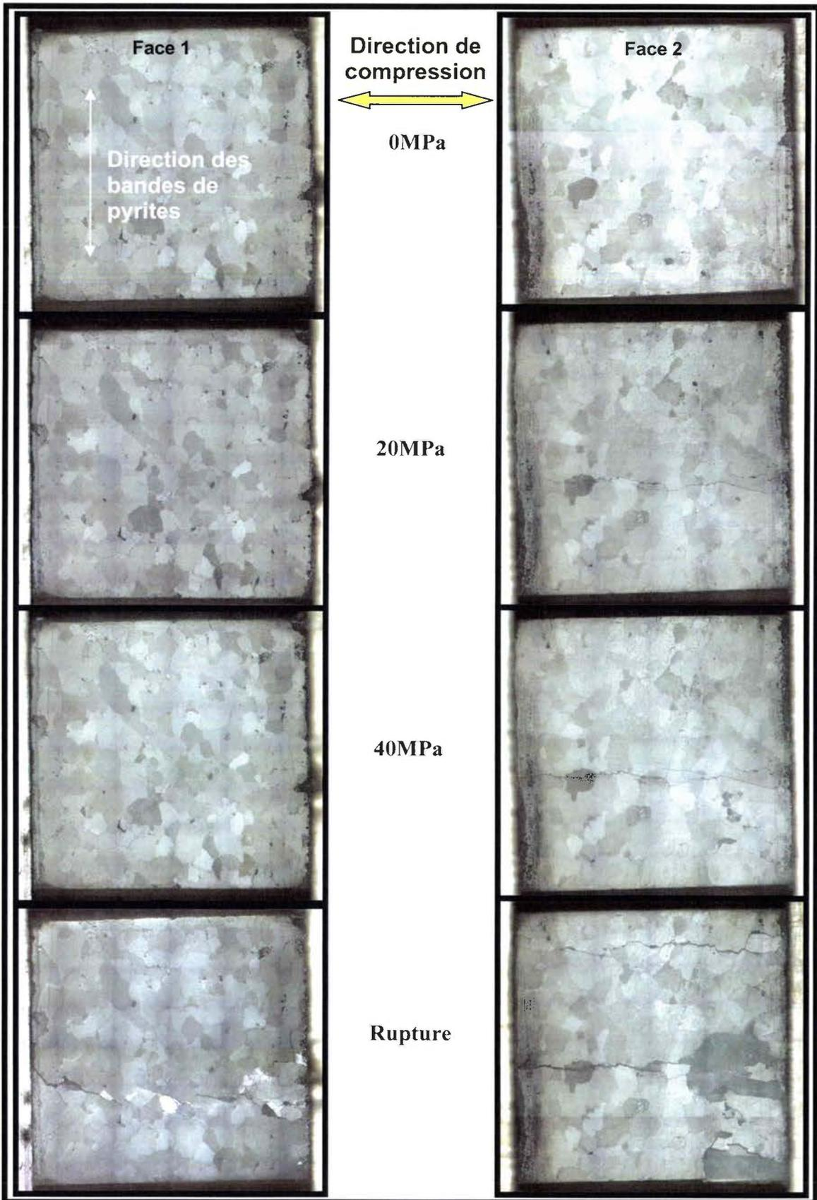
Figure 5.27 : Correspondance entre les deux faces de l'échantillon pendant les quatre phases de l'endommagement. Nous percevons que les grains présentent une morphologie allongée à  $\pm 15^\circ$  dans la direction des bandes de pyrite.
