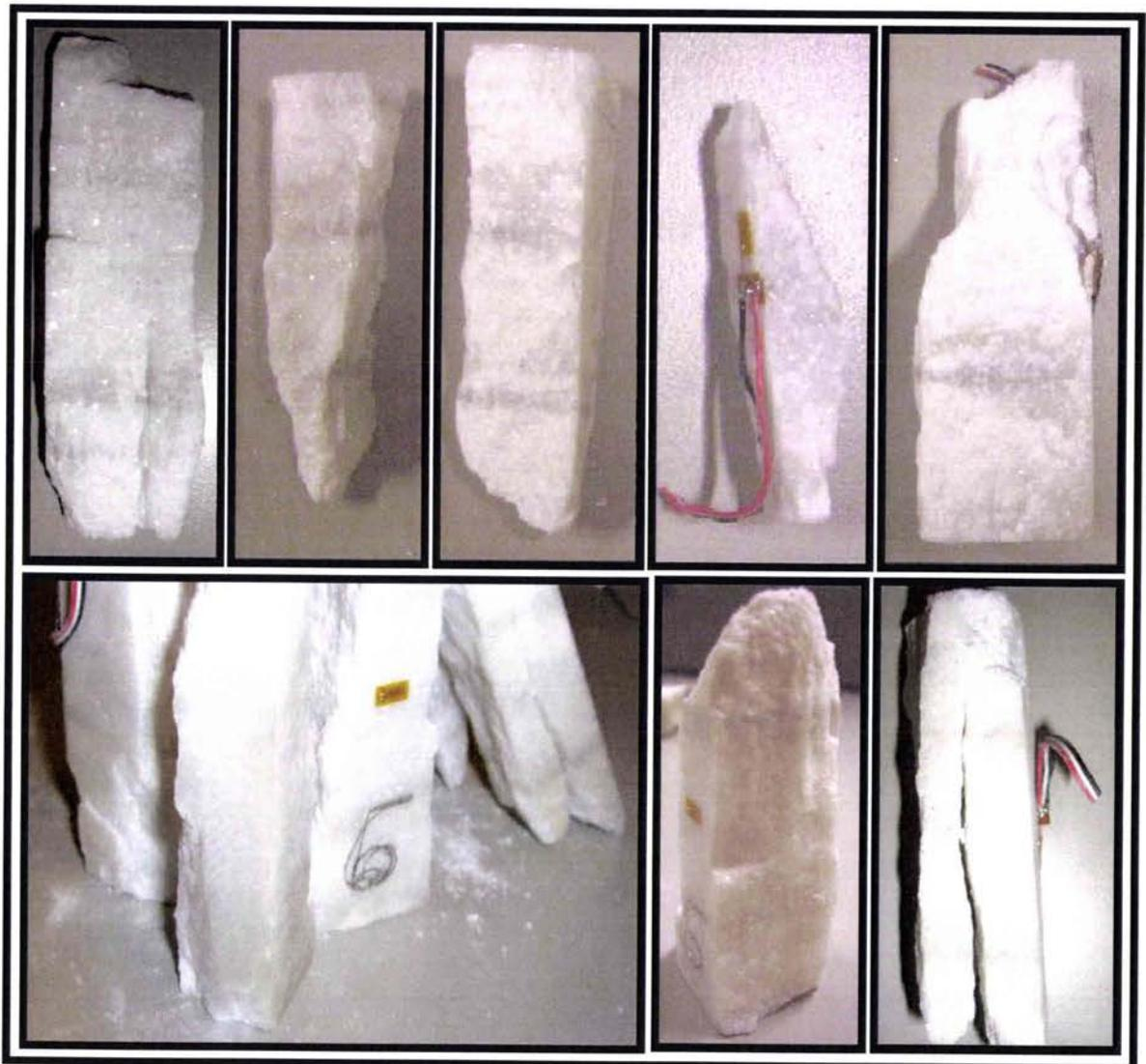
Figure 3.62 : Rupture en clivage axial de l'échantillon V3'aa.
