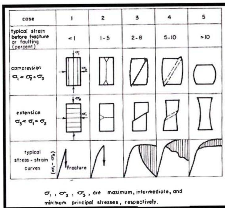
Figure 1.12 : Représentation schématique de la transition de la rupture fragile à l'écoulement ductile, avec des déformations typiques avant la rupture. D'après [Griggs 1960].
