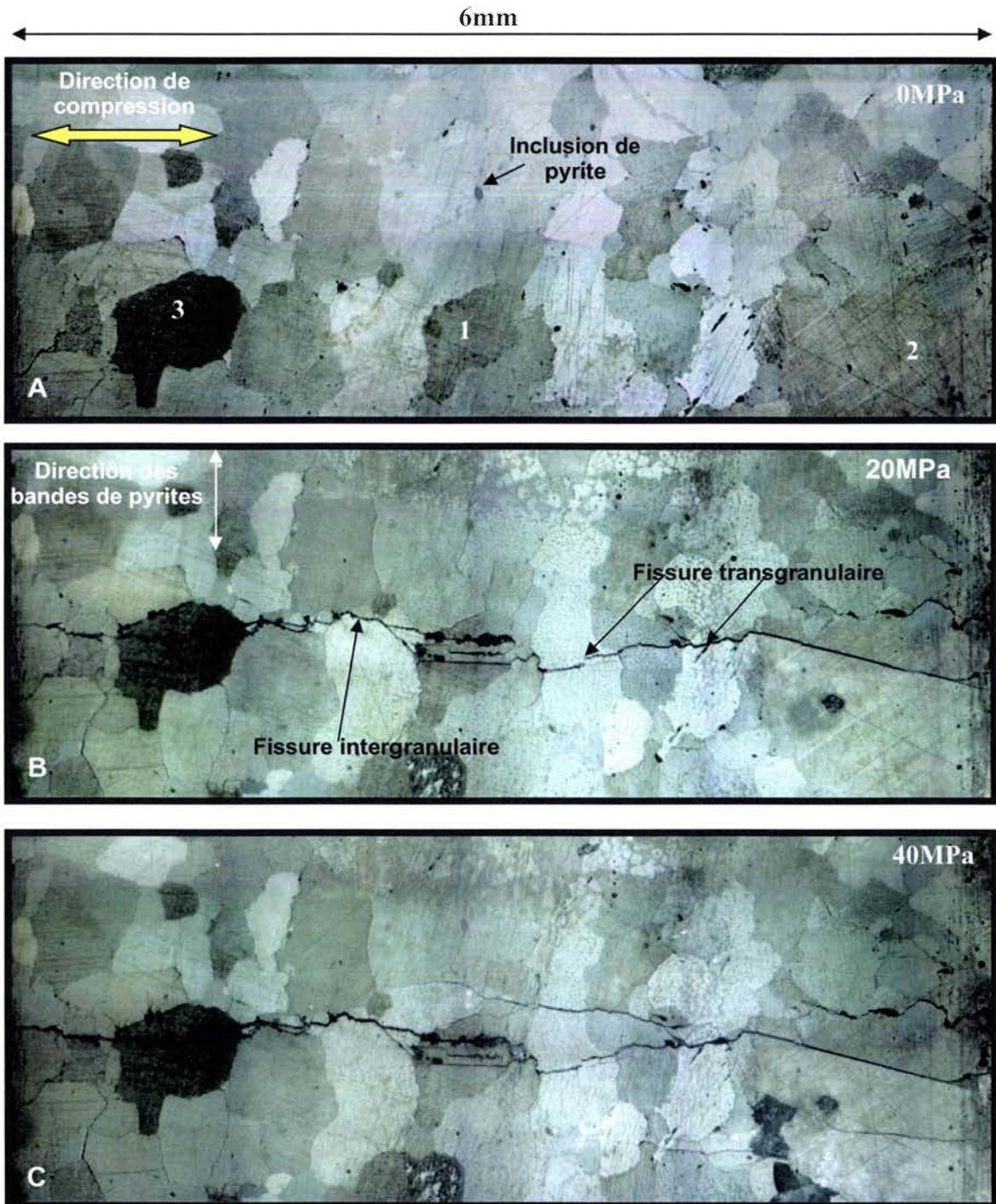
Figure 5.29 : Initiation de l'endommagement par clivage des grains.
