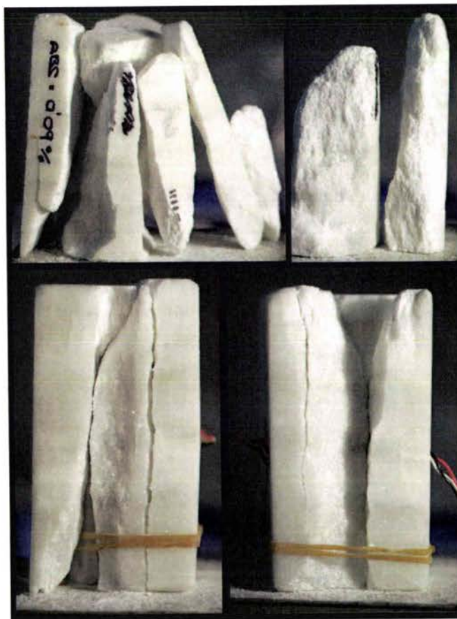
Figure 3.52 : Rupture en mode mixte de l'échantillon V1' en haut et V3' en bas.
