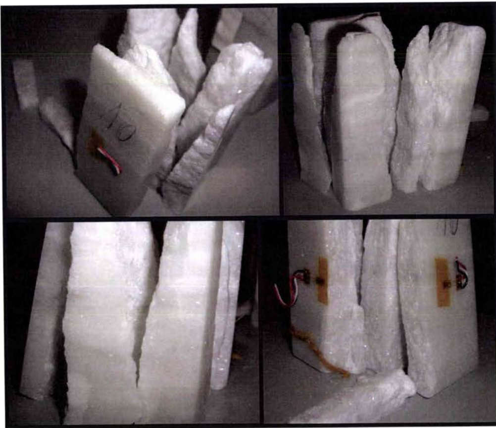
Figure 3.61 : Rupture en clivage axial de l'échantillon V3'as.
