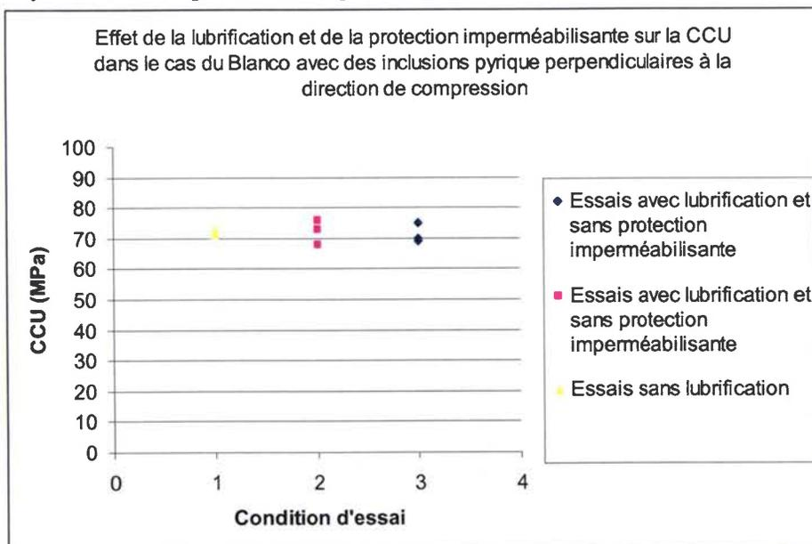
Figure 3.64 : CCU mesurée pour les différentes conditions d'essais.
