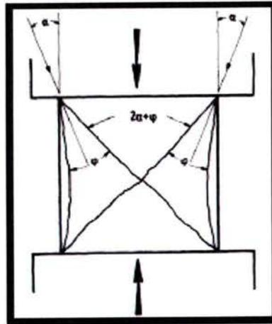
Figure 1.29 : Reproduction de Mohr (1900) : Dessin original du mode de rupture observé sur les roches et les bétons sous compression uniaxiale sans lubrification, et le concept théorique du confinement du au frettage
