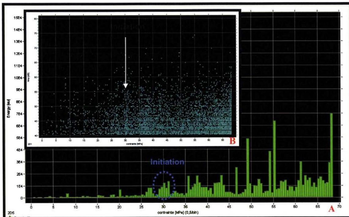
Figure 5.20 : A : Graphique de l'énergie acoustique accumulée sur un intervalle de 0,5MPa en fonction de la contrainte. B : Graphique de l'amplitude des événements en fonction de la contrainte. Ces deux graphiques montrent que la distinction de l'initiation dans le graphique B est aussi justifiée par l'augmentation de la densité des évènements acoustiques, visibles dans le graphique A.
