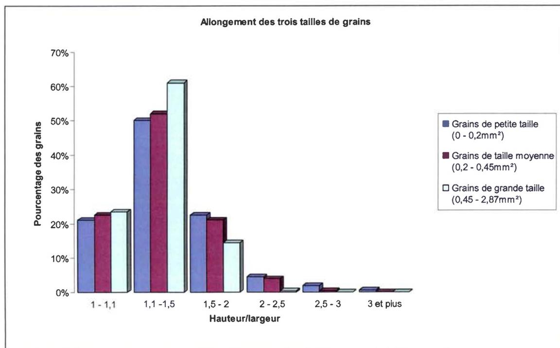
Figure 2.28 : Pourcentage des grains en fonction du facteur de forme ou de l'allongement.
