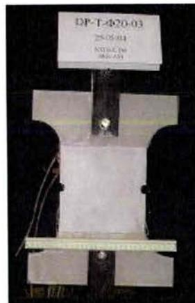
Figure 1.15 : Dispositif expérimental pour un essai de traction sur le marbre de Dionysos, on remarque les plaques de renforts en plexiglas. D'après [Kourkoulis \(2004\)](#).
