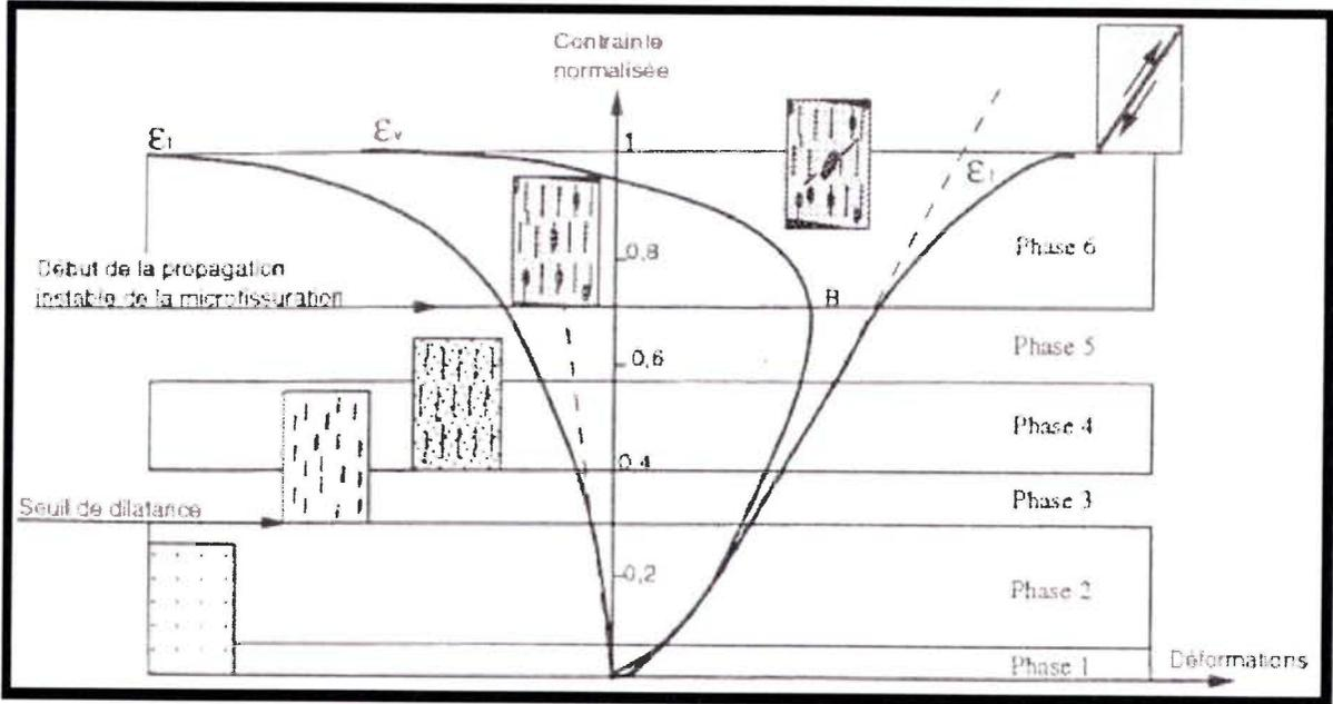
Figure 1.24 : Diagramme contrainte normalisée ( $\sigma_1 - \sigma_3$ ) déformation axiale  $\epsilon_1$ , déformation transversale  $\epsilon_v$ , déformation volumique  $\epsilon_v$ , montrant les éléments de développement de la fissuration, et les phases principales du processus de rupture dans l'essai de compression uniaxiale et triaxiale monotone, d'après [Haied, 1995].
