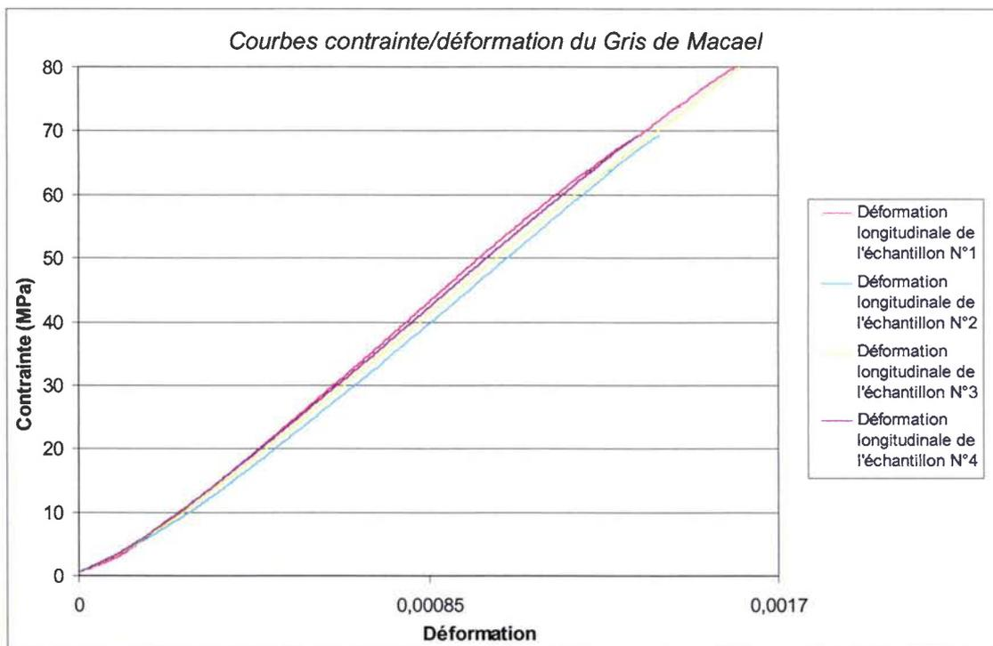
Figure 5.44 : Courbes contraintes déformations des 4 essais effectués sur le gris dans la direction de compression 0°.
