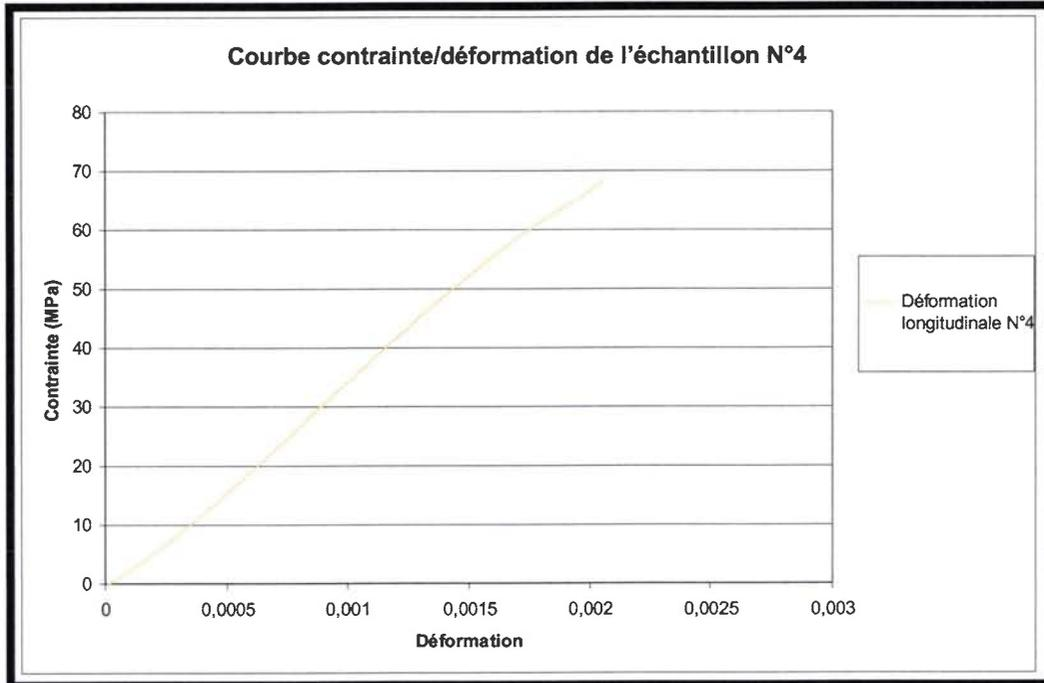
Figure 5.19 : Courbe contrainte/ déformation de l'échantillon N°4.
