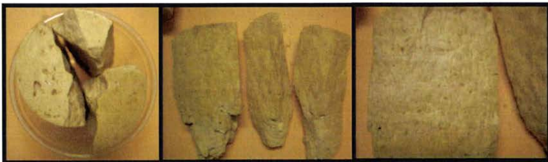
Figure 3.30 : Rupture de l'échantillon extrait du Bloc B sans protection imperméabilisante à 120^\circ et effritement de l'échantillon à sa base aussi du à l'intrusion du lubrifiant.
