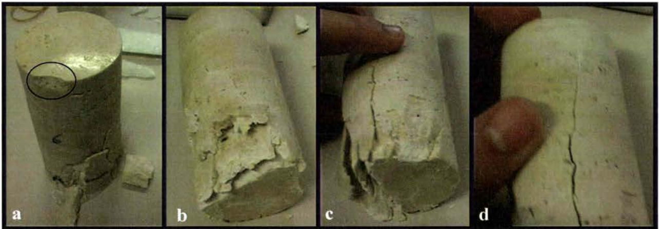
Figure 3.33 : a) Rupture de l'échantillon B sans protection imperméabilisante. On note un écaillage en haut, mais aussi en bas de l'échantillon. b) écaillage en bas de l'échantillon C. c et d) on note l'effet de l'intrusion du lubrifiant en bas de l'échantillon A et la propagation de la fissure.
