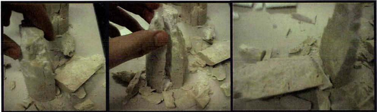
Figure 3.35 : Rupture en clivage axial de l'échantillon extrait du Bloc A avec protection imperméabilisante.
