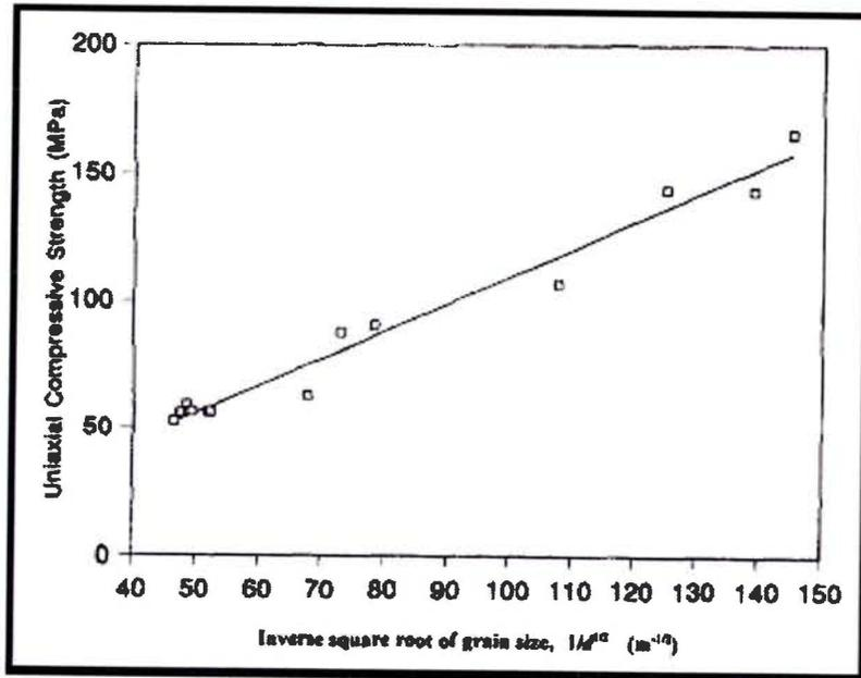
Figure 1.7: Résistance à la compression uniaxiale en MPa des marbres étudiés par [Brace 1961, Olsson 1974, Fredrich 1990] en fonction de l'inverse de la racine carré des tailles de grain  $m^{-1/2}$ . [Robina 1996]
