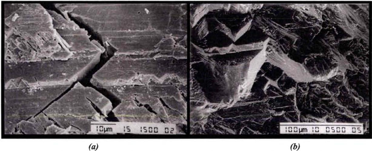
Figure 1.55 : (a) Fissure intragranulaire due au clivage de la calcite dans le marbre de Dyonisos sous compression uniaxiale cyclique. (b) Rupture par clivage du marbre de Lorano .
