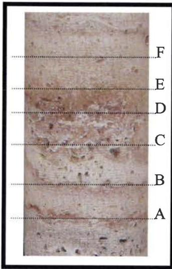
Afin de caractériser l'architecture interne, plusieurs mesures ont été effectuées. La première consiste en la détermination de la porosité apparente (6%), de l'absorption d'eau (1,8%) et de la densité ( $2,6 \text{ g/cm}^3$ ), ces mesures ont été effectuées au CTAP selon la norme [EN 1936 et EN 1925].
