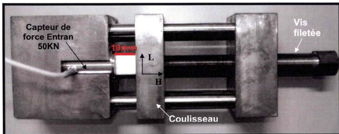
Figure 5.26 : Photo du dispositif expérimental utilisé pour l'observation sous microscope. Système vis filetée (pas très fin de 0,3mm) et coulisseau. Le capteur de force est directement relié à un voltmètre pour la lecture de la valeur de la force.
