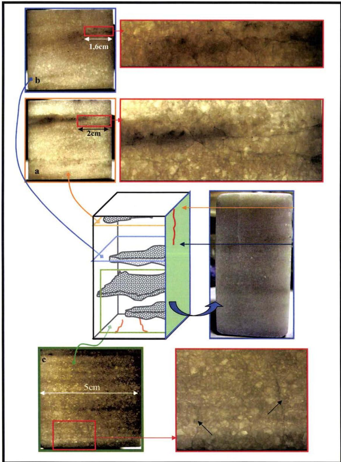
Figure 5.21 : Observation de l'endommagement de l'échantillon N°4.
