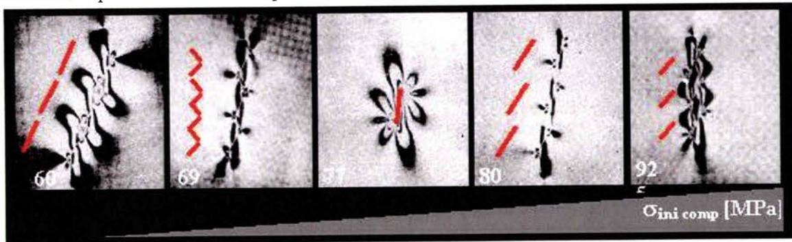
Figure 1.75 : Effet des différentes configurations de fissures sur la contrainte d'initiation en compression  $\sigma_{ini\ comp}$ . D'après [Hoek et Bieniawski 1965].
