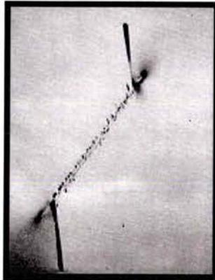
*Figure 1.65 : Propagation de fissure à partir d'une fissure fermée dans la glace.
