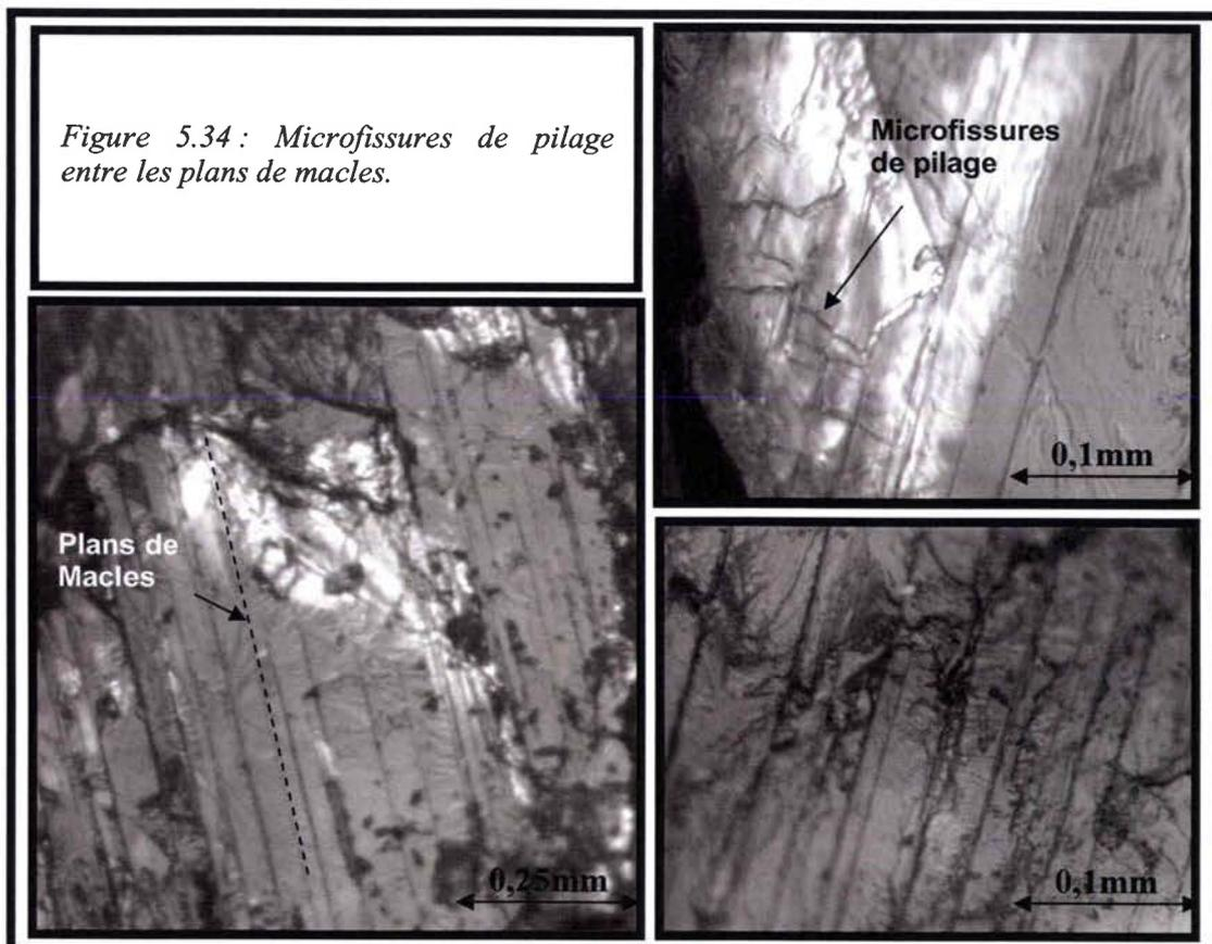
Ceci étant, l'instant de l'activation n'a pas pu être perçu à cette échelle. Par contre, nous avons toujours observé à la rupture plusieurs séparations suivant des plans de macles, sur des grains qui n'étaient pas maclés au début du chargement (Figure 5.34).
