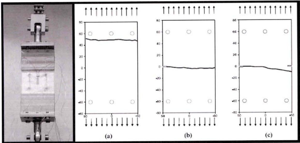
Figure 1.14 : À gauche dispositif expérimental, a) rupture sur un échantillon sans entaille, b) rupture avec une entaille, c) rupture sur un échantillon avec double entaille.
