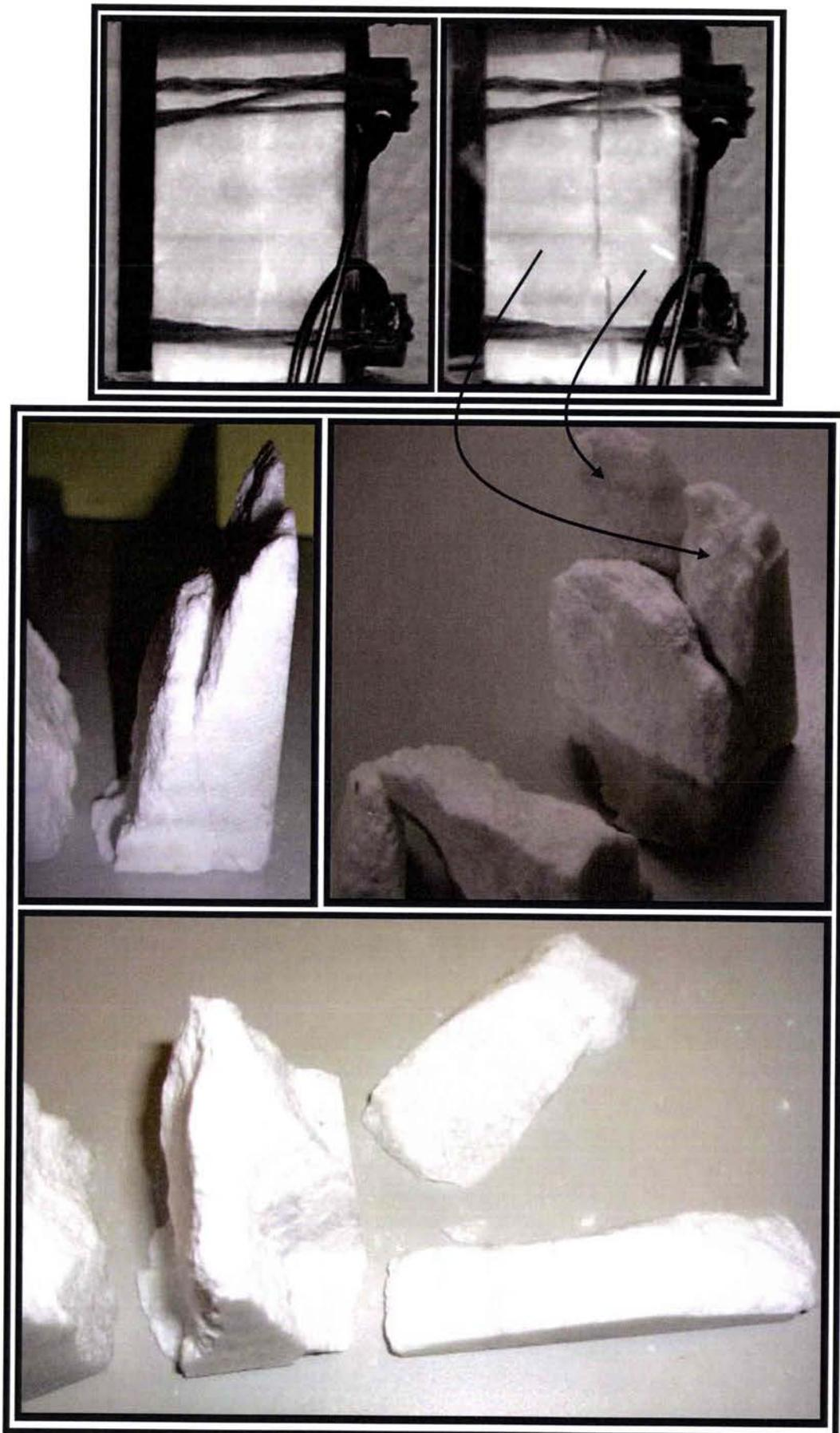
Figure 3.53 : Rupture en mode mixte de l'échantillon V2'.
