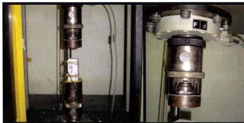
Figure 3.4 : Photos de la machine de traction compression du LFM utilisée pour les essais de compression. À droite image du capteur de force.
