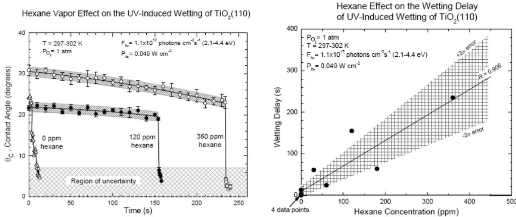
**Figure 11 :** Mesure d'angle de contact sur une surface de TiO<sub>2</sub> exposée à des concentrations variables en Hexane (ZUB, 2005).
