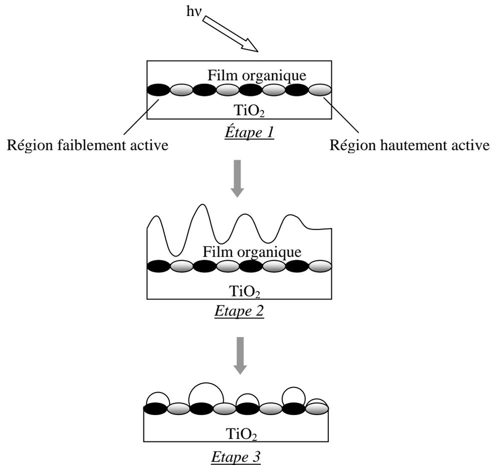
**Figure 15 :** Schémas de la photodécomposition de couches d'acide stéarique déposées par L-B sur un film de  $\text{TiO}_2$  mettant en évidence l'existence de régions plus réactives que d'autres (SAW, 1997)
