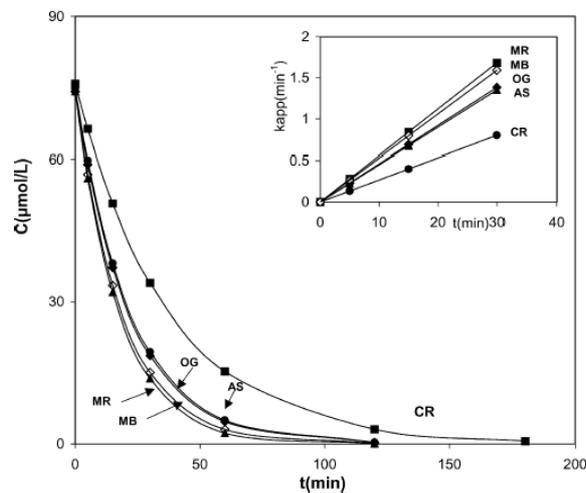
**Figure 3 :** Exemple de la cinétique de dégradation de colorants par  $\text{TiO}_2$  en suspension : Bleu de méthylène (MB), Orange G (OG), Alizarine S (AS), Méthylène rouge azoté (MR), Congo rouge (CR) (GUI, 2003)
