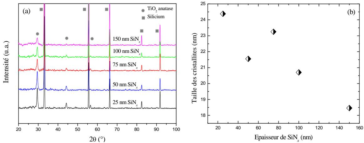
**Figure 56 :** (a) spectres DRX des films TiO<sub>2</sub> déposés sur différentes épaisseurs de SiN<sub>x</sub> et (b) évolution de la taille des cristallites de TiO<sub>2</sub> en fonction de l'épaisseur de la barrière de diffusion
