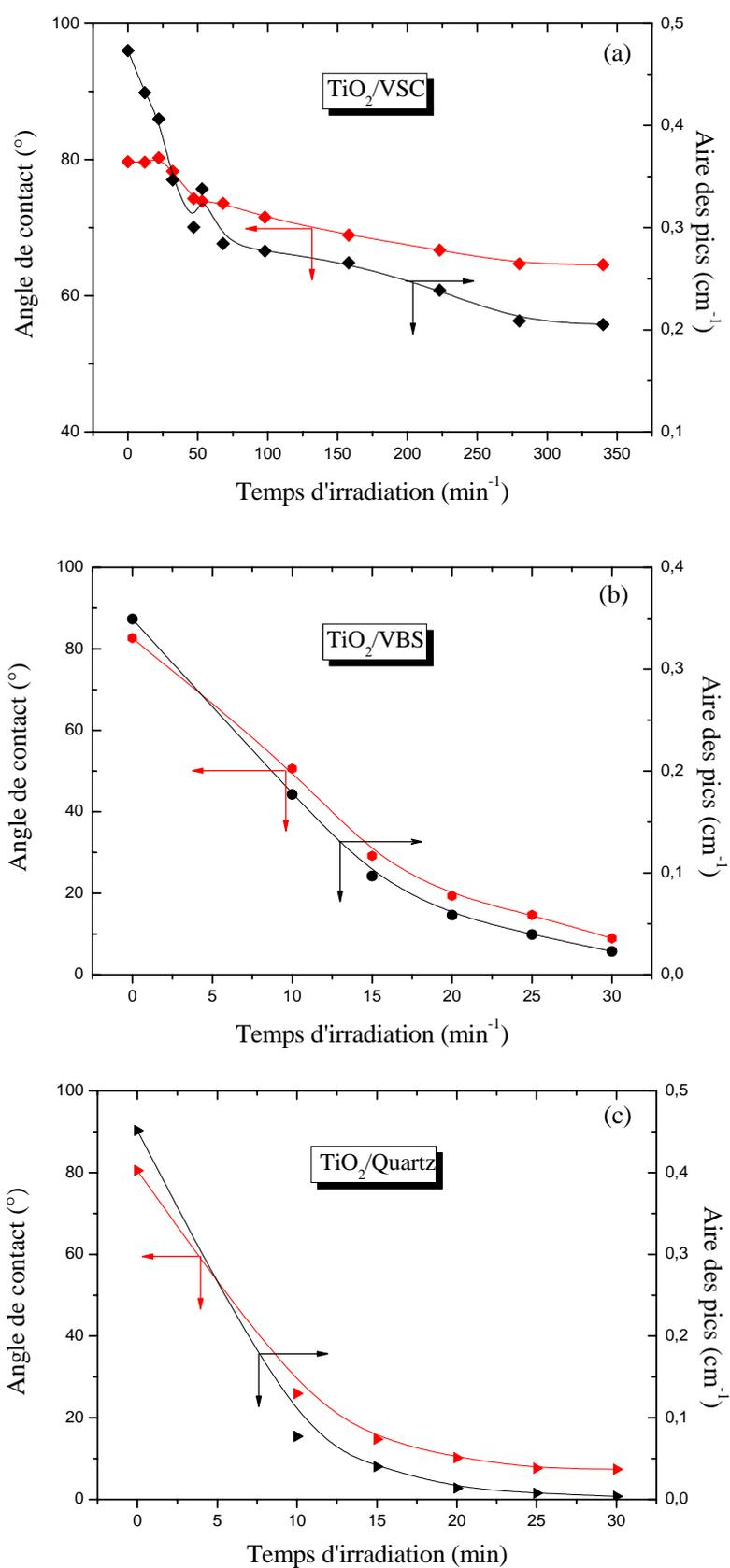
**Figure 59 :** Angle de contact et aire des pics IR de l'AS en fonction du temps d'irradiation pour (a) TiO<sub>2</sub>/VSC (b) TiO<sub>2</sub>/VBS et (c) TiO<sub>2</sub>/Quartz
