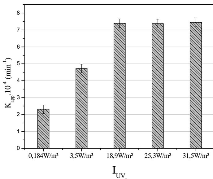
**Figure 50 :** Évolution de la cinétique de dégradation de l'OII en fonction de l'éclairement de la lampe, avec TiO<sub>2</sub>/VSC, pH naturel, [OII]=10 mg/l et d=33 ml.min<sup>-1</sup>
