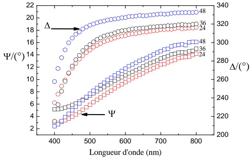
**Figure 35 :** Données expérimentales d'ellipsométrie spectroscopique basé sur le modèle décrit dans la figure 17 pour des films TiO<sub>2</sub>/VSC préparé avec un nombre de cycles de dip-coating croissant (24, 36, 48)
