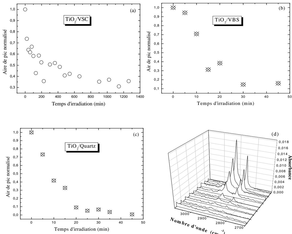
**Figure 52** : Évolution de l'air normalisé des pics de l'acide stéarique en fonction du temps d'illumination pour (a) TiO<sub>2</sub>/VSC, (b) TiO<sub>2</sub>/VBS, (c) TiO<sub>2</sub>/Quartz et (d) du spectre d'absorbance IR-TF de la dégradation de l'AS pour TiO<sub>2</sub>/Quartz
