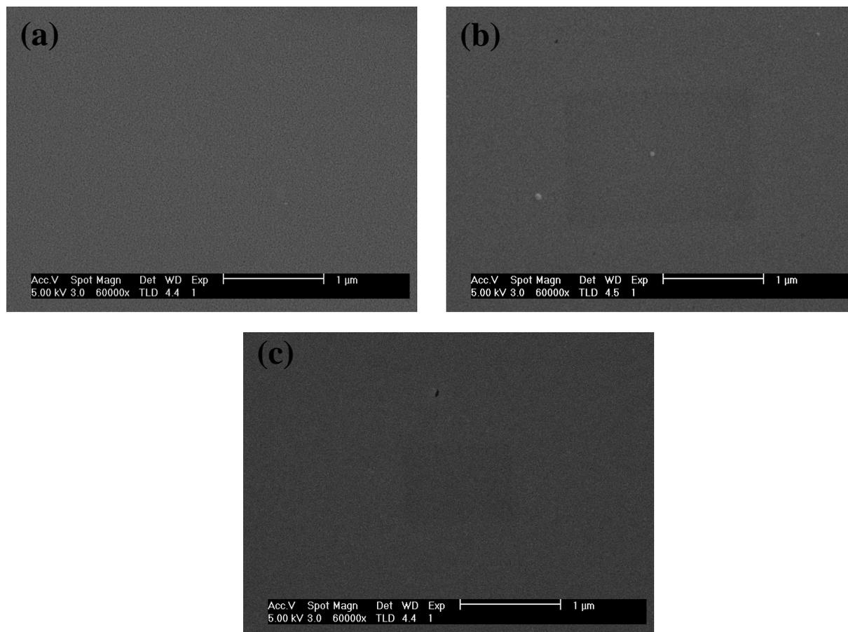
**Figure 55 :** Photos MEB de films de TiO<sub>2</sub> déposés sur des barrières de diffusion d'épaisseur (a) 25 nm, (b) 75 nm et (c) 150 nm
