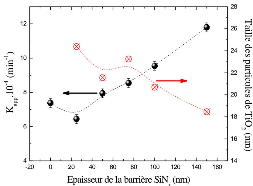
**Figure 57 :** Évolution de la constante apparente,  $K_{app}$ , de dégradation de l'OII en fonction de l'épaisseur de SiN<sub>x</sub> après traitement thermique à 450°C
