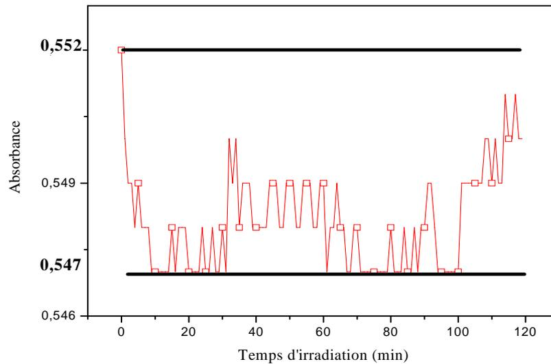
**Figure 40 :** Test de photolyse de l'Orange II
