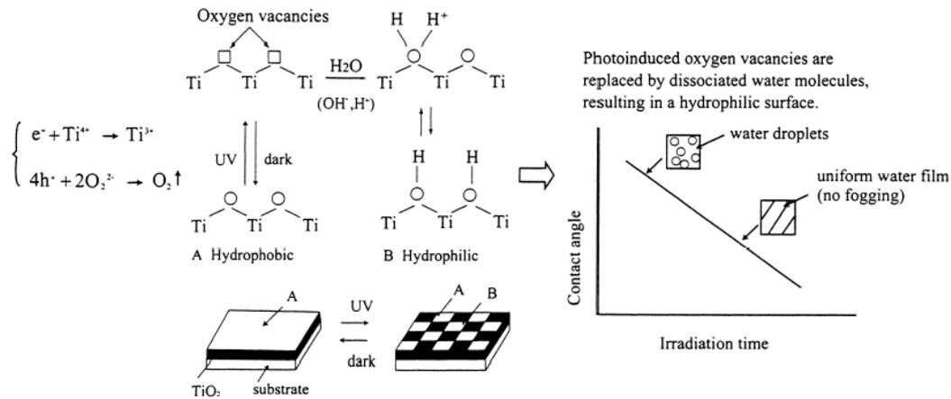
**Figure 9** : Mécanisme de super-hydrophilie photoinduite (FUJ, 2000)
