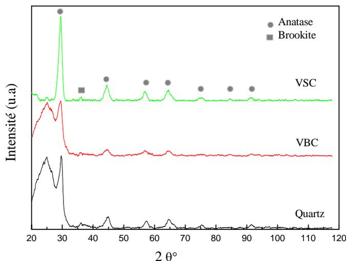
**Figure 30 :** Spectre DRX de couches minces de TiO<sub>2</sub> déposé sur trois supports différents
