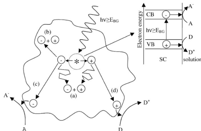
**Figure 2 :** Schéma illustrant des processus majeurs se produisant lors de l'excitation d'un semi-conducteur par une énergie  $h\nu > E_{BG}$ . La paire  $e^-/h^+$  créée peut : (a) se recombiner au cœur de la particule ou (b) à la surface, (c) réduire les molécules 'A' adsorbées à la surface ou (d) les oxyder (MIL, 2002b).
