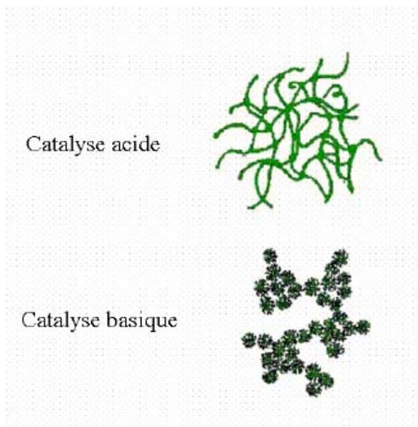
**Figure 18 :** Différents assemblages possibles des amas polymériques suivant le type de catalyse. Une catalyse acide, favorisant l'hydrolyse, conduit à la formation d'amas longitudinaux ; au contraire, une augmentation de la condensation générée par une catalyse basique, mène à des amas caractérisés par une forme sphérique
