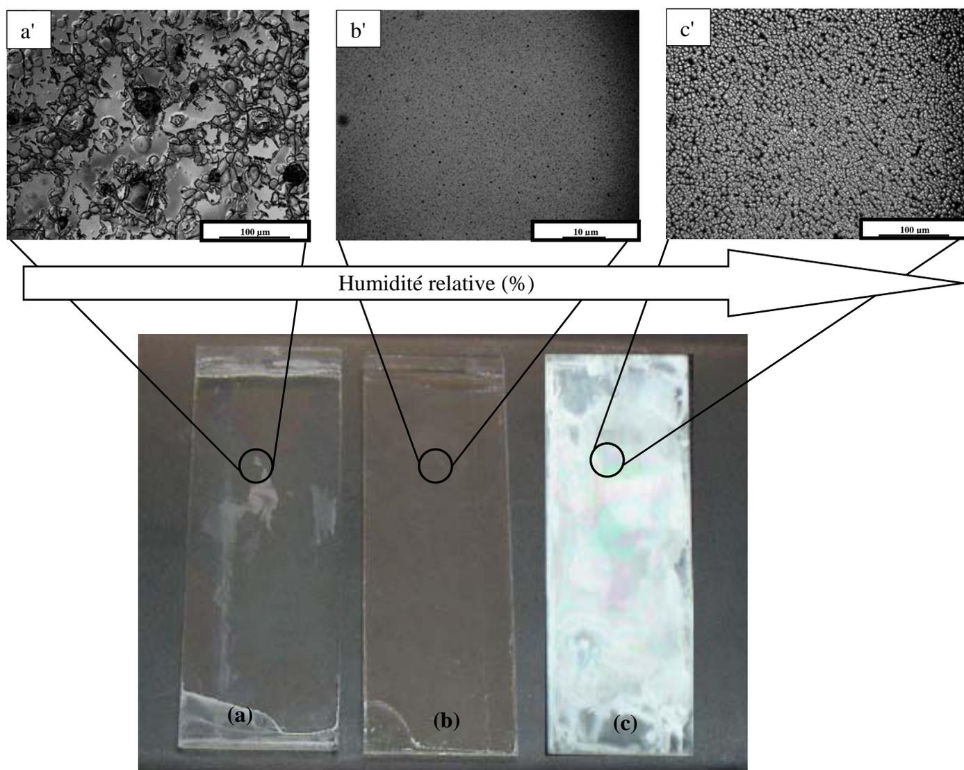
**Figure 29 :** Photos de l'apparence visuel (a, b, c) et de microscopie optique (a', b', c') des films TiO<sub>2</sub>/VSC obtenus par sol-gel à différent taux d'humidité présent dans la chambre, (a, a') < 10% ; (b, b') 35-50% et (c, c') > 70%
