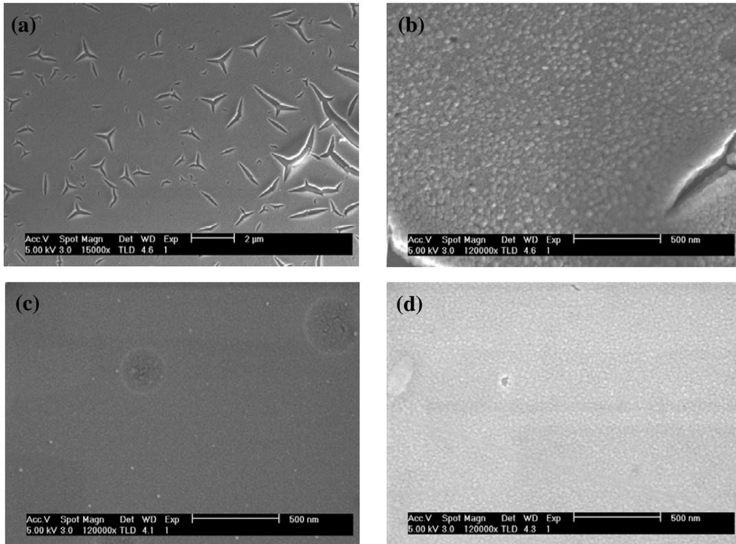
**Figure 31** : Images MEB de films (a, b) TiO<sub>2</sub>/VSC, (c) TiO<sub>2</sub>/VSC et (d) TiO<sub>2</sub>/Quartz recuit à 450°C
