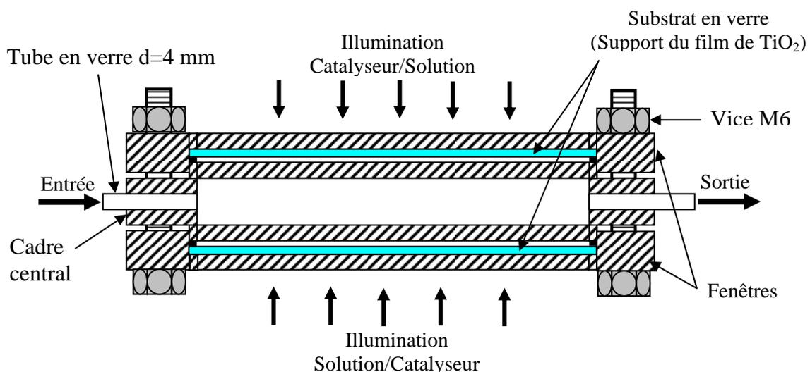
**Figure 36:** Schéma représentant une coupe transversale du photoreacteur
