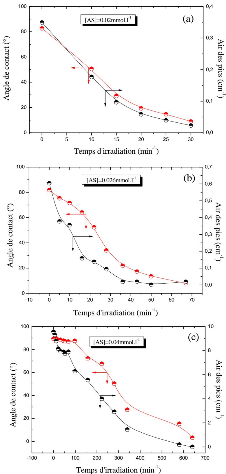
**Figure 60 :** Évolution de l'angle de contact à différent degré de contamination de la surface du système TiO<sub>2</sub>/VBS, (a) [AS]=0.02 mol.l<sup>-1</sup>, (b) [AS]=0.026 mol.l<sup>-1</sup> et (c) [AS]=0.04 mol.l<sup>-1</sup>
