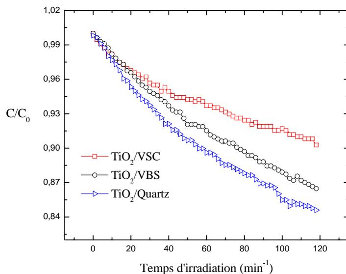
**Figure 51 :** Dégradation de l'OII sous irradiation UV-Visible par une série de films de  $TiO_2$  : ( $\square$ )  $TiO_2/VSC$ , ( $\circ$ )  $TiO_2/VBS$ , ( $\blacktriangleright$ )  $TiO_2/Quartz$
