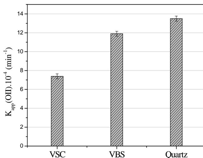
**Figure 54 :** Efficacité photocatalytique des films TiO<sub>2</sub> sur différents supports
