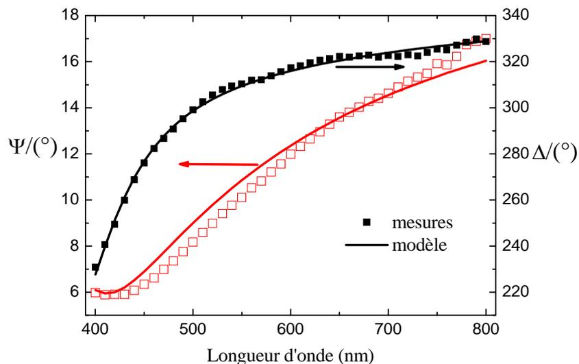
**Figure 34 :** Modélisation des données expérimentales d'ellipsométrie spectroscopique pour un film TiO<sub>2</sub>/Quartz ( $n_{cycles}=36$ )
