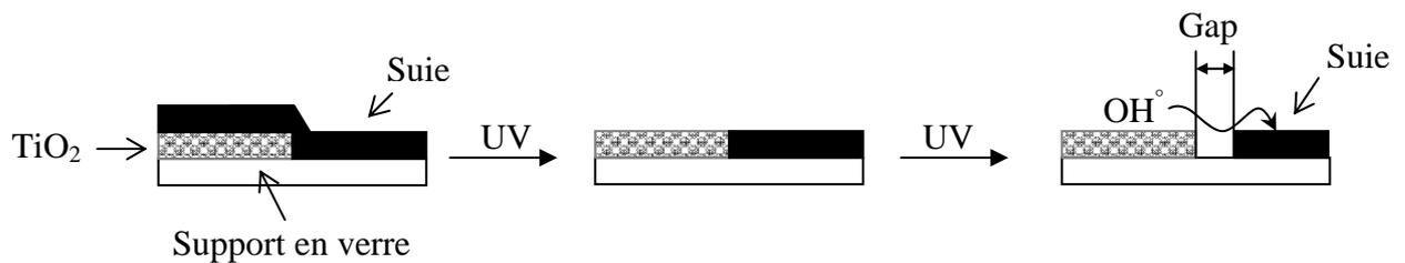
**Figure 13** : Dégradation photocatalytique d'une couche de suie selon M. C. Lee (M. C. LEE, 2002)
