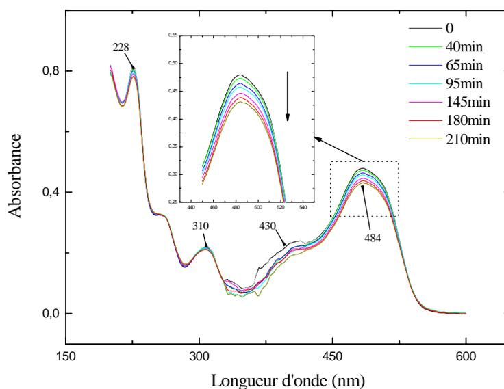
**Figure 44 :** Évolution du spectre d'absorbance de l'OII en présence d'un film de  $\text{TiO}_2/\text{VSC}$  et sous irradiation UV-Visible, pH 9,  $[\text{OII}] = 10 \text{ mg/l}$ ,  $I_{\text{UV}_a} = 25 \text{ W.m}^{-2}$  et  $d = 33 \text{ ml.min}^{-1}$
