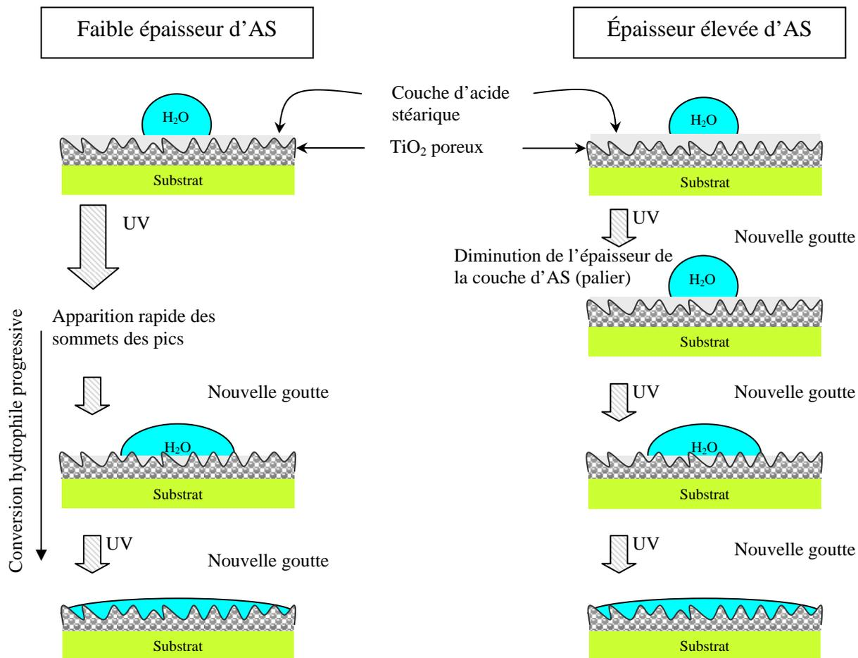
**Figure 61 :** Proposition de mécanisme de conversion hydrophile des films sol-gel de TiO<sub>2</sub> contaminés par différentes épaisseurs de l'AS
