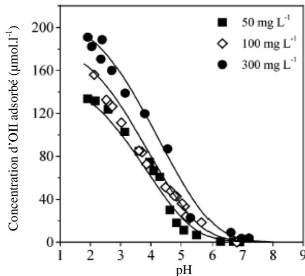
**Figure 41 :** Adsorption de l'OII à la surface de  $\text{TiO}_2$  en fonction du pH à température ambiante pour trois concentrations initiales en Orange II ( $50 \text{ mg.l}^{-1}$ ,  $100 \text{ mg.l}^{-1}$  et  $300 \text{ mg.l}^{-1}$ ;  $\text{TiO}_2=750 \text{ mg.l}^{-1}$ ) (BOU., 2005)
