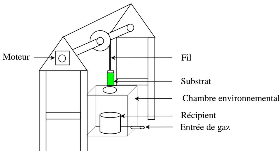
**Figure 23 :** Dispositif expérimental de « Dip-coating » fabriqué au laboratoire
