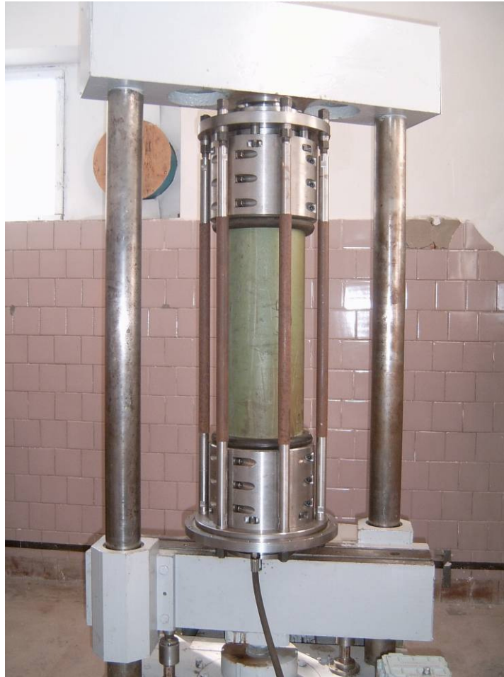
Figure II-33 : Montage utilisé pour l'éclatement sous pression des tuyaux.
