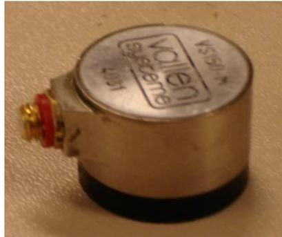
Figure II-20 : Capteurs VS 150-M.
