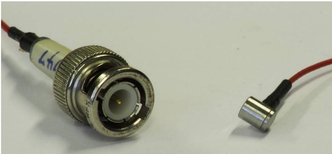
Figure II-21 : Capteurs Pico Z.
