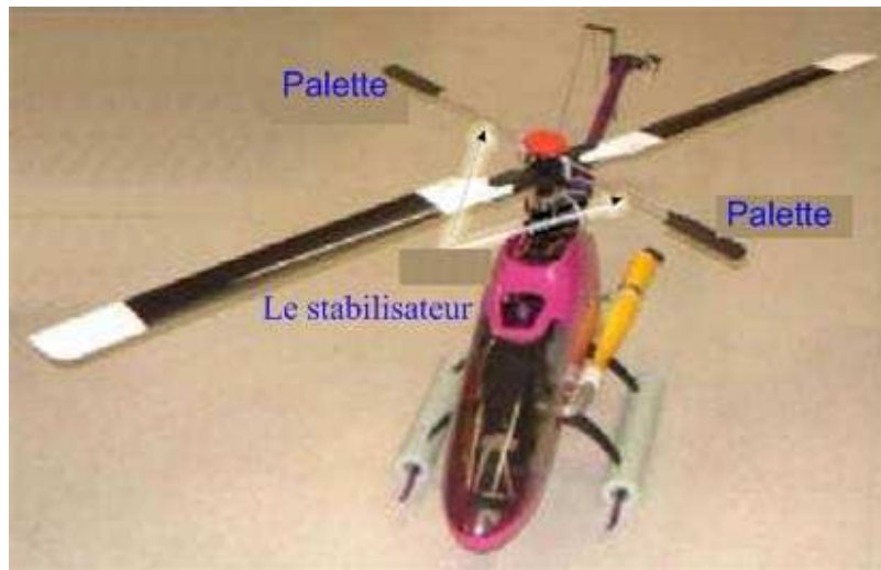
FIGURE 2.20: Le stabilisateur à inertie
