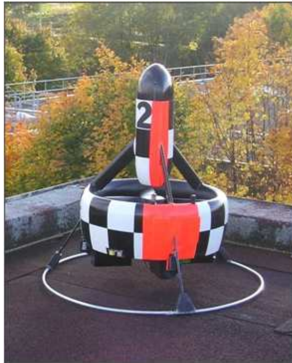
FIGURE 2.28: Minidrone VTOL à hélice carénée
