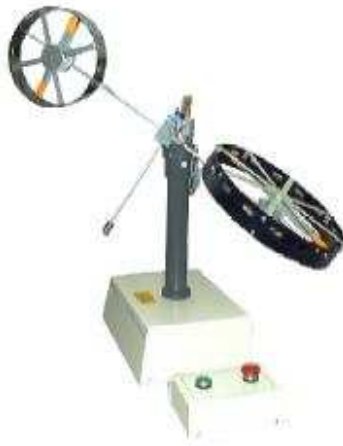
FIGURE 1.10: Hélicoptère de laboratoire à deux rotors
