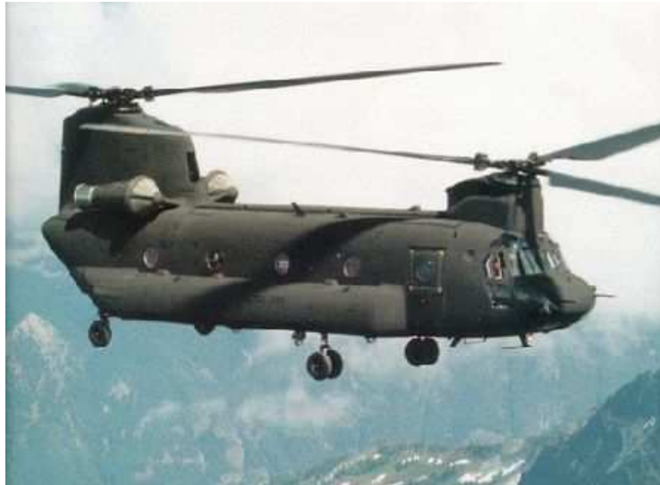
FIGURE 2.7: Hélicoptère bi-rotor en tandem
