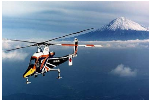
FIGURE 2.9: Hélicoptère bi-rotor côte à côte
