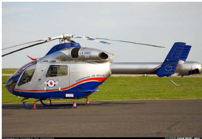
FIGURE 2.6: Hélicoptère de type NOTAR
