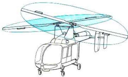
FIGURE 2.9: Hélicoptère bi-rotor côte à côte
