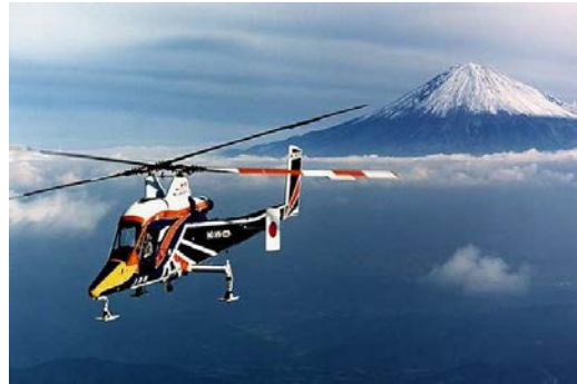
FIGURE 2.9: Hélicoptère bi-rotor côte à côte
