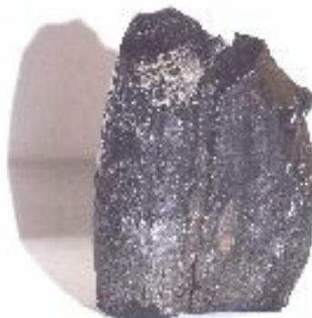
**Figure I.3 :** Schéma d'un dépôt solide d'asphaltène
