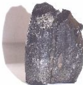
Figure I.3 : Schéma d'un dépôt solide d'asphaltène
