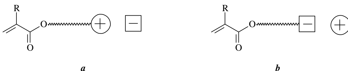
Schéma II.3 : Représentations simplifiées d'un monomère (méth)acrylique cationique (a) et d'un monomère (méth)acrylique anionique (b).
